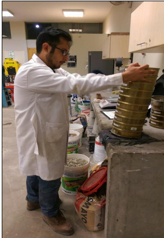
Figura 23: Ensayo granulométrico de los agregados.
