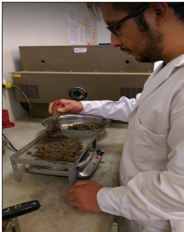
Figura 22: Secado de la muestra de agregado fino.
