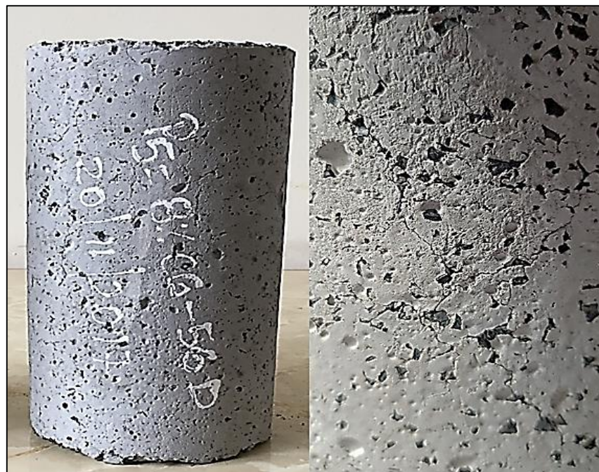
Figura 17: Probeta a 56 días y 9% de adición de grano de caucho.
