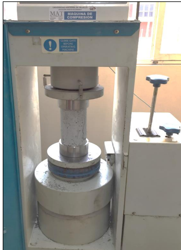
Figura 25: Resistencia a la compresión de probetas.
