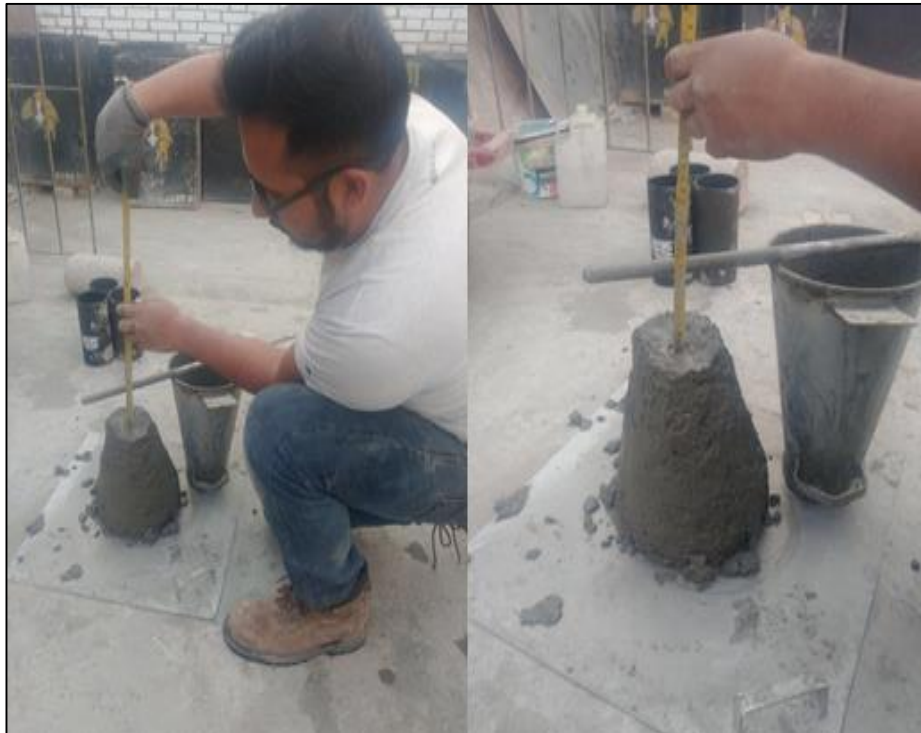
Figura 24: Ensayo de asentamiento de la mezcla patrón.
