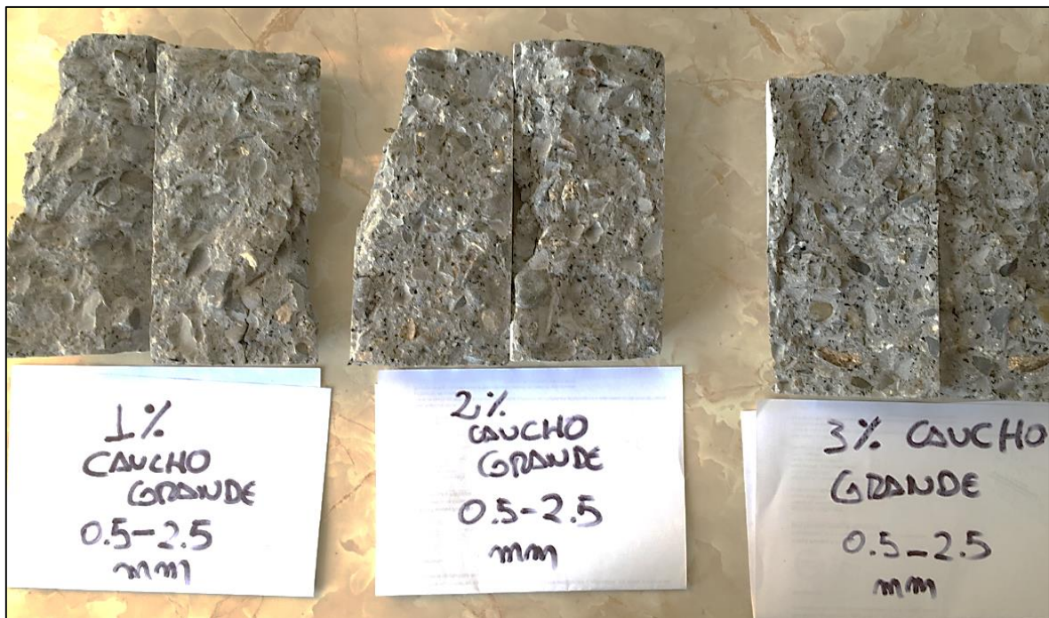
Figura 27: Distribución del caucho granulado al 1%, 2% y 3%.
