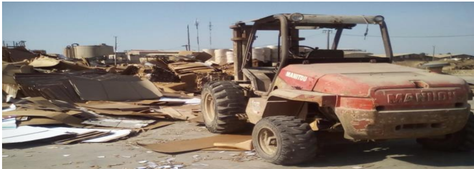
Foto N° 03 Se observa montacarga antiguo e inoperativo que dificulta las labores de descarga del cartón. [Fotografía de Luis Jacobo].(Almacén de empresa papelera. 2018)
