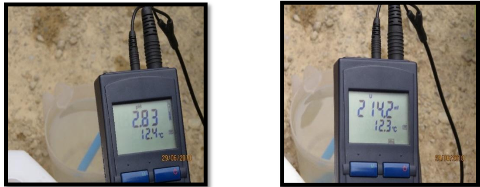
Figura n.º 3. 2. Verificación del pH y la conductividad del dasaut.
