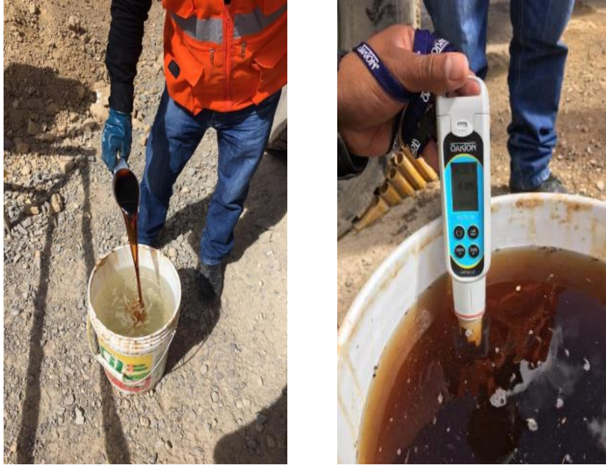
Figura n.º 3. 13. Verificación del pH de la disolución.
