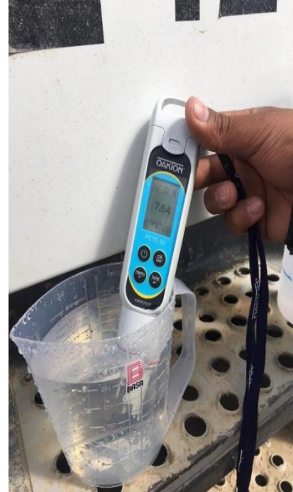
Figura n.º 3. 11. Verificación del pH de agua.
