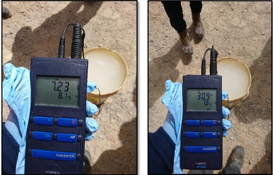
Figura n.º 3. 6. Verificación del pH y conductividad del producto dl10 plus
