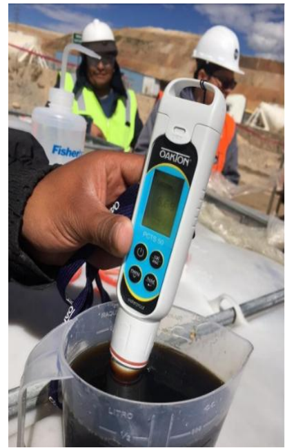
Figura n.º 3. 12. Verificación del pH del knockout dustply.
