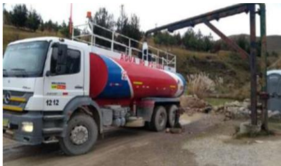
Figura n.º 3. 3. Llenado de cisterna con agua y Dasaut.
