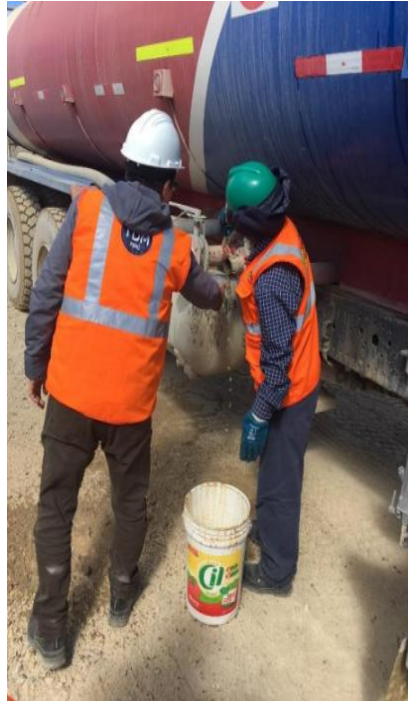
Figura n.º 3. 11. Verificación del pH de agua.
