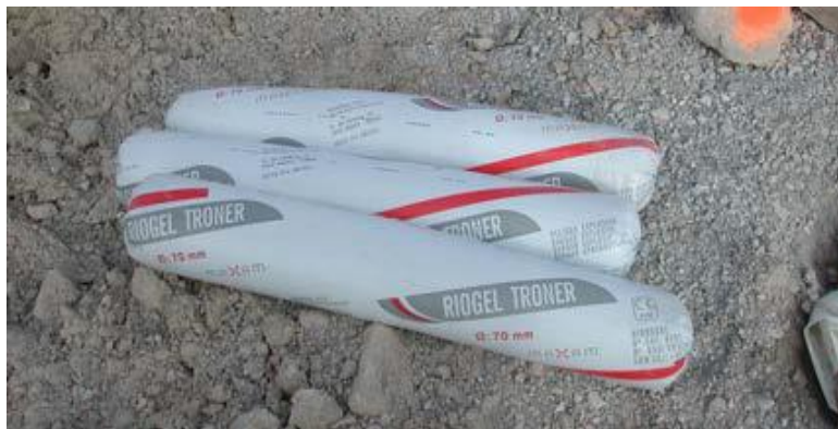
Figura 10: Explosivos tipo Hidrogel
