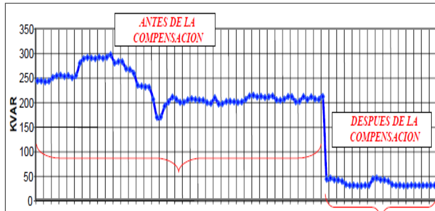
Figura 4.- Registro del consumo de energía a reactiva antes y después de la implementación de un sistema automático de corrección de potencia
