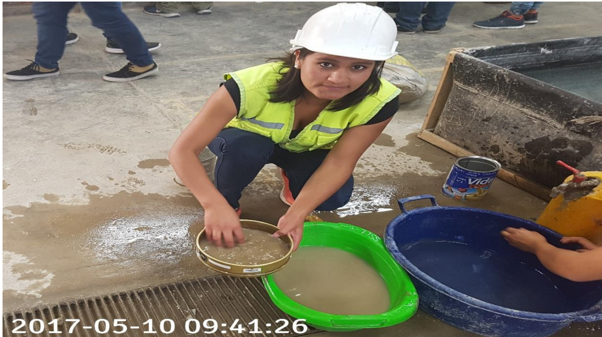
Se puede apreciar a la tesista realizando el análisis granulométrico mediante lavado de la Malla N ° 20
