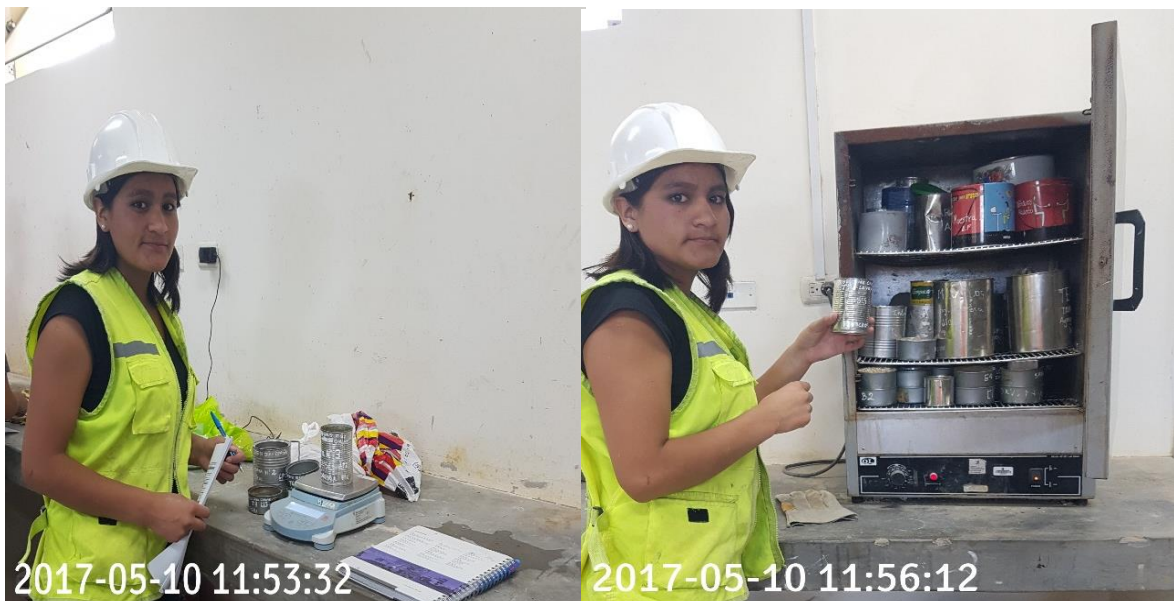
Se observa que la tesista está pesando el material retenido en la malla N°200 y a continuación colocándolo al horno.
