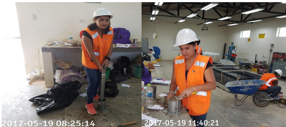
Imagen n° 11: Compactación proctor modificado.
