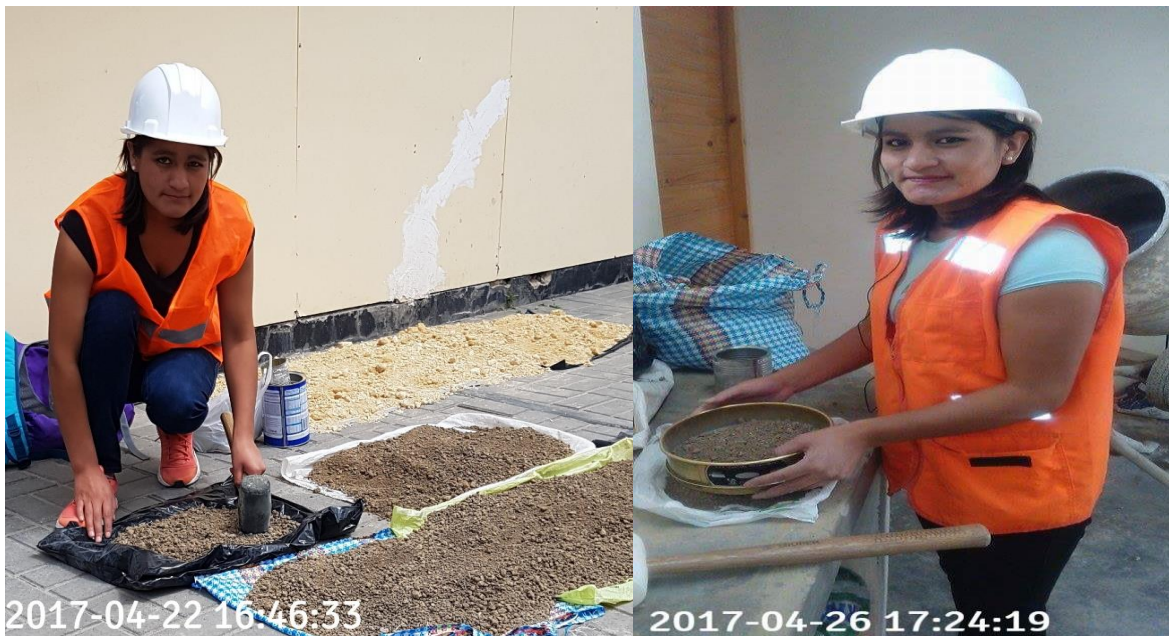
Chancado y tamizado del material para los ensayos de límite de Atterberg (malla n° 40) y peso específico (malla n°4).
