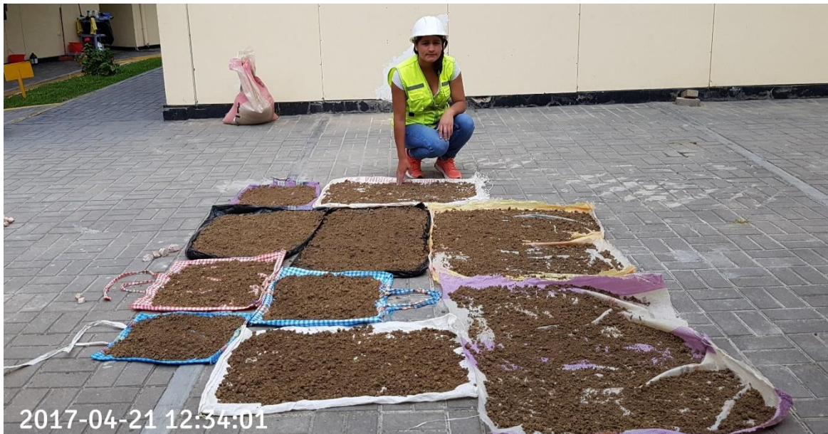
Secado del material arcilloso para realizar los ensayos asignados en la presente tesis.
