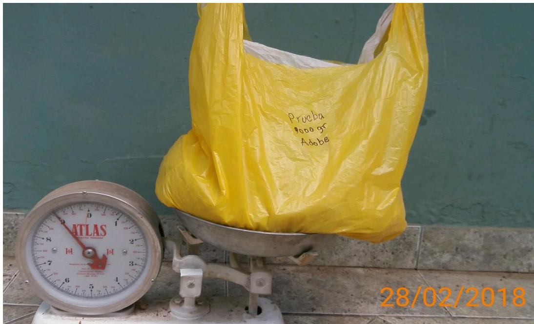
Figura 15: Peso de tierra para elaboración de adobe de cálculo de material
