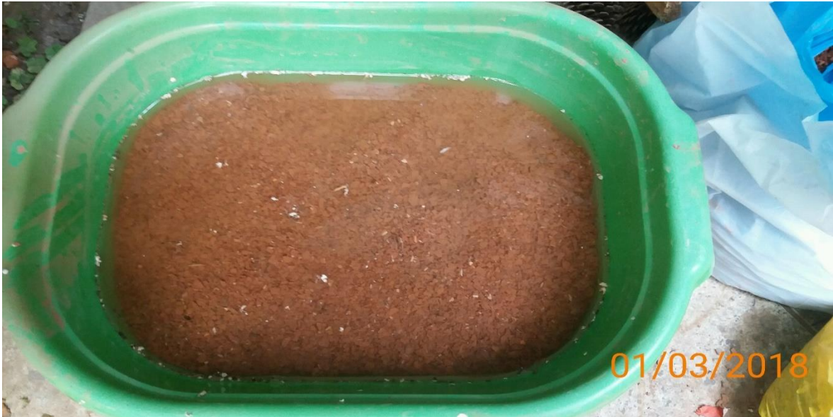
Figura 61: Desperdicio de cerámica triturada puesta en agua 1 día para utilizarla en la fabricación de adobes compactados
