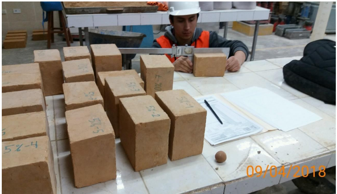
Figura 68: Medición de adobes antes de ensayo a compresión y flexión
