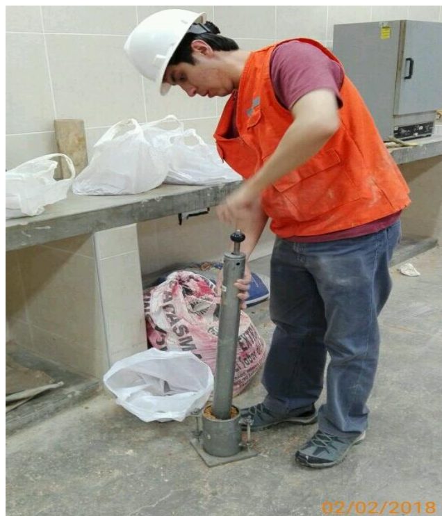
Figura 10: Realizando ensayo de proctor modificado
