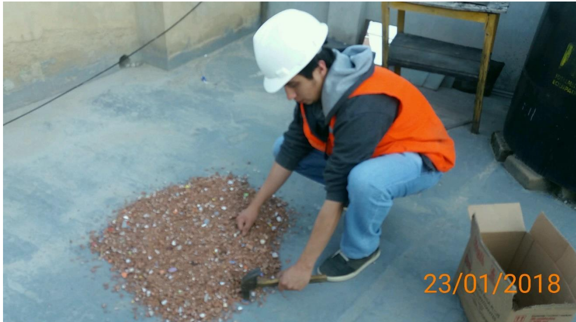
Figura 33: Proceso de trituración de la cerámica reciclada
