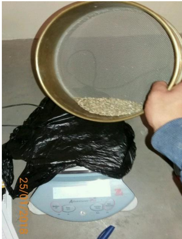
Figura 38: Peso de material retenido en la malla del ensayo de análisis granulométrico
