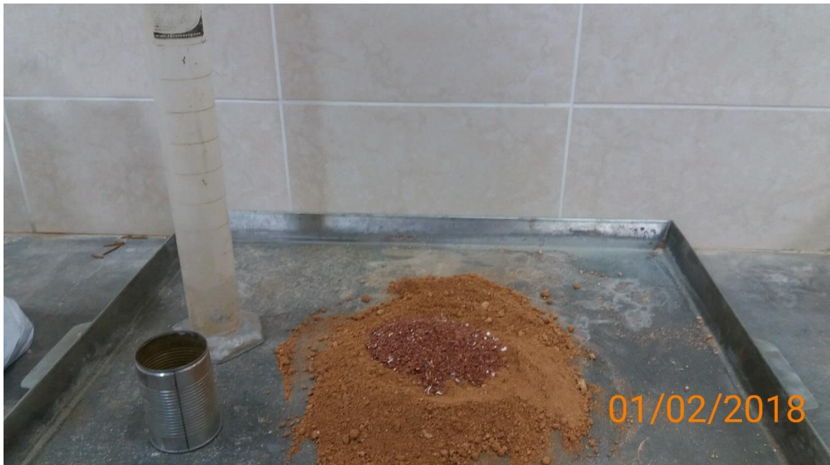
Figura 50: Proceso de mezclado de material para ensayo proctor modificado
