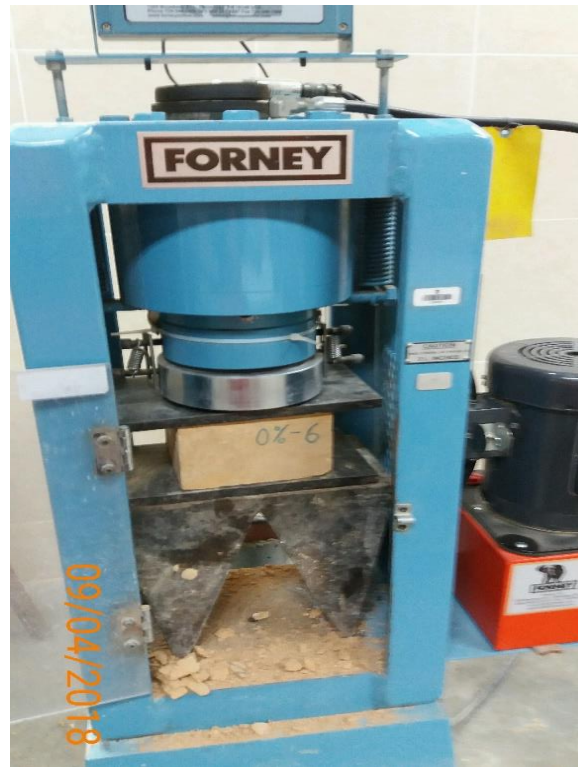
Figura 69: Adobe en máquina de ensayo resistencia a compresión
