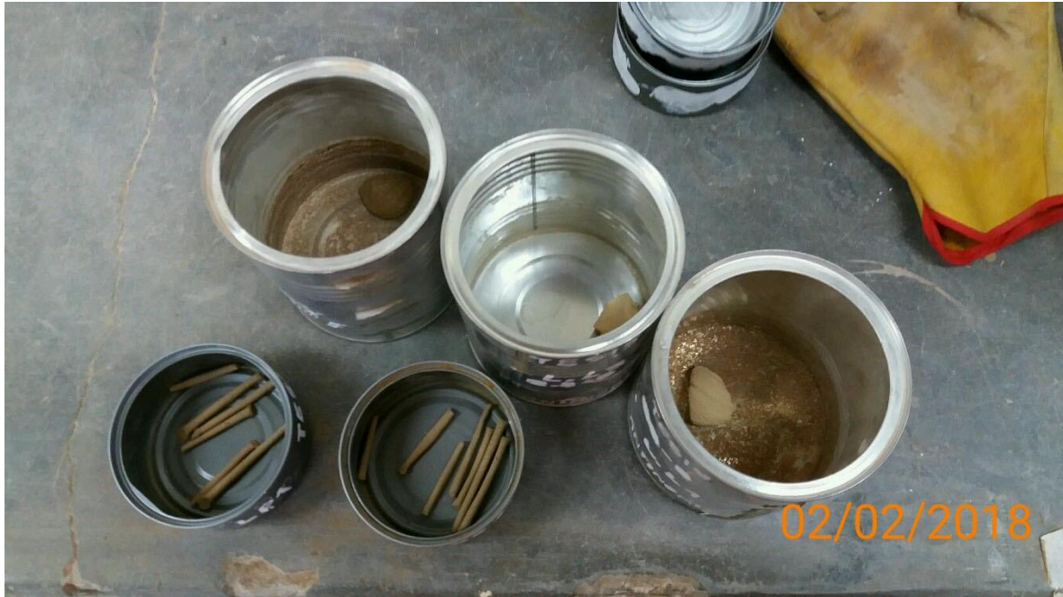
Figura 49: Muestras del ensayo de Límites de Atterberg después de sacarlas del horno
