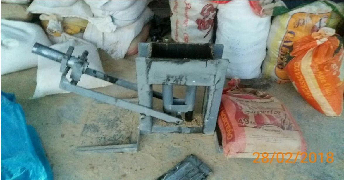
Figura 57: Máquina Cinva Ram utilizada para la fabricación de adobes compactados
