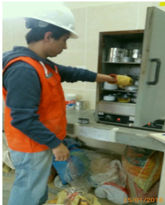
Figura 9: Colocación de muestras en el horno
