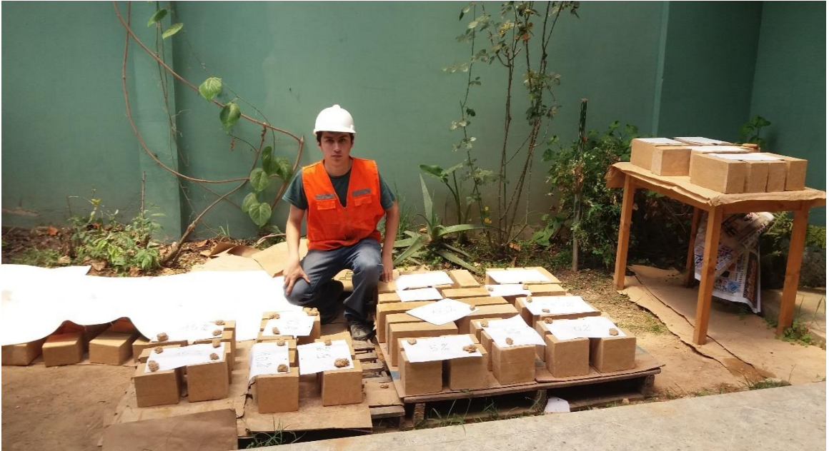
Figura 65: Adobes compactados fabricados para la investigación
