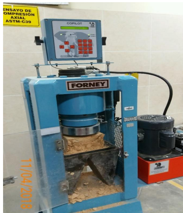
Figura 70: Adobe después de ensayo de resistencia a compresión
