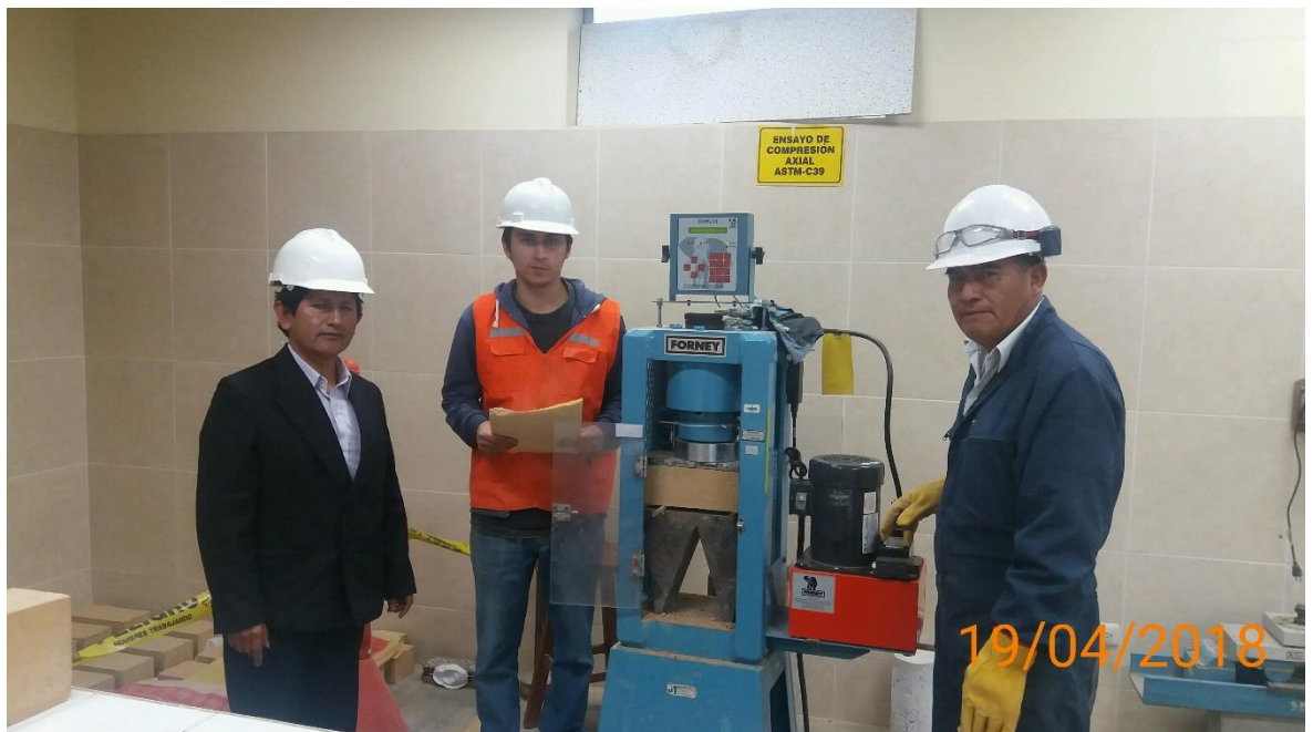
Figura 74: Ensayos de resistencia a compresión y flexión de adobes en presencia de asesor de tesis
