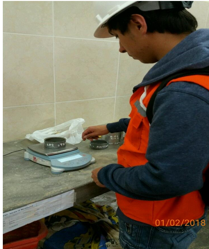
Figura 47: Peso de muestras del ensayo de Límites de Atterberg
