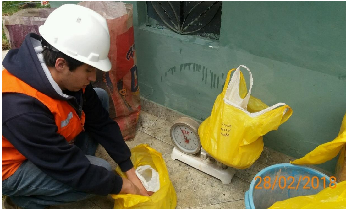
Figura 14: Muestra de cálculo de material por adobe
