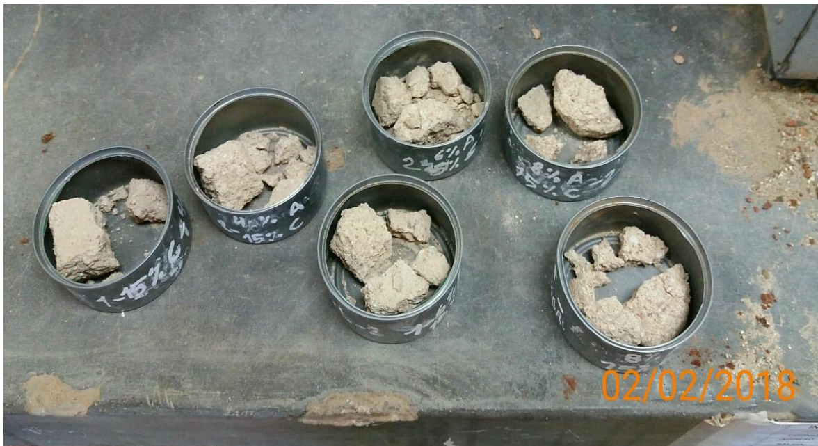
Figura 56: Muestras de ensayo proctor sacadas del horno
