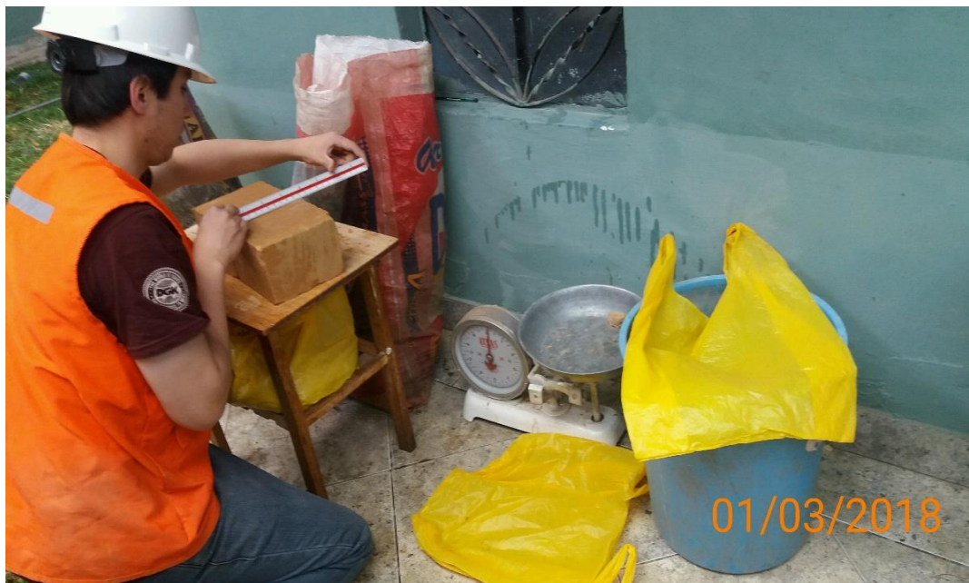
Figura 19: Medición de ancho de adobes de muestra para cálculo de cantidad de material
