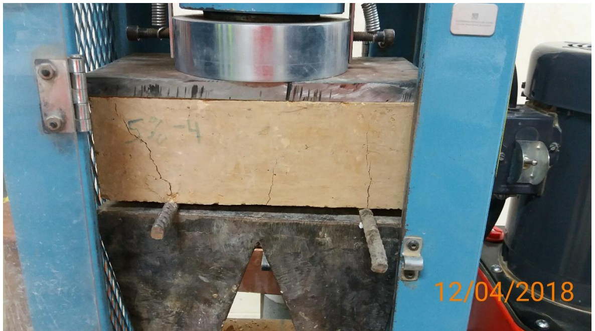
Figura 72: Adobe después de ensayo de resistencia a flexión
