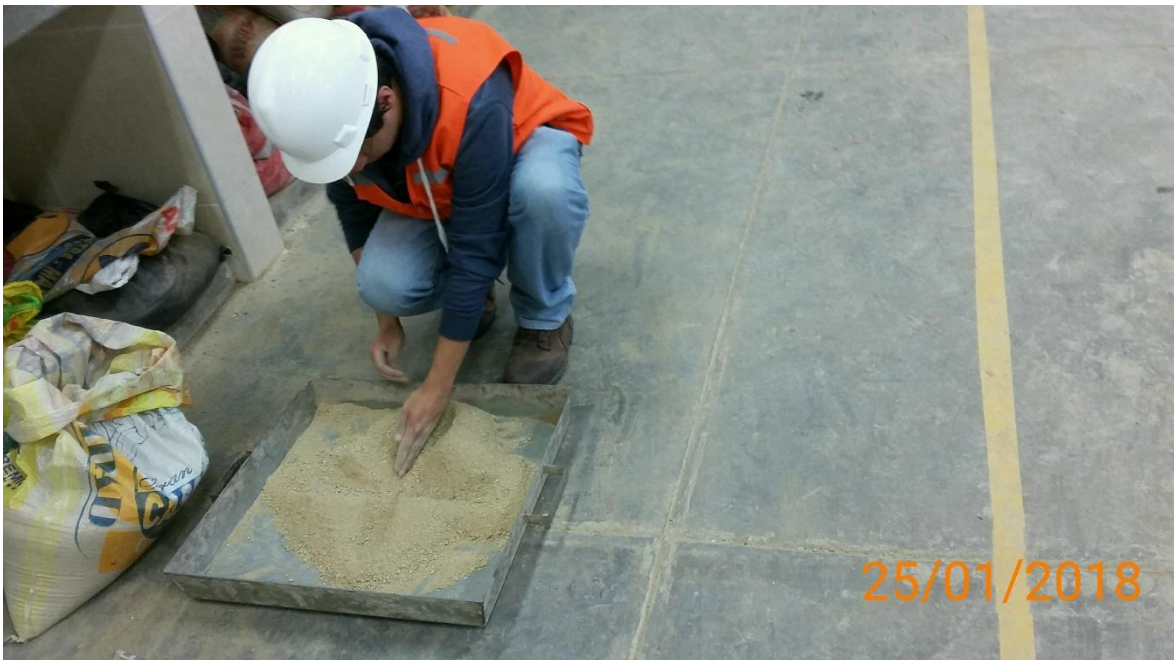
Figura 36: Preparación de la tierra para ensayo de contenido de humedad.
