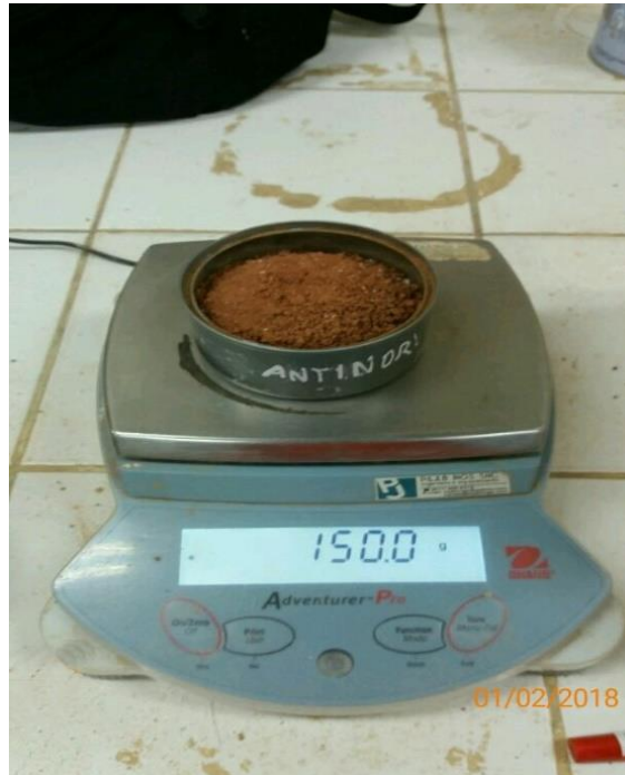
Figura 54: Peso de cerámica triturada para ensayo proctor modificado
