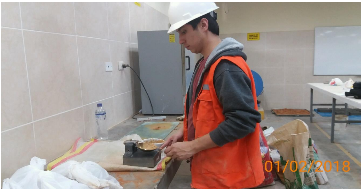
Figura 42: Realizando ensayo de límite líquido del material
