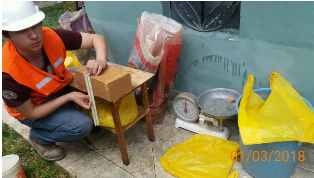
Figura 20: Medición de altura de adobe de muestra para cálculo de cantidad de material
