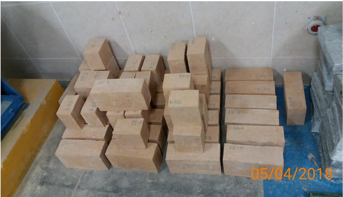
Figura 66: Adobes compactados a ensayar en el laboratorio de suelos UPN
