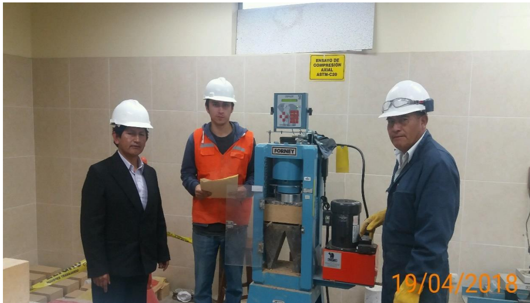
Figura 24: Realizando ensayo de resistencia a flexión axial de los adobes compactados
