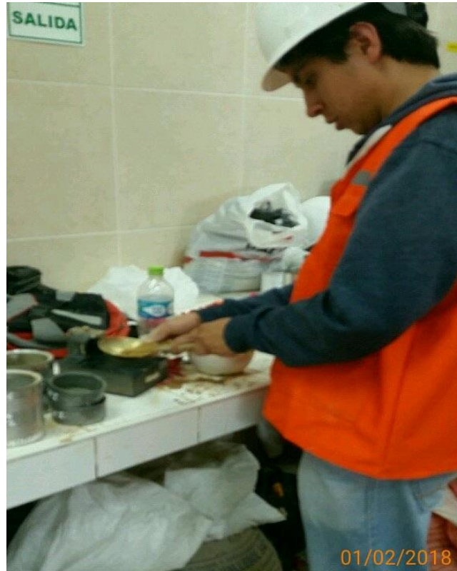
Figura 43: Realizando ensayo de límite líquido del material
