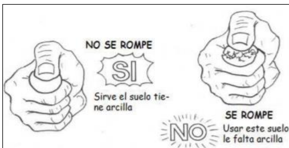
Figura 1: Prueba de campo para suelo
