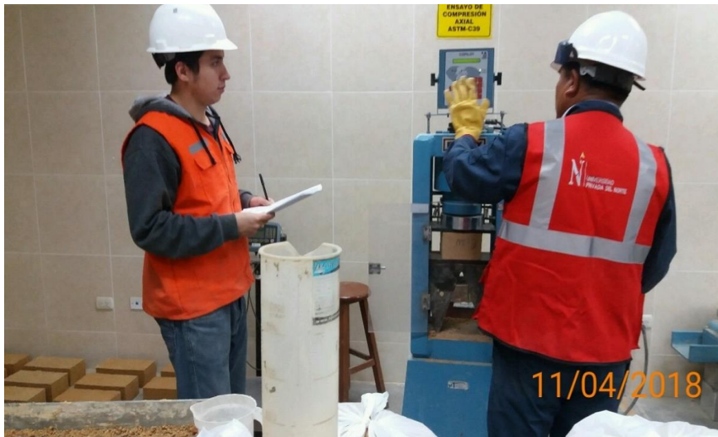
Figura 23: Realizando ensayo de resistencia a compresión axial de los adobes compactados
