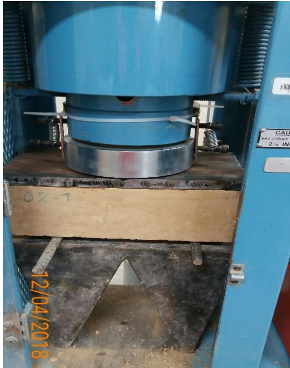
Figura 71: Adobe en máquina de ensayo resistencia a flexión
