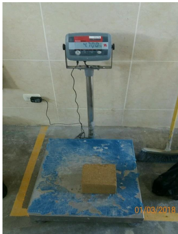
Figura 62: Peso de muestra de adobe fabricado para ensayo de contenido de humedad
