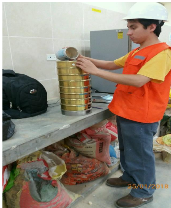
Figura 8: Proceso de tamizado de material lavado
