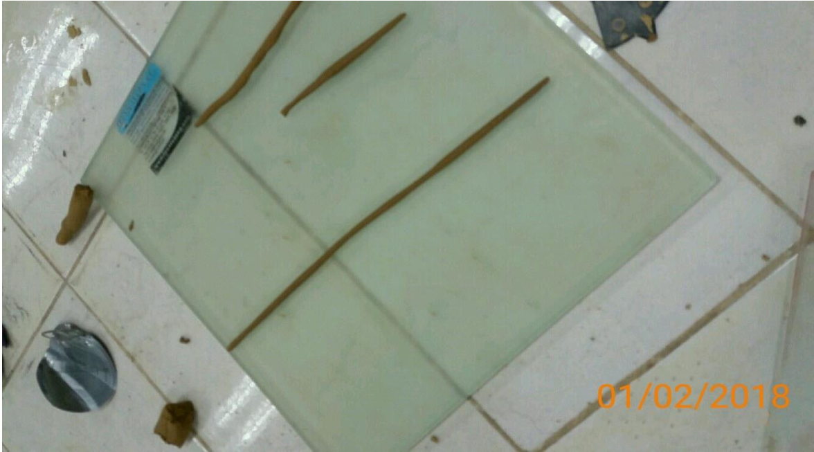
Figura 45: Realizando ensayo de límite plástico del material
