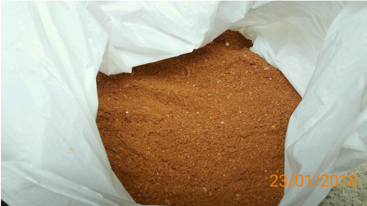
Figura 35: Cerámica triturada a utilizar en la fabricación de los adobes, pasada por la malla N° 4
