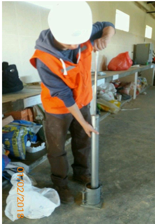
Figura 51: Realizando proceso de compactación en el ensayo de proctor modificado para el adobe patrón
