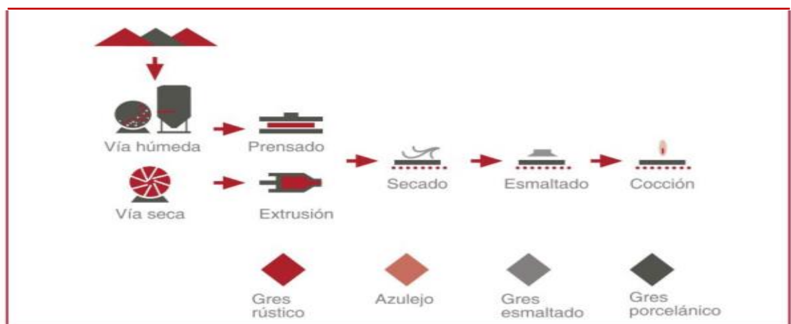
Figura 2: Proceso de fabricación de baldosas cerámicas
