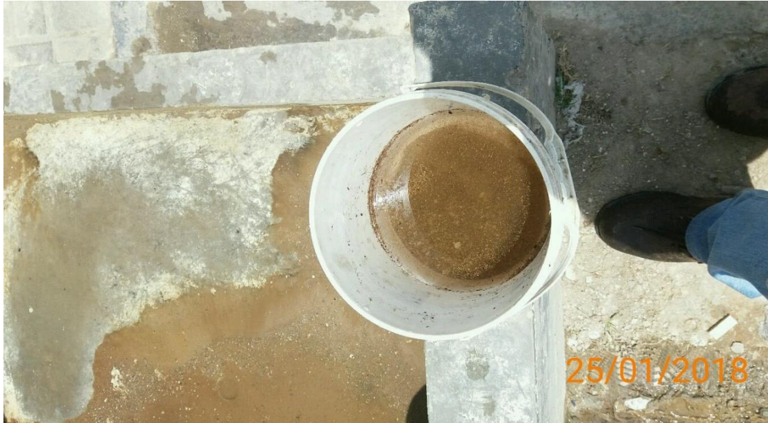
Figura 37: Proceso de lavado de material para ensayo de análisis granulométrico
