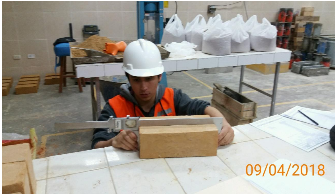
Figura 67: Medición de adobes antes de ensayo a compresión y flexión
