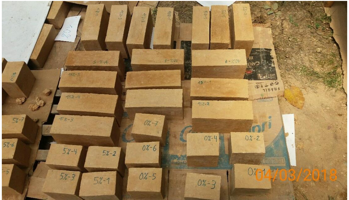
Figura 63: Adobes compactados durante proceso de secado
