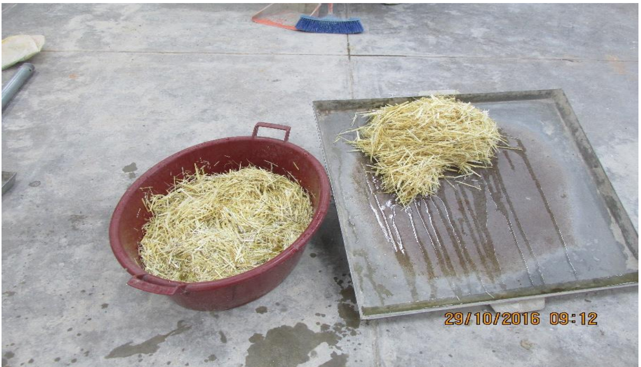
Fotografía N° 32: Saturación de las fibras de trigo para la elaboración de proctor con los diferentes porcentajes.
