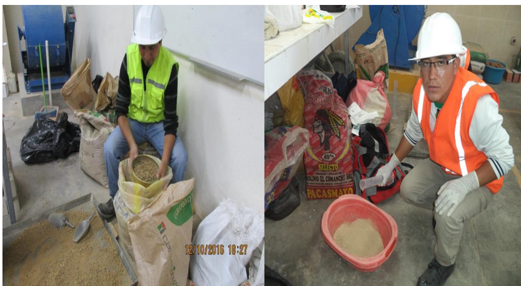
Fotografía N° 22: Realizando el tamizado del suelo.
