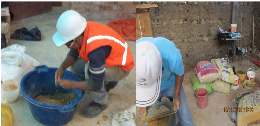
Fotografía N° 25: Preparando el material y colocando en la maquina CIVA RAM.
