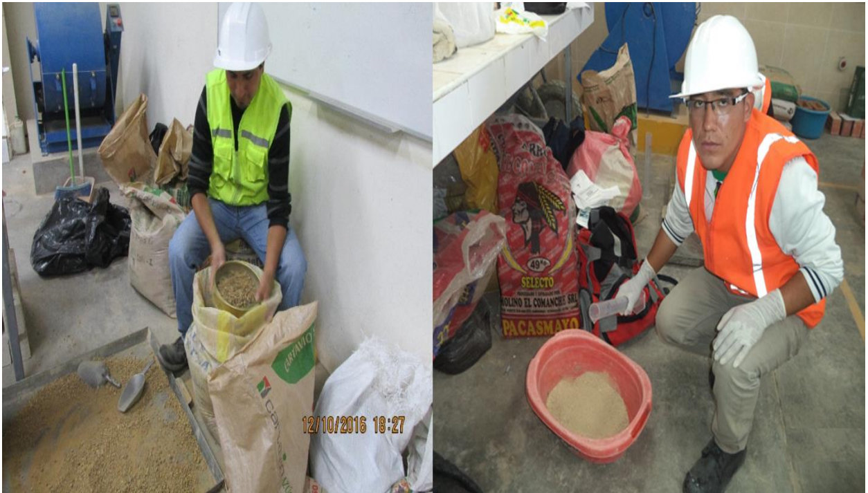
Fotografía N° 32: Saturación de las fibras de trigo para la elaboración de proctor con los diferentes porcentajes.
