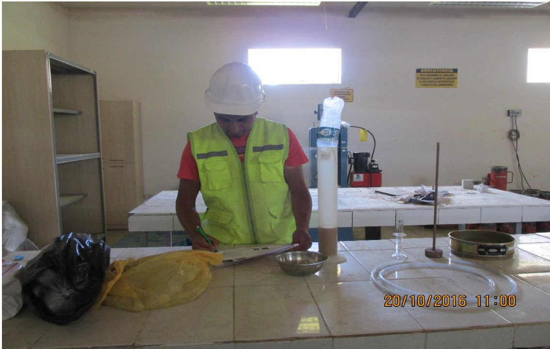
Fotografía N° 19: Realizando el ensayo de sedimentación o sifonaje.
