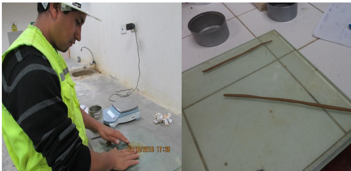
Fotografía N° 21: Realizando el ensayo de límite plástico del suelo.
