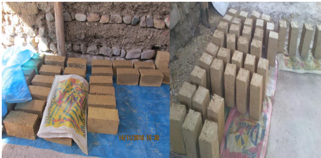
Fotografía N° 27: Secando de los adobes fabricados con los diferentes porcentajes de fibras vegetales.
