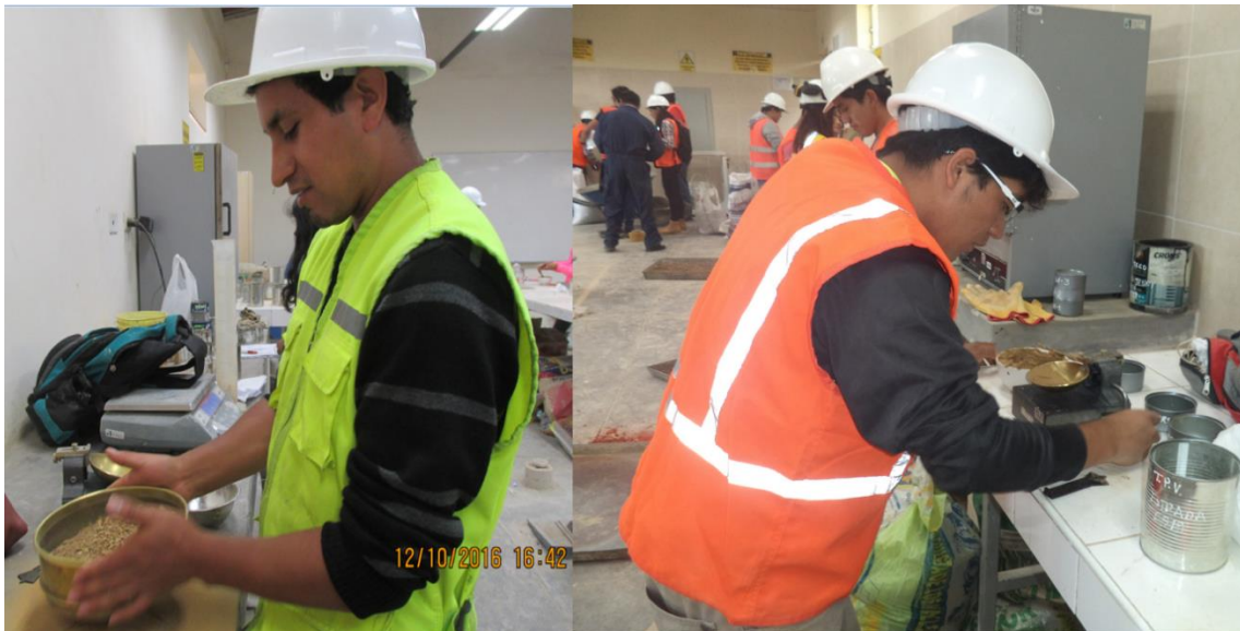
Fotografía N° 20: Realizando el ensayo de límite líquido del suelo.
