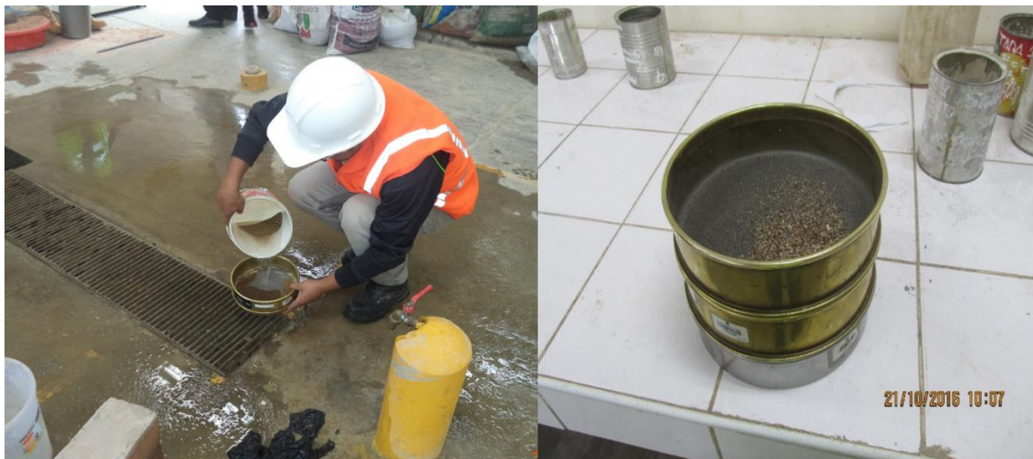
Fotografía N° 18: Pesando los porcentajes retenidos en cada tamiz.
