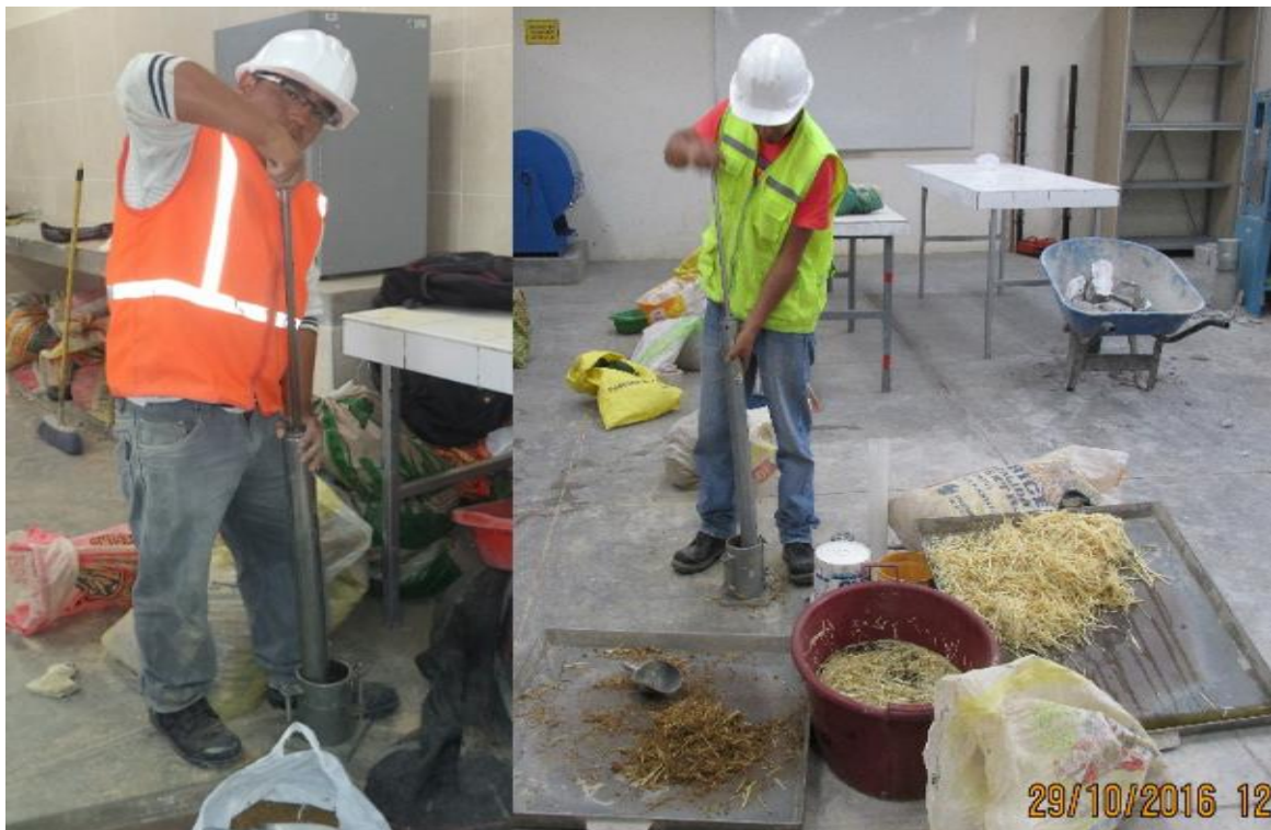
Fotografía N° 34: Elaboración de los ensayos de proctor con los diferentes porcentajes.
