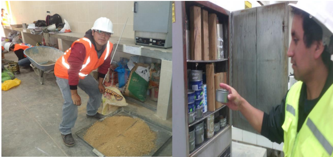
Fotografía N° 17: Extracción del contenido de humedad de suelo.
