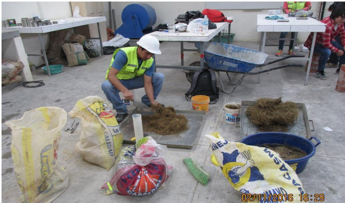
Fotografía N° 36: Elaboración de los ensayos de proctor con fibra ichu.
