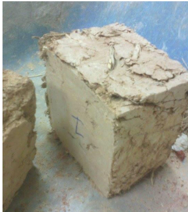
Fotografía N° 40: Ruptura del bloque de adobe ensayado.
