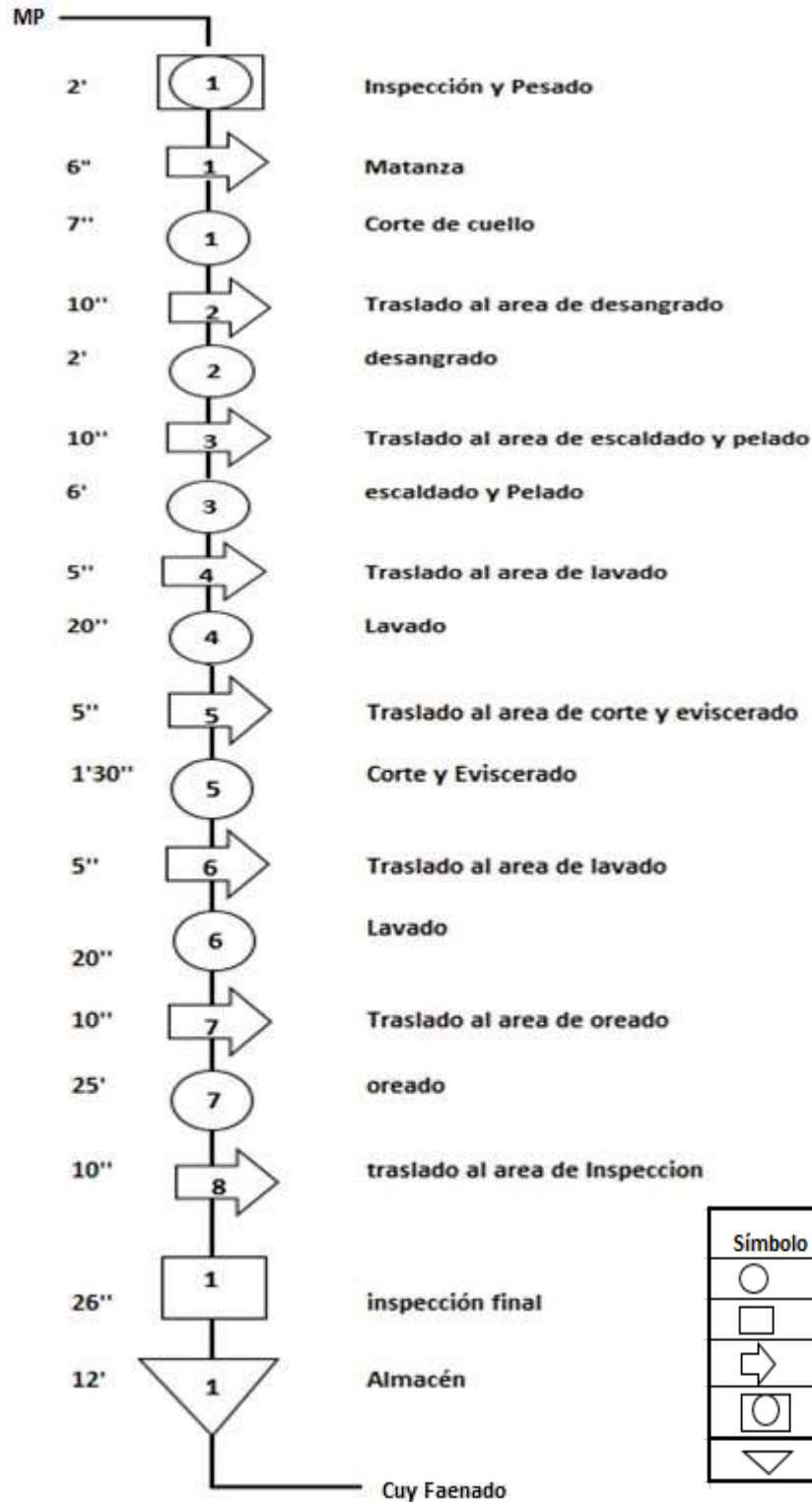
FIGURA Nº 7: DIAGRAMA DE OPERACIONES DEL PROCESO DEL FAENADO DEL CUY ACTUAL
