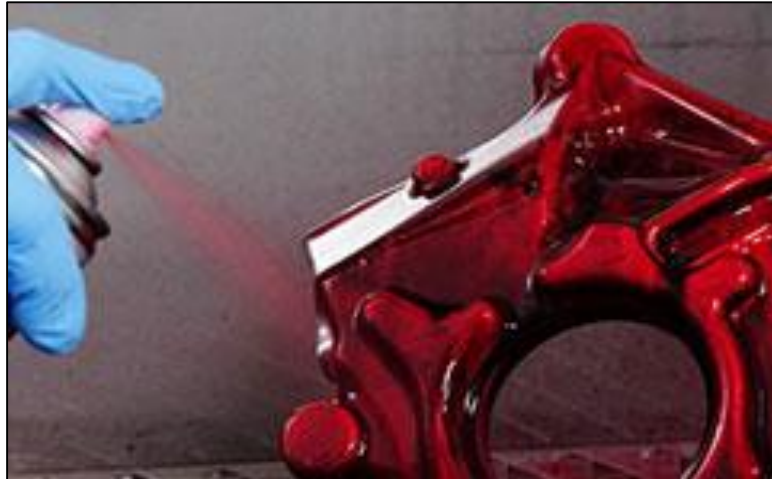
Figura n° 12: Ensayo por Líquidos Penetrantes.
