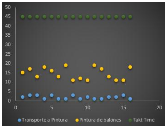
Figura nº 15: Estandarización de Tiempos en el Área de Pintura
