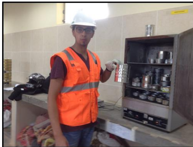
Figura 6. Colocación de la muestra en el horno para la determinación del contenido de humedad.
