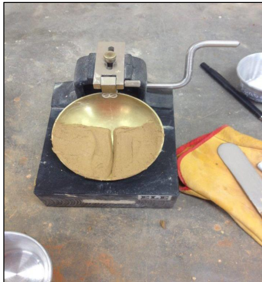
Figura 9. Determinación del límite mediante el uso de la Copa de Casagrande
