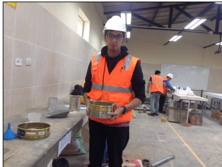
Figura 8. Realización del análisis granulométrico mediante el uso del juego de mallas para suelo fino.
