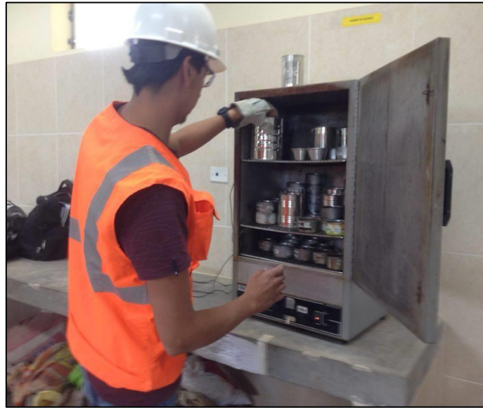
Figura 7. Colocación del material lavado en el horno.
