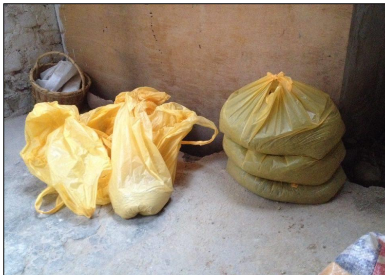
Figura 14. Almacenamiento del material en el contenido óptimo de agua
