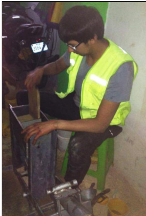
Figura 17. Elaboración de las muestras con 8% de ceniza de biomasa arbórea.
