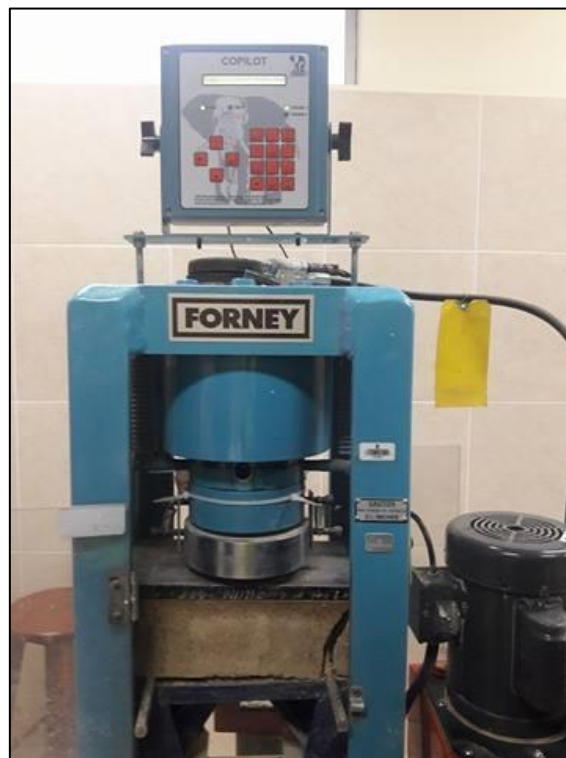
Fotografía N° 10. Ensayo a flexión con 8% de ceniza de biomasa arbórea
