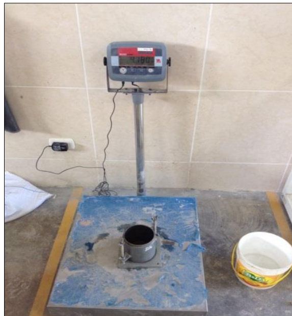
Figura 10. Determinación del peso del molde del Proctor
