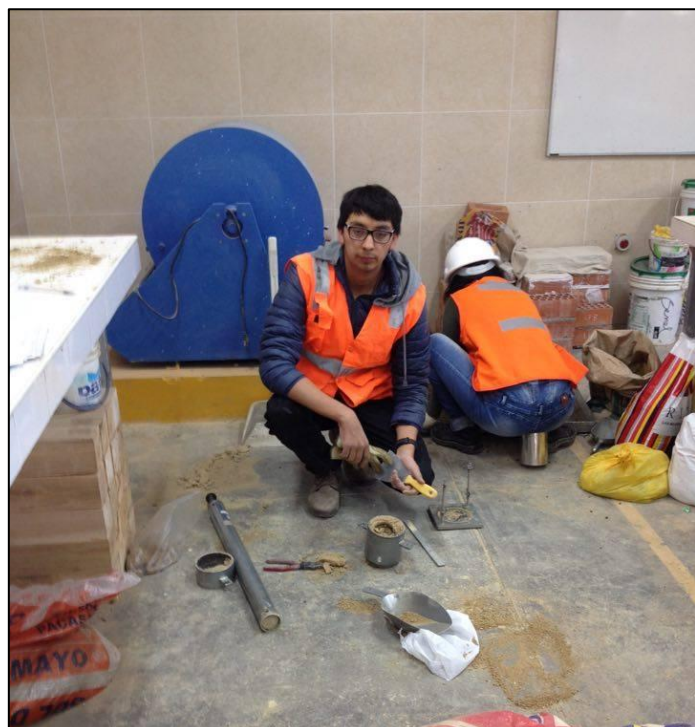
Fotografía N° 4. Ensayo proctor modificado adicionando 8% y 10% de ceniza de biomasa arbórea
