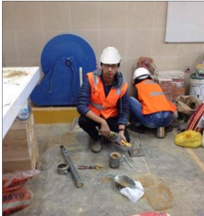
Figura 11. Ensayo Proctor modificado con adición de 8% y 10% de ceniza de biomasa arbórea.
