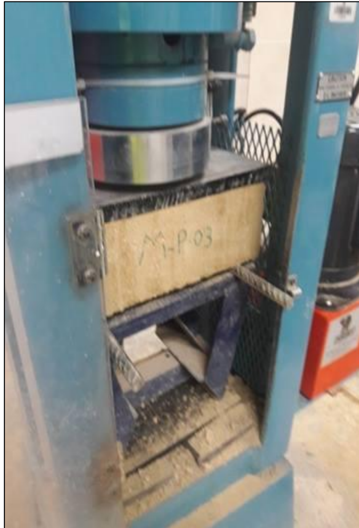
Fotografía N° 13. Ensayo a flexión de la muestra patrón N° 3
