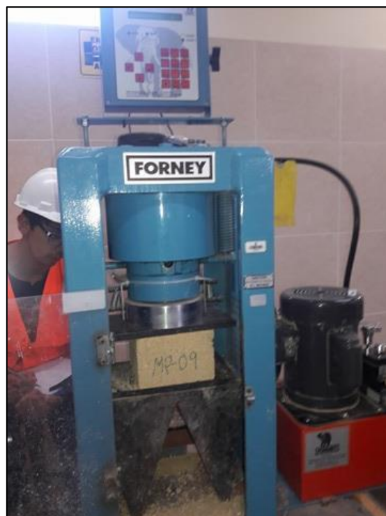
Fotografía N° 12. Ensayo a compresión de la muestra patrón
