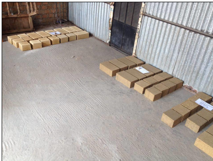
Figura 19. Área de secado de las unidades de adobe compactado.
