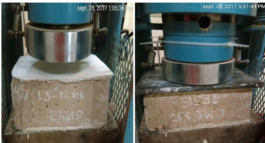
Figura 52. Resistencia a compresión de unidades de albañilería
