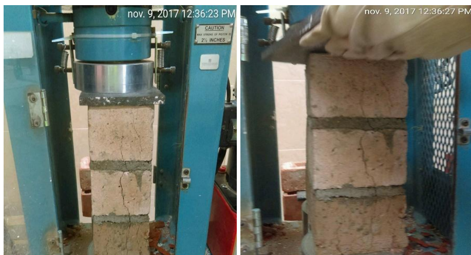
Figura 65. Fallas de pilas de unidades de concreto
