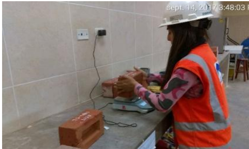
Figura 29. Peso del espécimen saturado
