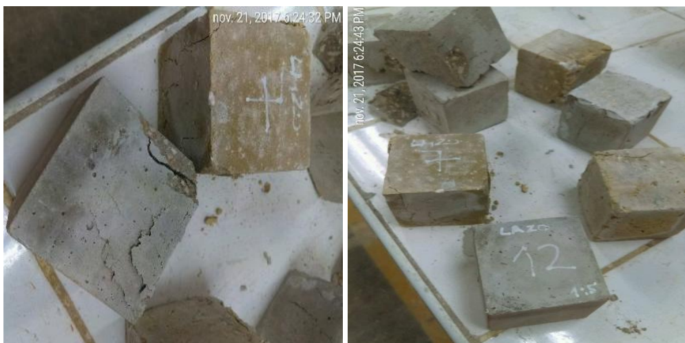
Figura 75. Fallas de todos los cubos de mortero
