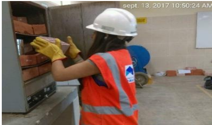
Figura 30. Secado al horno de unidades de albañilería
