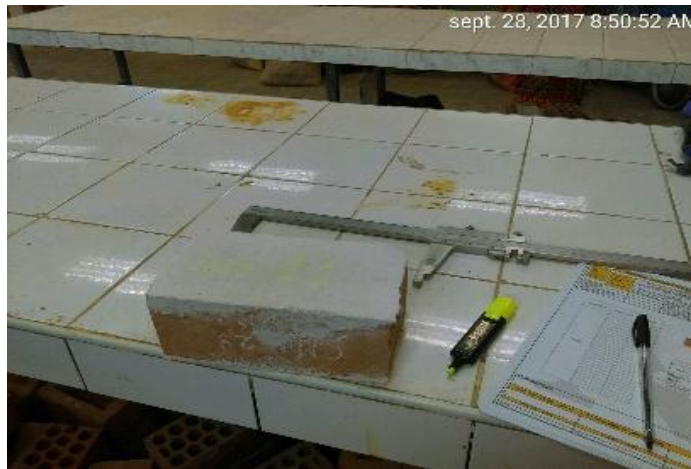
Figura 27. Medidas de unidades de albañilería
