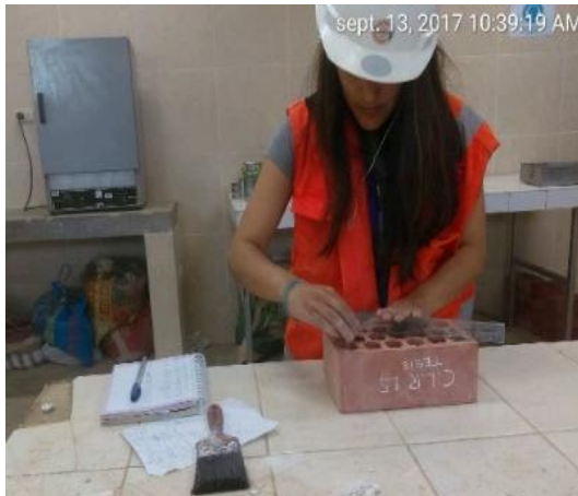
Figura 25. Ensayo de alabeo
