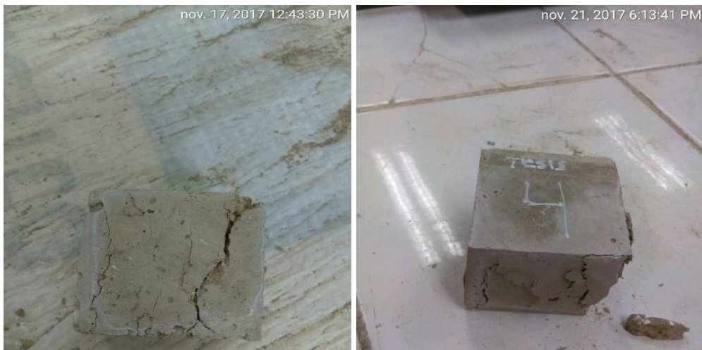
Figura 74. Fallas presentadas en cubos de mortero sin cal
