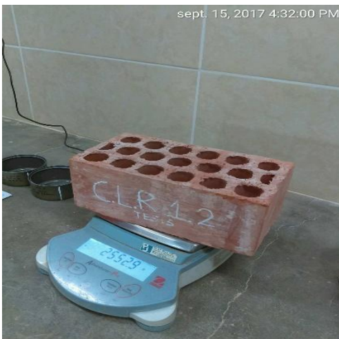
Figura 48. Ensayo de succión
