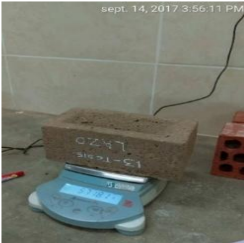
Figura 47. Resultados de ensayo de absorción
