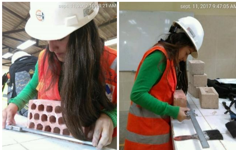
Figura 23. Ensayo de variación dimensional
