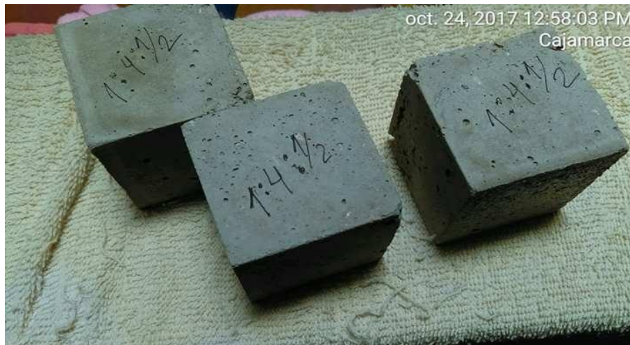
Figura 62. Cubos de morteros sacados del molde
