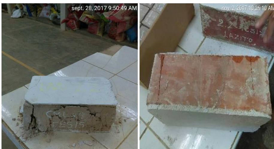
Figura 53. Fallas de unidades de albañilería
