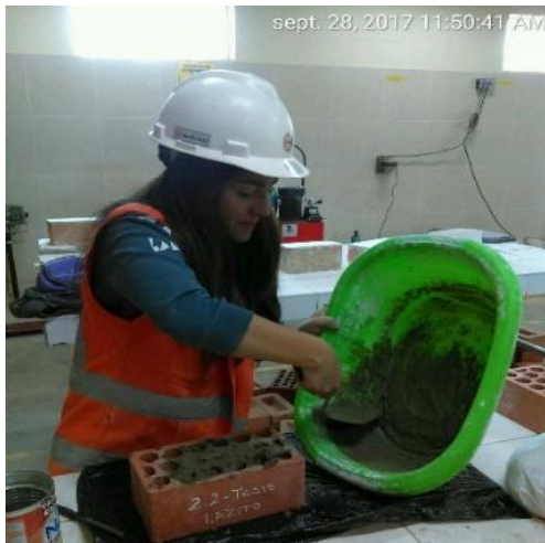
Figura 50. Elaboración de refrentado a unidades de albañilería
