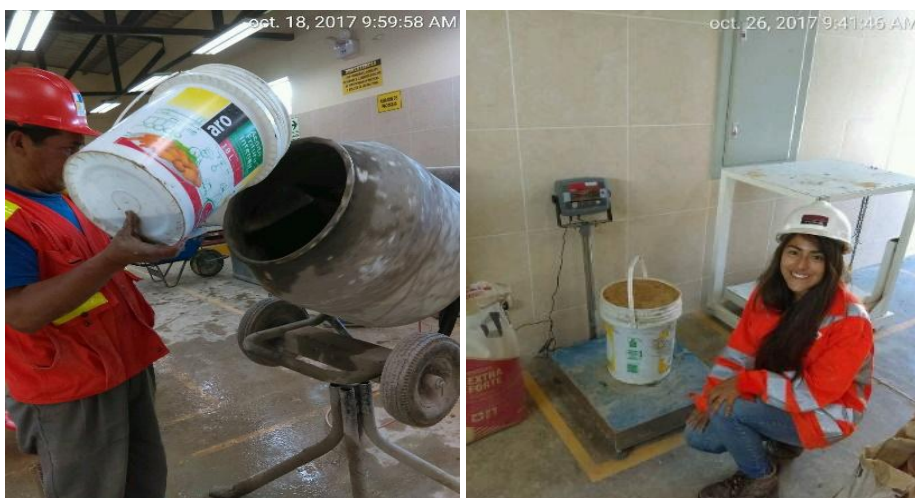
Figura 56. Elaboración de mezcla de mortero
