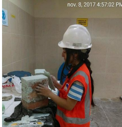
Figura 34. Refrentado de pilas de unidades de albañilería
