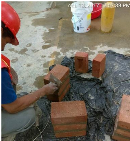
Figura 59. Elaboración de las pilas de unidades de arcilla artesanal
