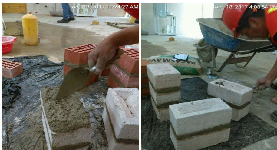
Figura 57. Elaboración de las pilas de unidades de concreto
