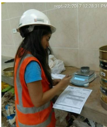
Figura 51. Ensayo de granulometría
