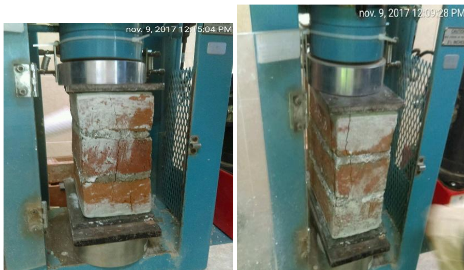
Figura 64. Fallas de pilas de unidades de arcilla
