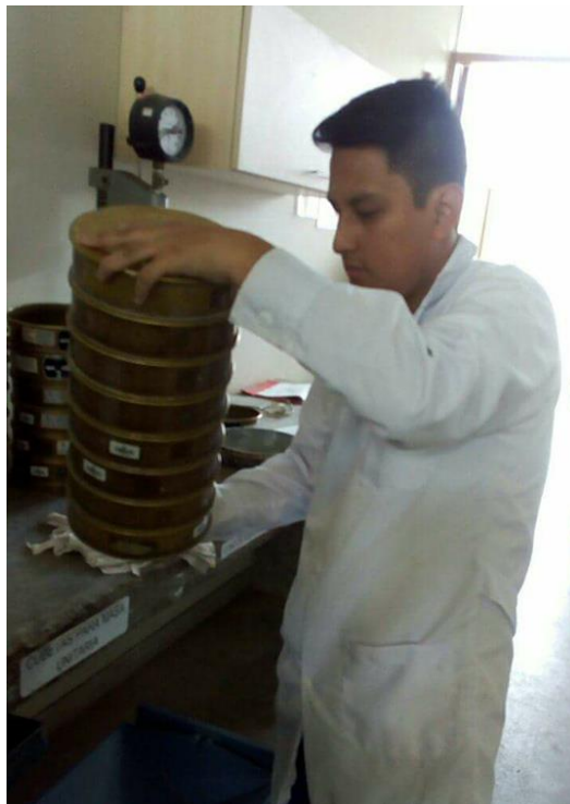
Ilustración 39: Tamizado del Agregado Grueso
