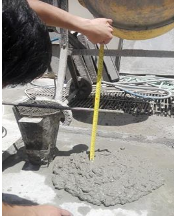
Ilustración 62: Asentamiento de Concreto con Aditivo Sika WT-100
