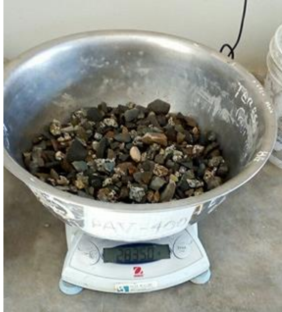
Ilustración 48: Peso Superficialmente seco del Agregado Grueso
