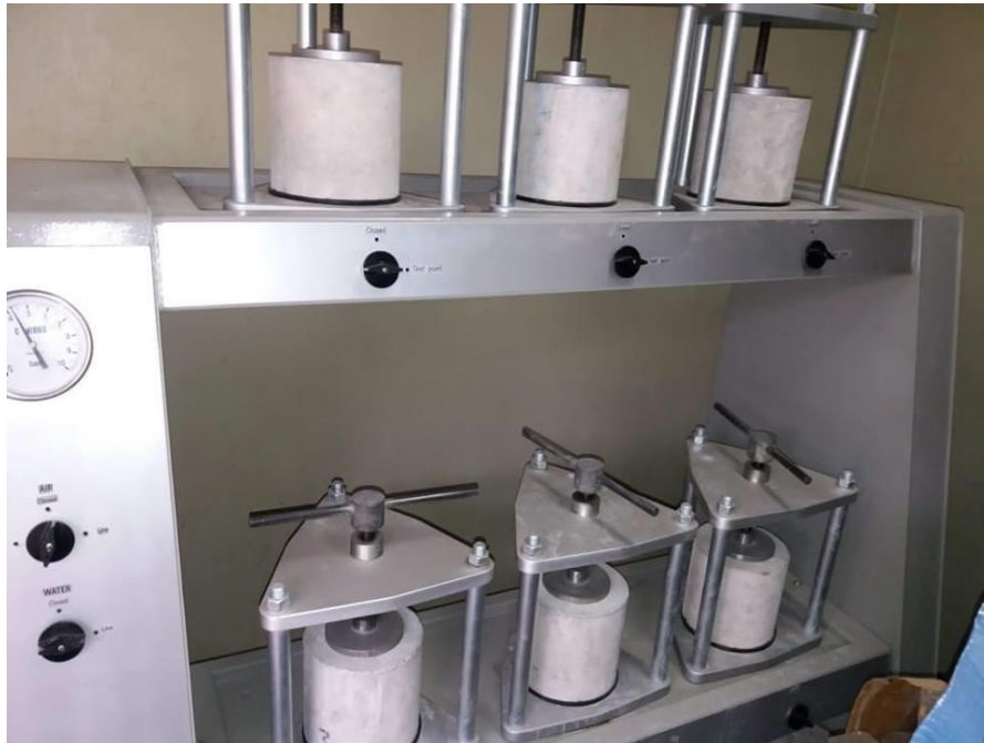
Ilustración 81: Probetas de Concreto sometidas a presión de agua
