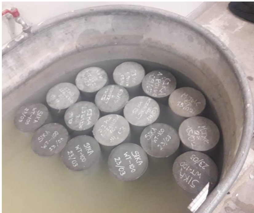
Ilustración 71: Curado de Probetas Cilíndricas de Concreto
