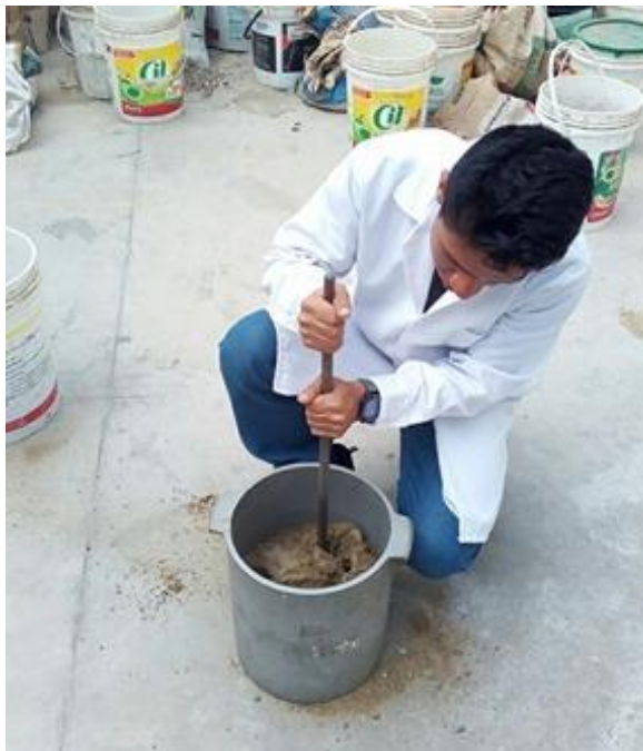
Ilustración 45: Peso Compactado del Agregado Fino
