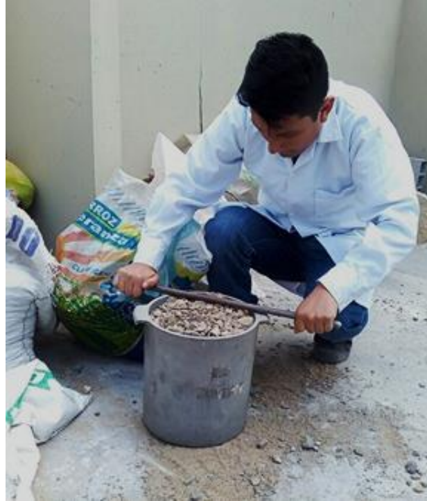
Ilustración 42: Peso Suelto del Agregado Grueso
