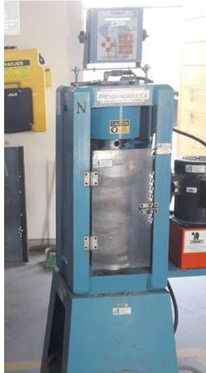
Ilustración 76: Ensayo de Resistencia a la Compresión del Concreto con Aditivo Sika 1 líquido (4%)
