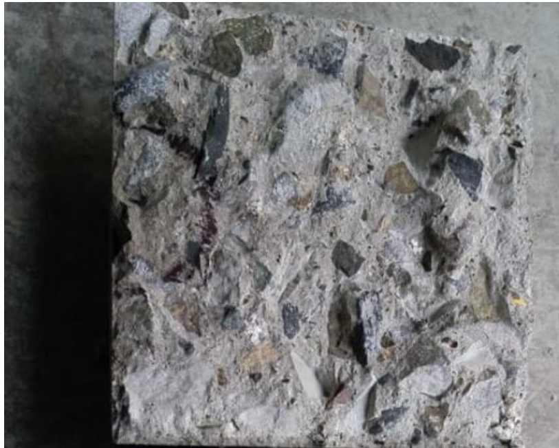
Ilustración 90: Penetración de agua en el Concreto con 2% de Aditivo Sika 1 Líquido
