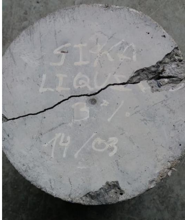
Ilustración 85: Ensayo de Permeabilidad del Concreto con 3% de Aditivo Sika 1 Líquido
