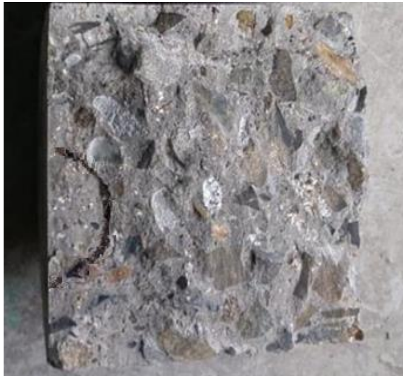
Ilustración 92: Penetración de agua en el Concreto con 4% de Aditivo Sika 1 Líquido
