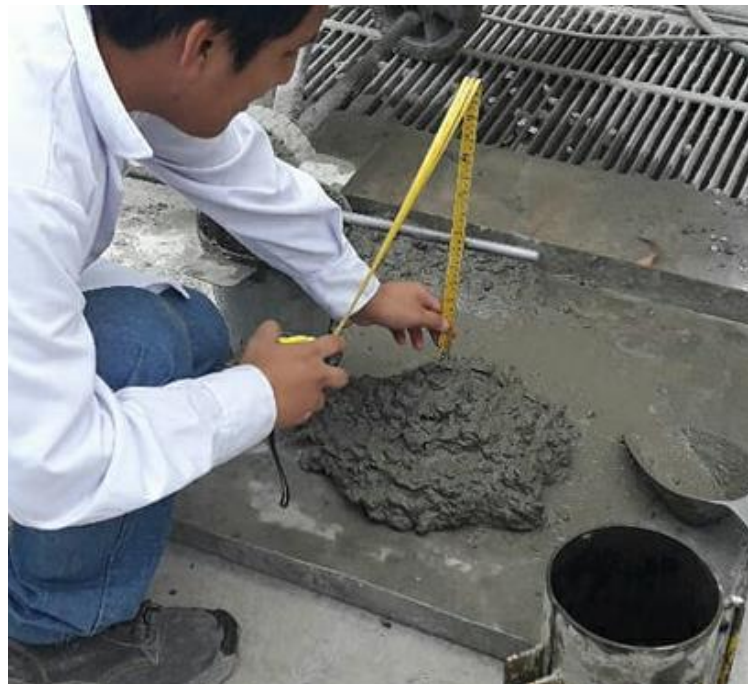
Ilustración 61: Asentamiento de Concreto Patrón
