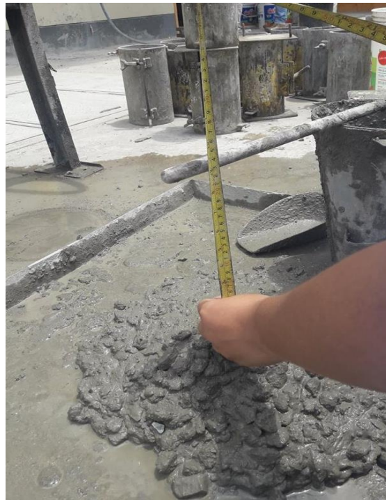
Ilustración 65: Asentamiento de Concreto con Aditivo Sika 1 Líquido (3%)
