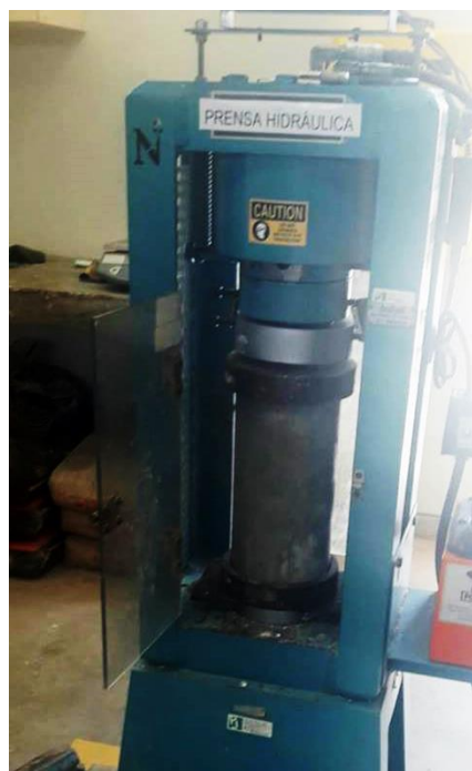
Ilustración 75: Ensayo de Resistencia a la Compresión del Concreto con Aditivo Sika 1 líquido (3%)
