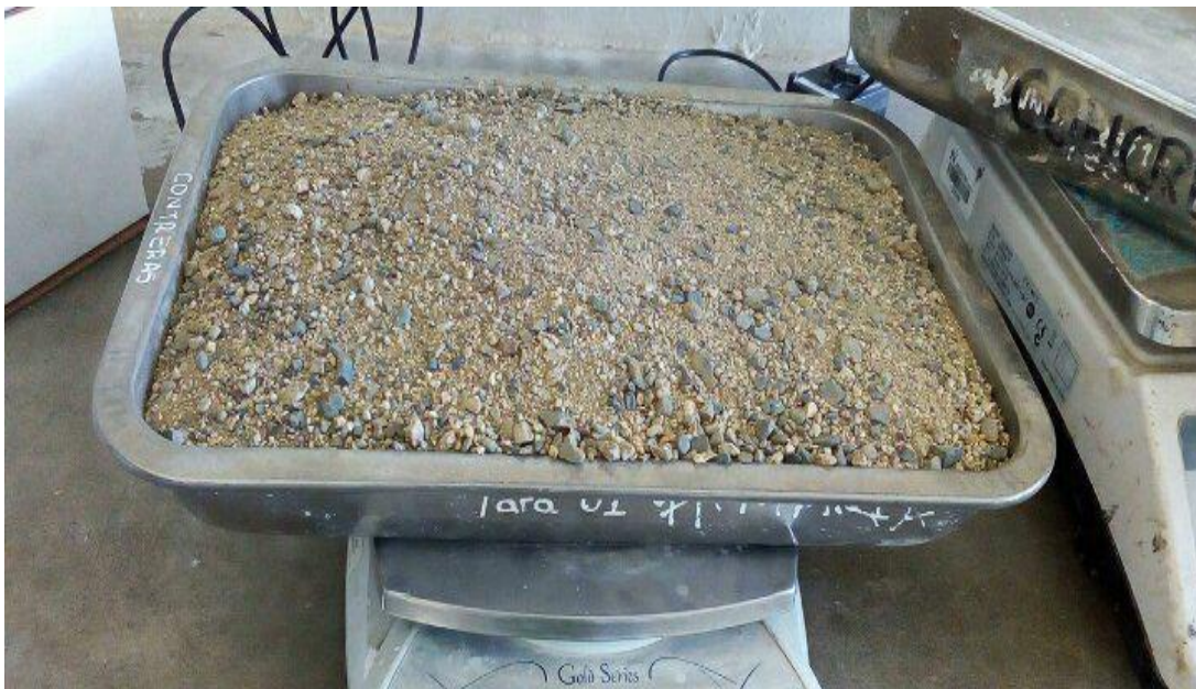
Ilustración 35: Agregado Fino para Contenido de Humedad
