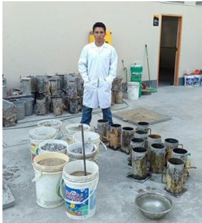
Ilustración 53: Materiales y Moldes para las Probetas de Concreto
