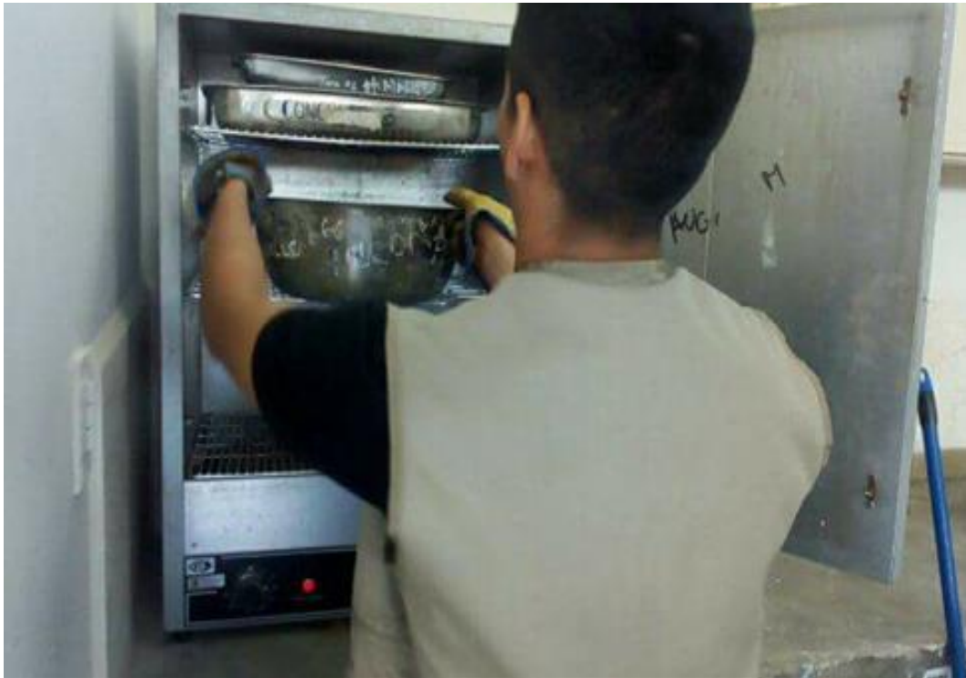
Ilustración 34: Muestra en el Horno del Agregado Grueso para Contenido de Humedad
