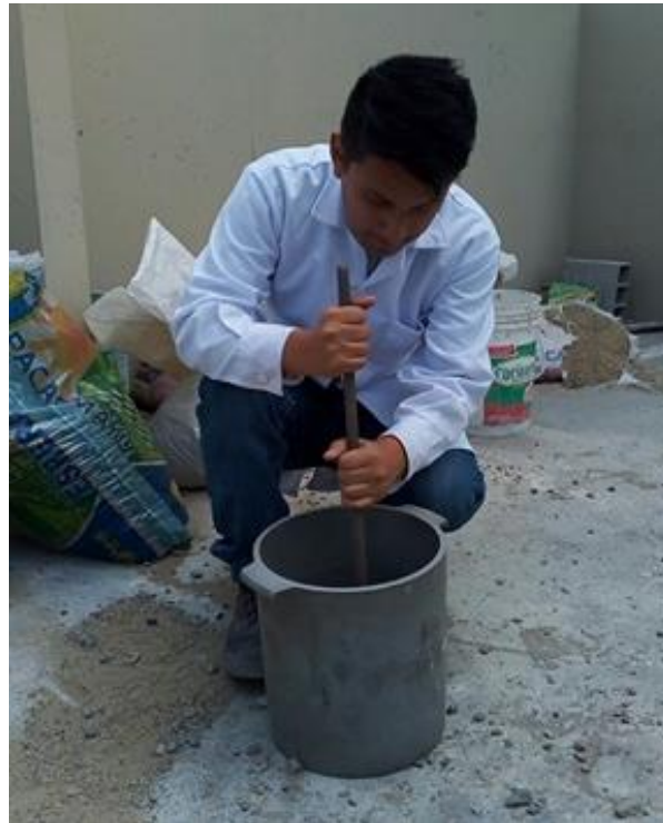
Ilustración 43: Peso Suelto del Agregado Grueso
