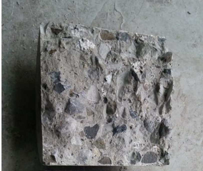
Ilustración 93: Penetración de agua en el Concreto con Aditivo Sika 1 en Polvo
