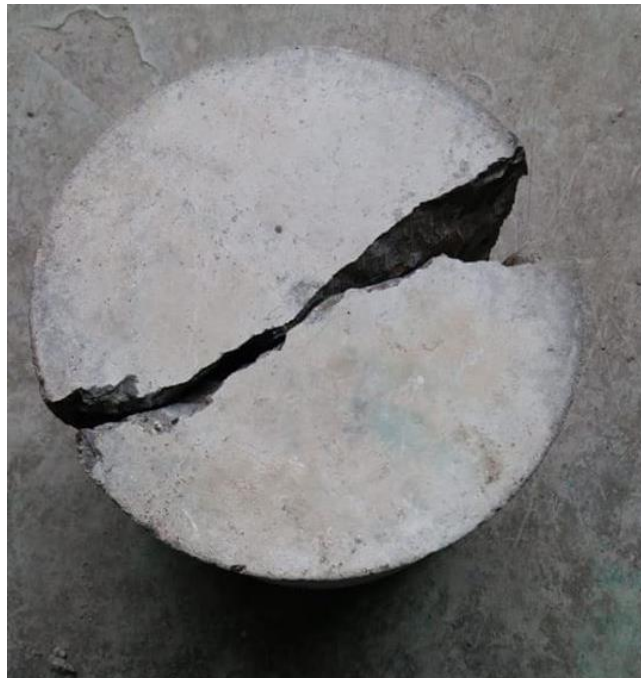
Ilustración 82: Ensayo de Permeabilidad del Concreto Patrón
