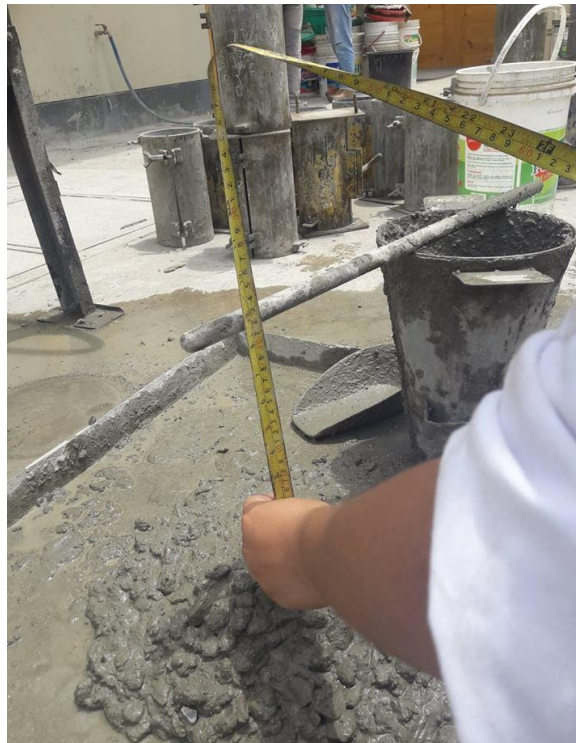
Ilustración 63: Asentamiento de Concreto con Aditivo Sika 1 en Polvo
