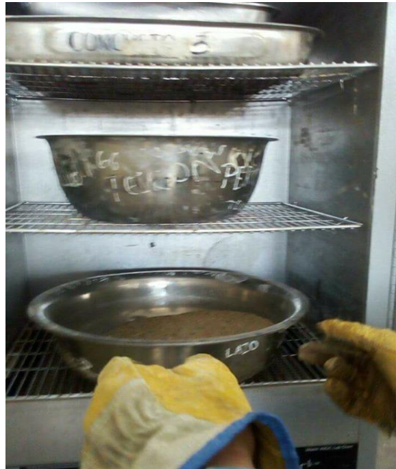
Ilustración 36: Muestra en el Horno del Agregado Fino para Contenido de Humedad
