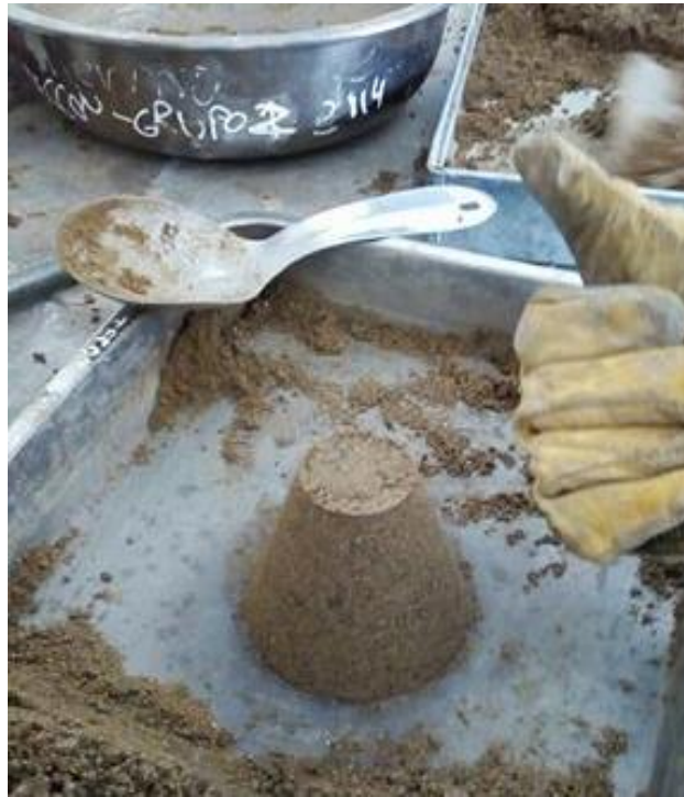
Ilustración 50: Pisonado del Agregado Fino
