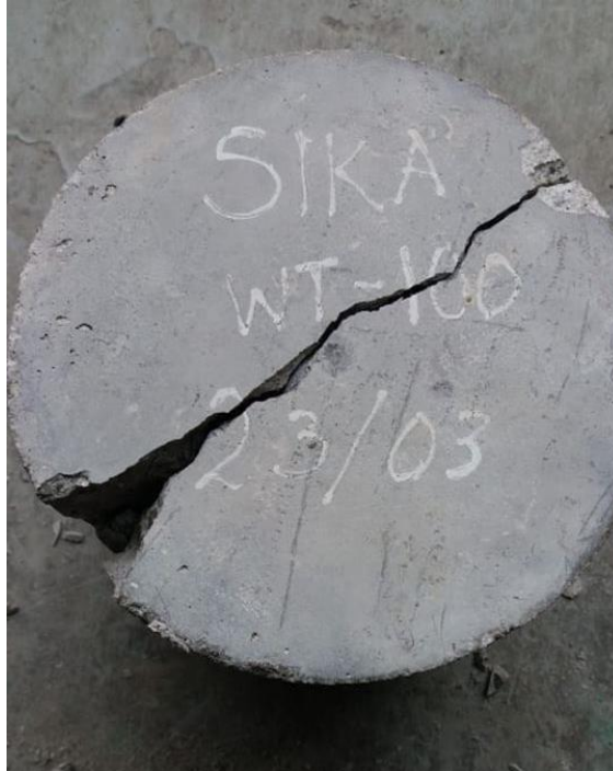
Ilustración 83: Ensayo de Permeabilidad del Concreto con Aditivo Sika WT-100
