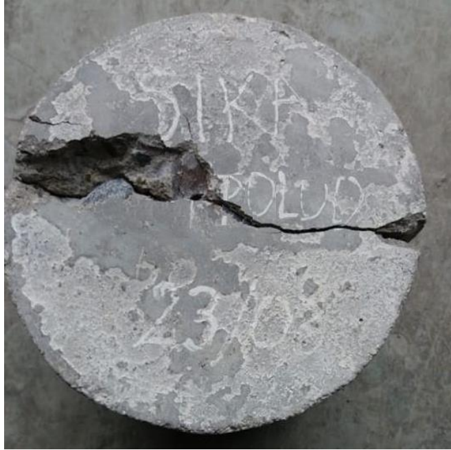
Ilustración 87: Ensayo de Permeabilidad del Concreto con Aditivo Sika 1 en Polvo
