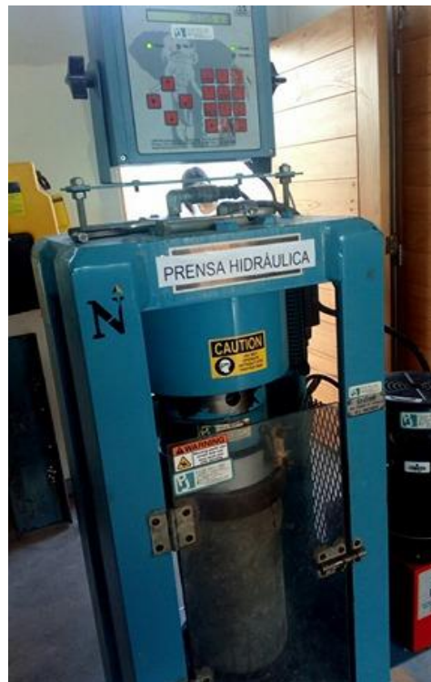
Ilustración 73: Ensayo de Resistencia a la Compresión del Concreto con Aditivo Sika WT-100
