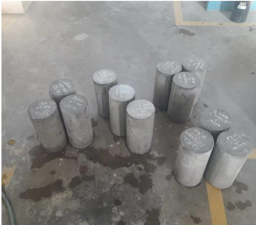
Ilustración 70: Probetas Cilíndricas de Concreto
