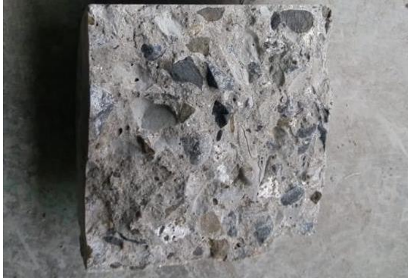
Ilustración 89: Penetración de agua en el Concreto con Aditivo Sika WT-100
