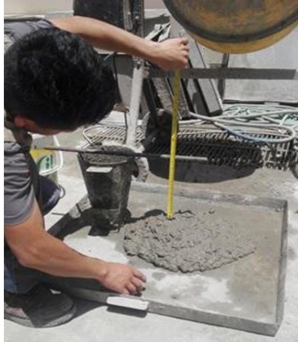
Ilustración 66: Asentamiento de Concreto con Aditivo Sika 1 Líquido (4%)
