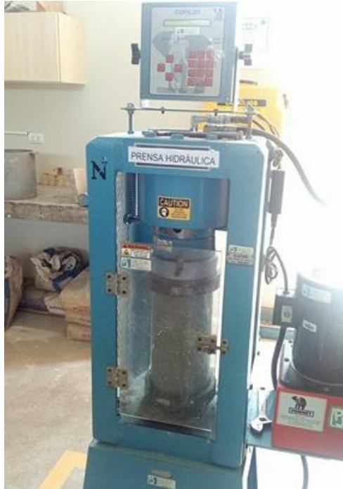
Ilustración 74: Ensayo de Resistencia a la Compresión del Concreto con Aditivo Sika 1 líquido (2%)
