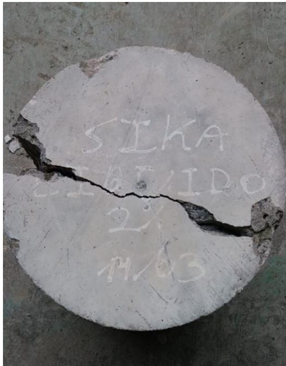
Ilustración 84: Ensayo de Permeabilidad del Concreto con 2% de Aditivo Sika 1 Líquido
