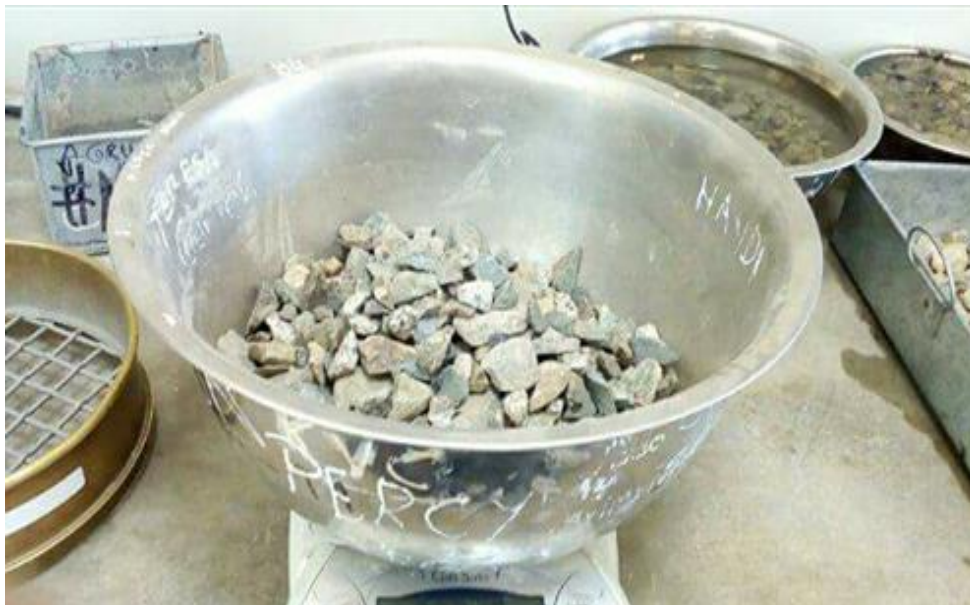
Ilustración 33: Agregado Grueso para Contenido de Humedad
