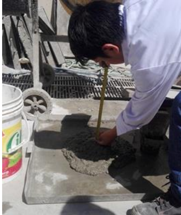
Ilustración 64: Asentamiento de Concreto con Aditivo Sika 1 Líquido (2%)
