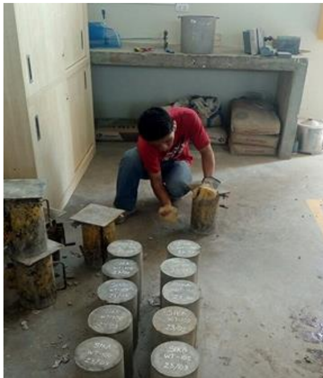
Ilustración 69: Desencofrado de Probetas
