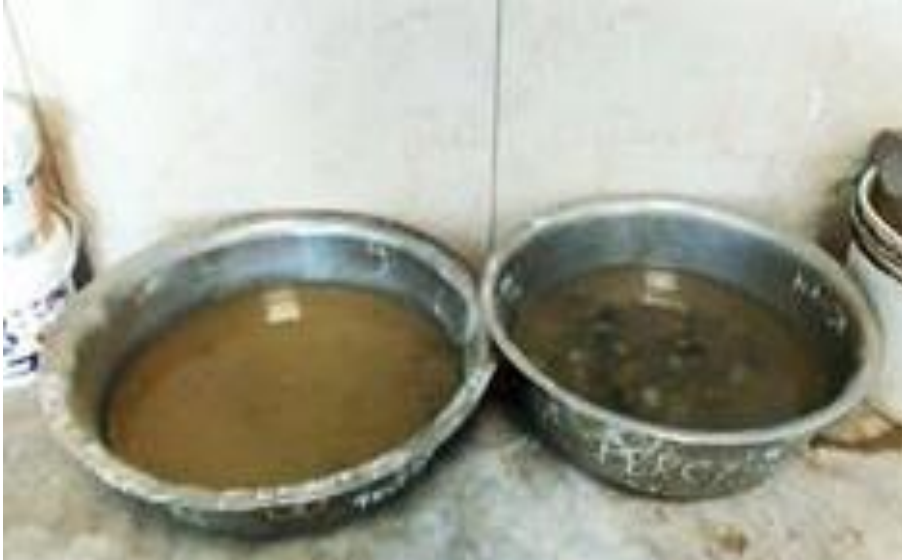
Ilustración 46: Agregado Grueso y Fino Saturados
