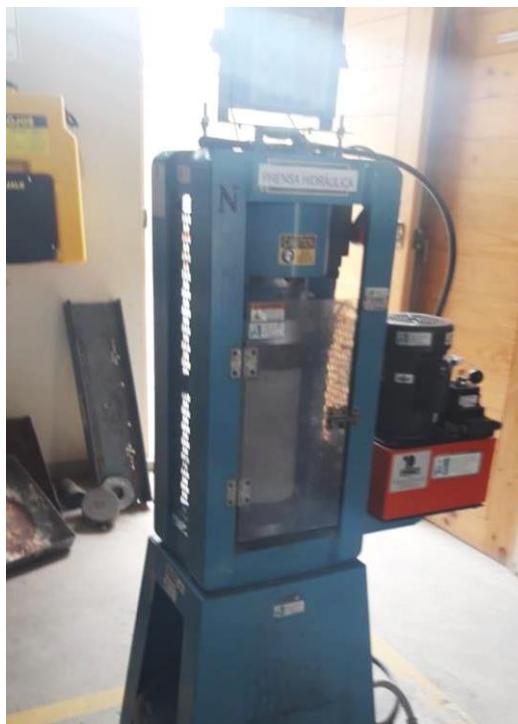
Ilustración 77: Ensayo de Resistencia a la Compresión del Concreto con Aditivo Sika 1 en polvo
