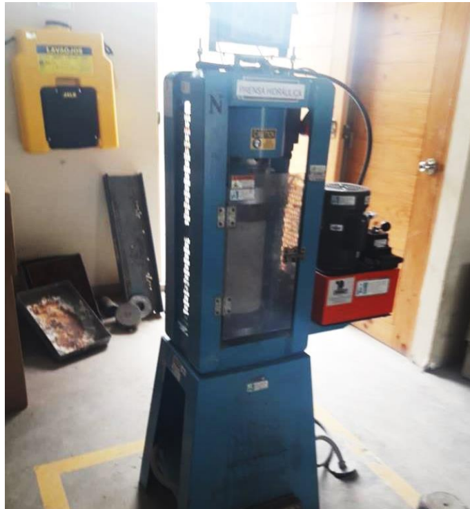
Ilustración 72: Ensayo de Resistencia a la Compresión del Concreto Patrón
