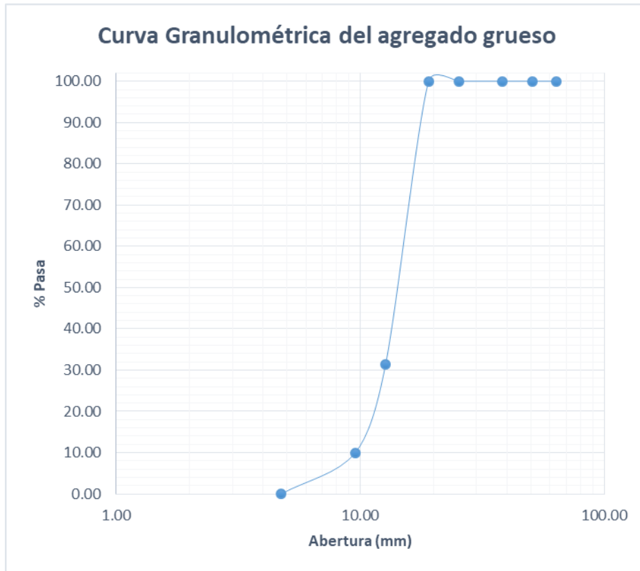
Ilustración 12: Curva Granulométrica del Agregado Grueso
