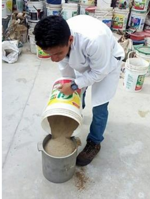
Ilustración 44: Peso Suelto del Agregado Fino
