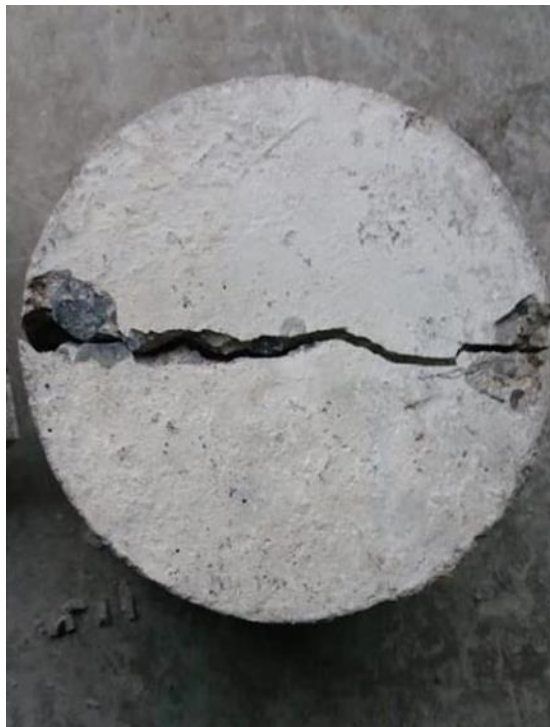
Ilustración 86: Ensayo de Permeabilidad del Concreto con 4% de Aditivo Sika 1 Líquido
