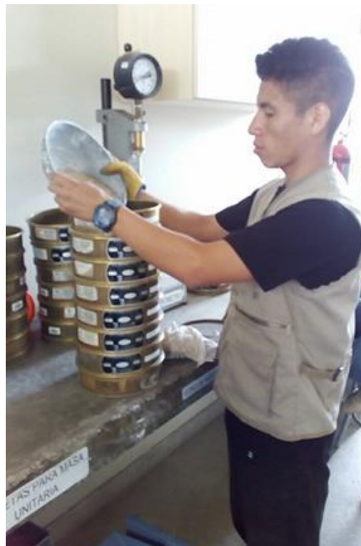
Ilustración 41: Granulometría del Agregado Fino
