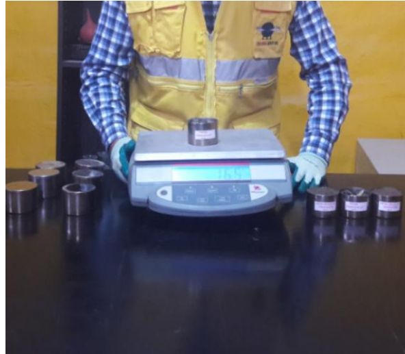
Figura 44 Peso de los agregados después del secado.
