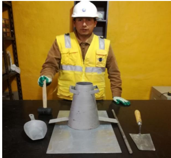
Figura 23 Cono de Abrams y accesorios
