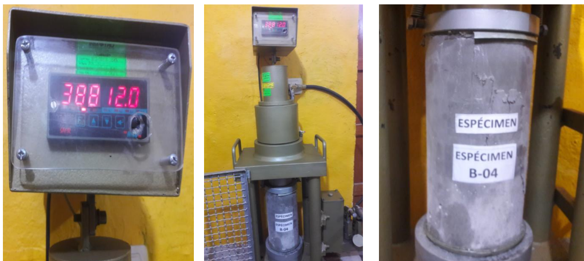
Figura 97 Dato de rotura de espécimen B-4
