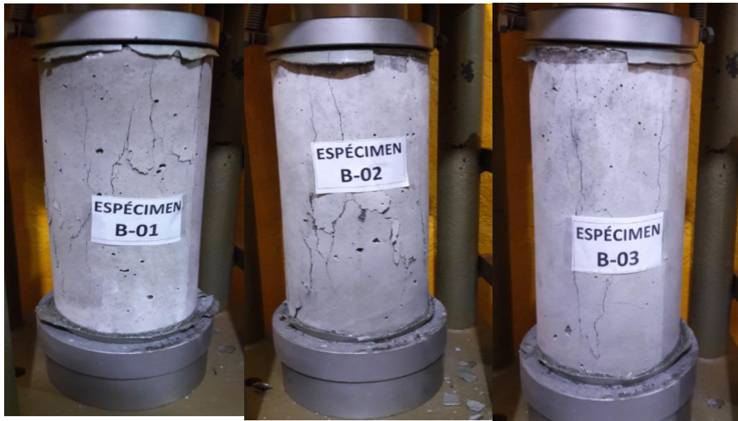
Figura 94 Vista de rotura de espécimen B-1, B-2, B-3 3 Rotura Columnar
