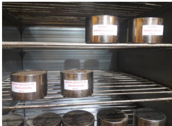
Figura 42 Vista de las taras con el agregado Fino y grueso en el interior del Horno para secado.
