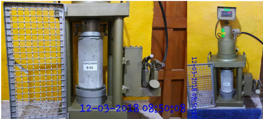
Figura 88 Preparando para rotura de espécimen B-1
