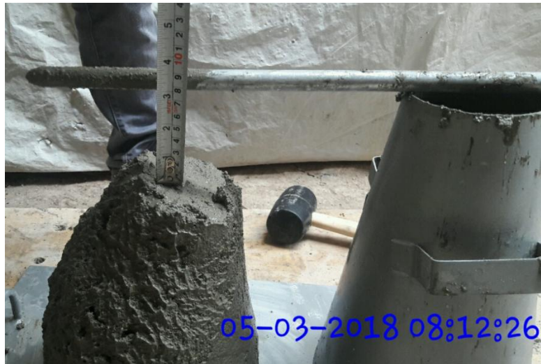
Figura 59 Imagen justo después del levantamiento del molde. 3" consistencia Blanda.
