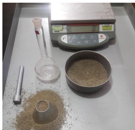
Figura 45 Materiales para el ensayo agregado Fino- Gravedad Específica y Absorción de Agregado ASTM C-128
