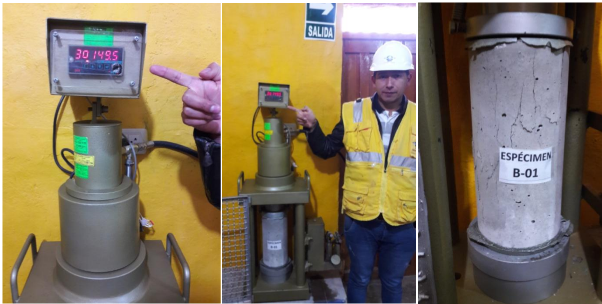
Figura 89 Dato de rotura de espécimen B-1
