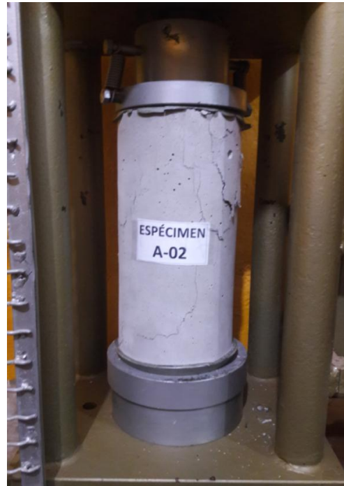
Figura 113 Medición de resistencia a la compresión
