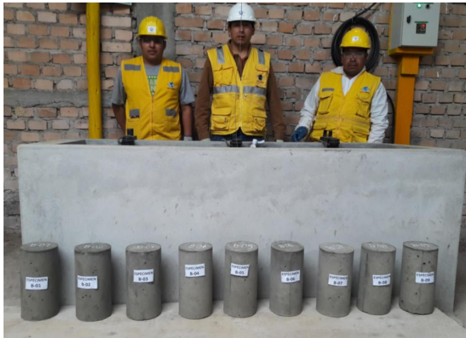
Figura 85 Preparando Especímenes ingreso a poza de curado
