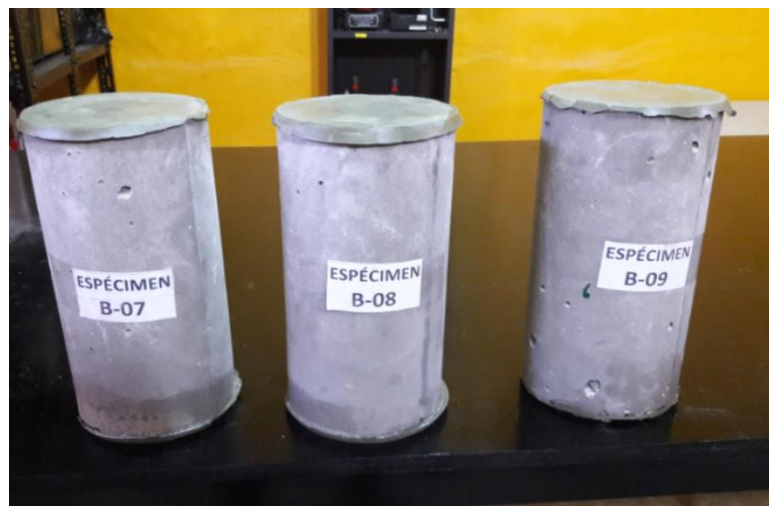
Figura 103 Capeado de especímenes 28 días.
