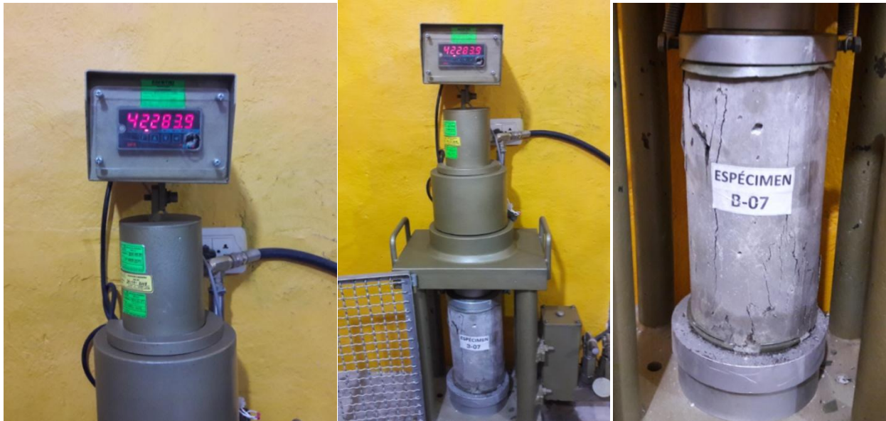
Figura 105 Dato de rotura de espécimen B-7
