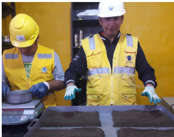
Figura 30 Cuarteo del agregado Fino para análisis granulométrico.
