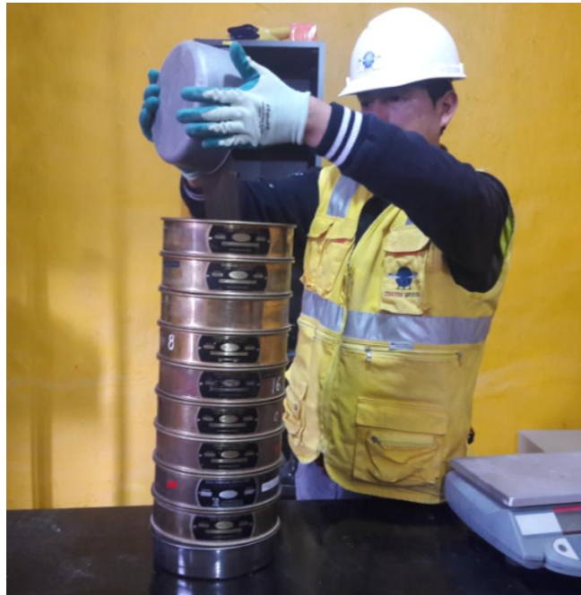
Figura 37 Preparado de Mallas tamiz e ingreso de agregado Fino
