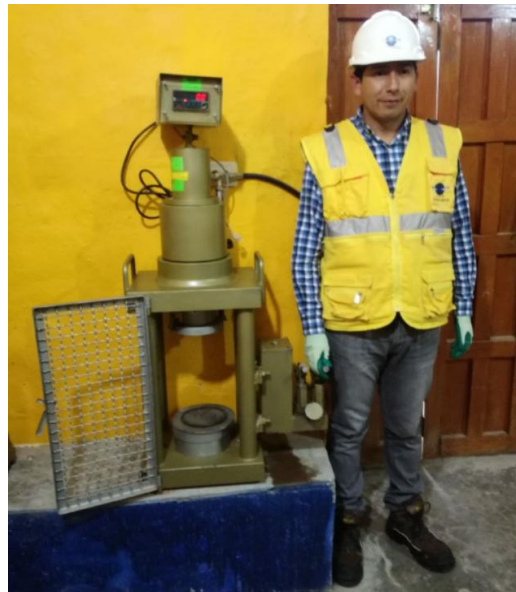
Figura 25 Prensa Hidráulica 200 tn con contador electrónico
