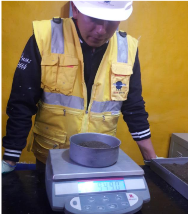
Figura 35 Pesar el agregado Fino para análisis granulométrico
