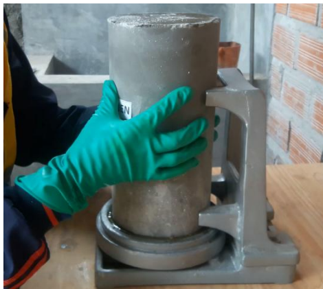
Figura 76 Luego colocar el espécimen para coronar o cabecear el espécimen en ambos lados con un grosor de 3 a 5 mm.
