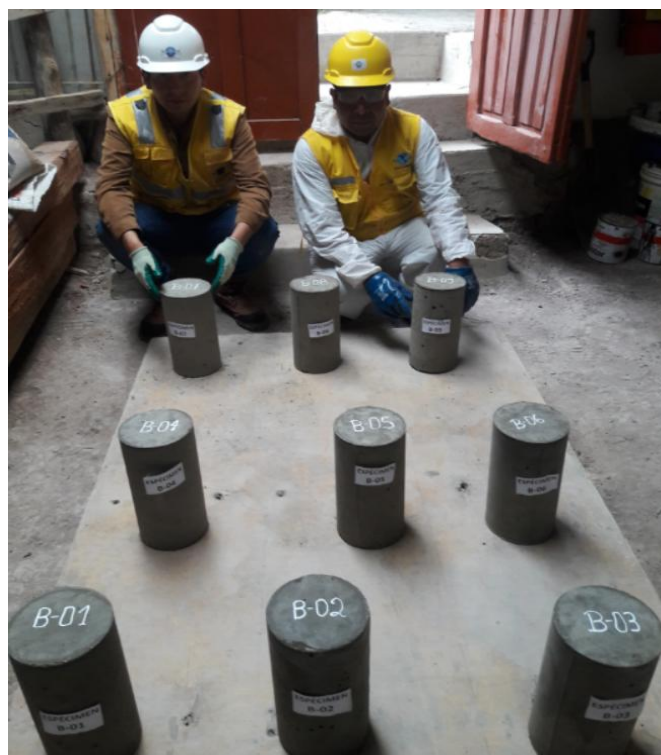
Figura 84 Etiquetado de Especímenes.
