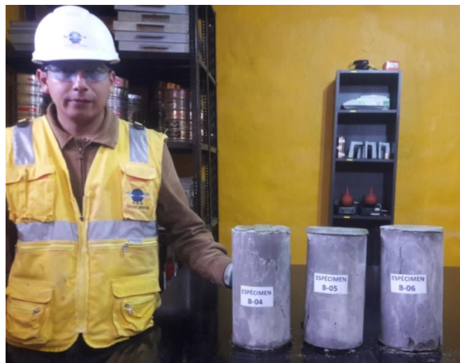
Figura 95 Capeado de especímenes 14 días.
