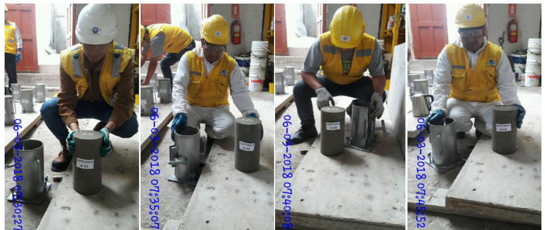
Figura 65 Desmolde de Especímenes
