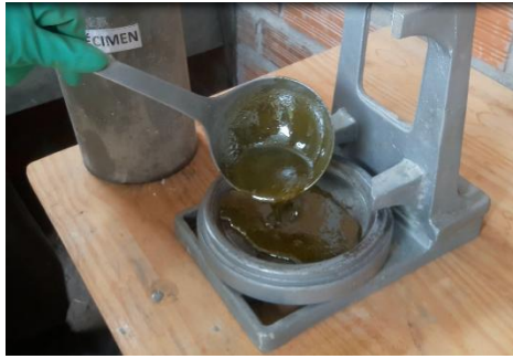
Figura 75 Posteriormente verter en Capeador
