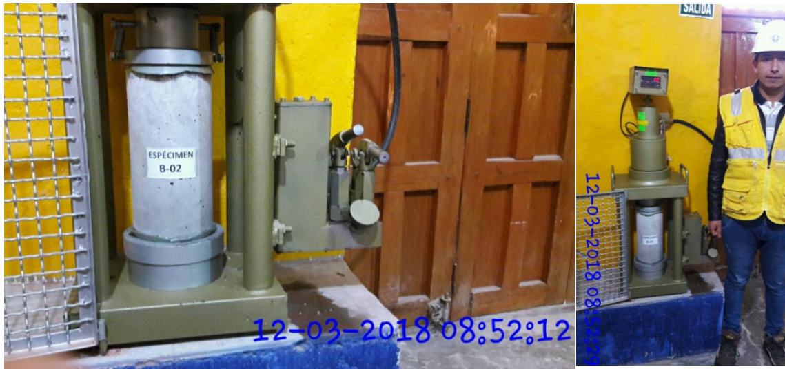
Figura 90 Preparando para rotura de espécimen B-2
