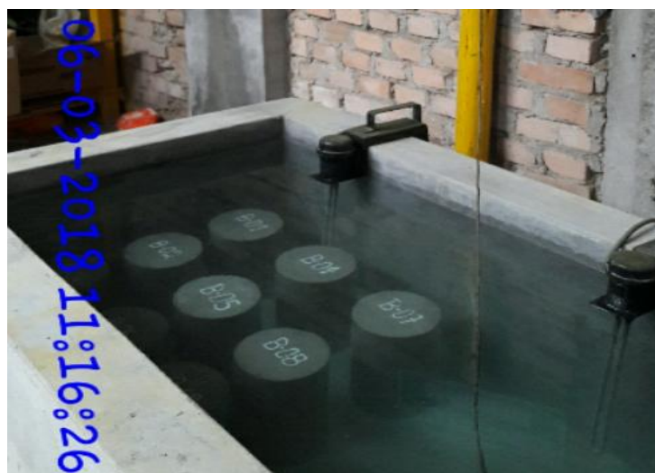
Figura 61 Poza de curado, Los especímenes pasan 28 días en esta poza.
