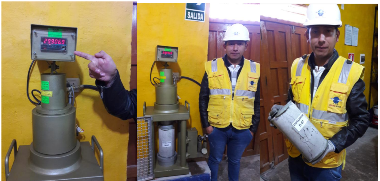
Figura 91 Dato de rotura de espécimen B-2
