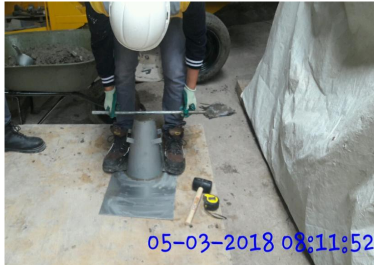
Figura 57 Verificando enrase y limpieza llenado del cono.
