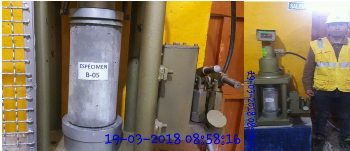
Figura 98 Preparando para rotura de espécimen B-5
