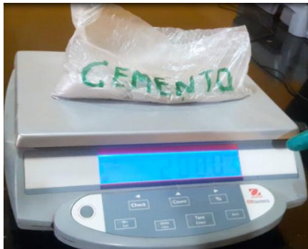
Figura 70 Vista de 200 Gramos de cemento portland
