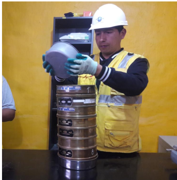
Figura 36 Preparado de Mallas tamiz e ingreso de agregado Grueso
