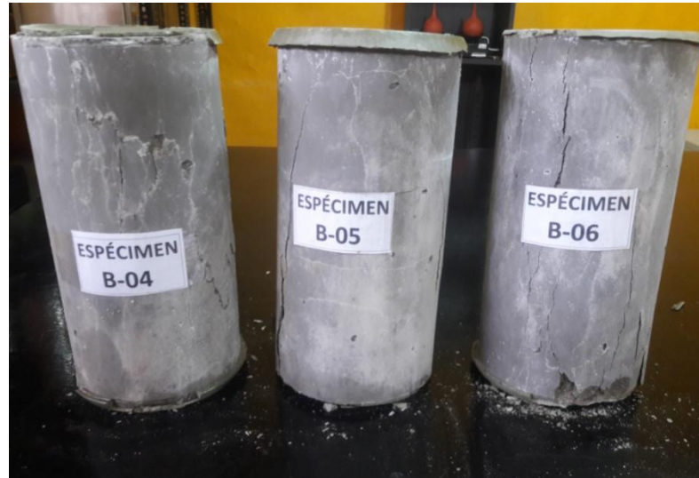
Figura 102 Vista de rotura de espécimen B-4, B-5, B-6 4 Rotura Columnar
