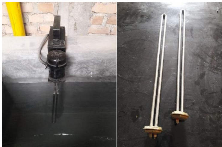
Figura 18 Resistencia de 3000 watts
