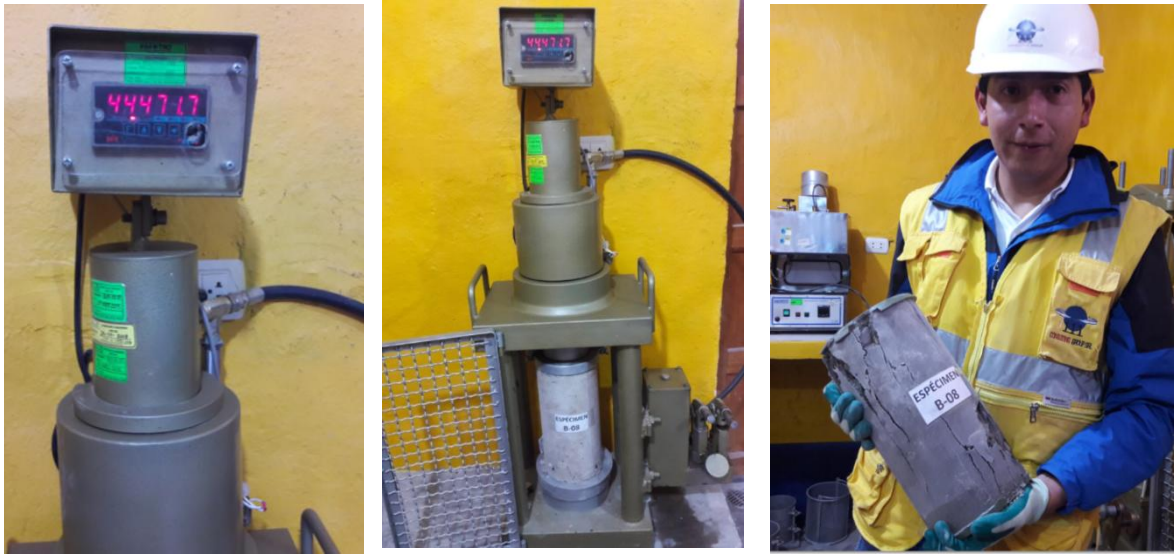
Figura 107 Dato de rotura de espécimen B-8
