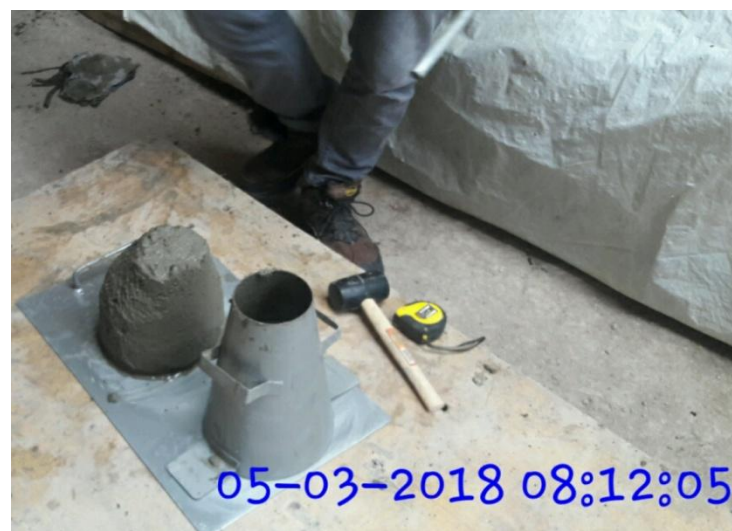
Figura 58 Imagen justo después del levantamiento del molde.
