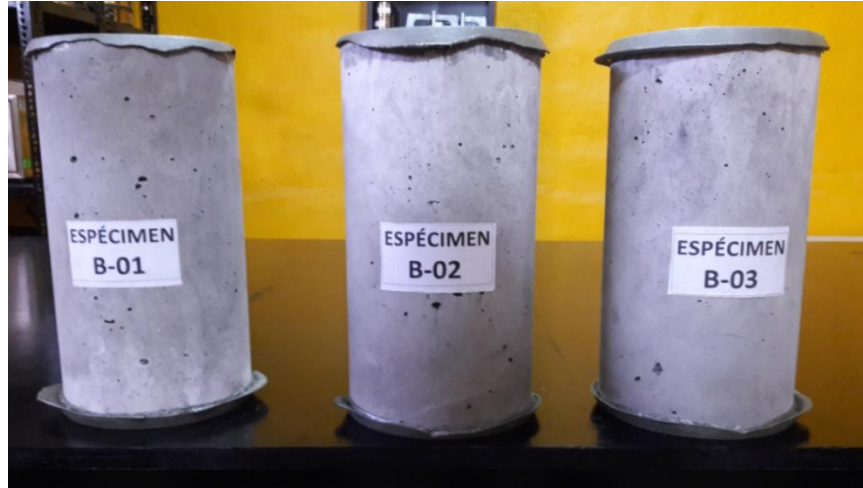
Figura 87 Capeado de especímenes 7 días
