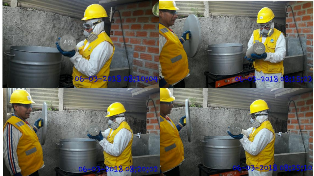
Figura 66 Ingreso de Especímenes al agua Hirviendo
