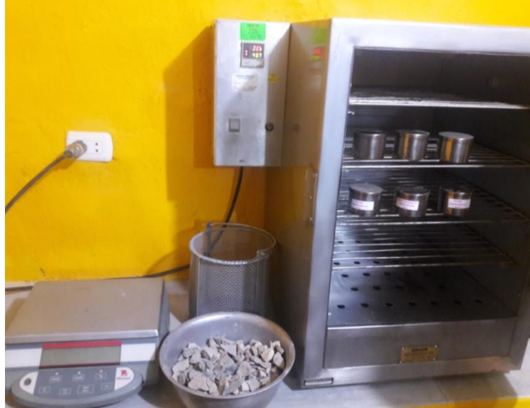
Figura 46 Materiales para el ensayo agregado Grueso - Gravedad Específica y Absorción de Agregado ASTM C-128
