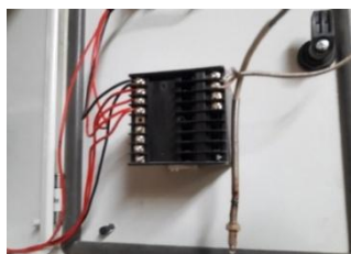
Figura 16 Termostato Sensor Modelo Pt100
