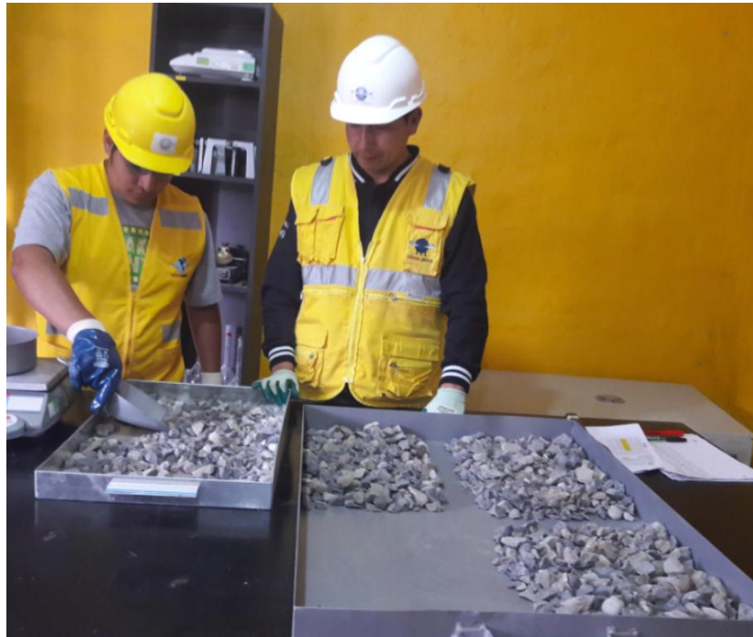
Figura 31 Cuarta parte agregado Grueso para análisis granulométrico
