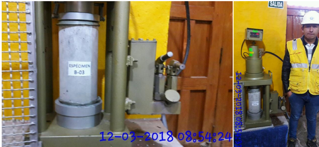
Figura 92 Preparando para rotura de espécimen B-3
