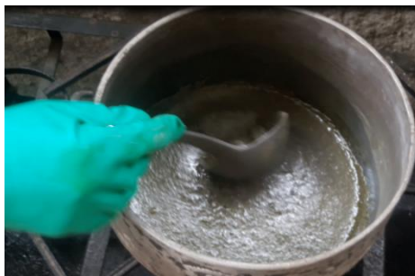
Figura 74 Calentar el azufre a mediante flama hasta fundirlo, siempre agitándolo constantemente.
