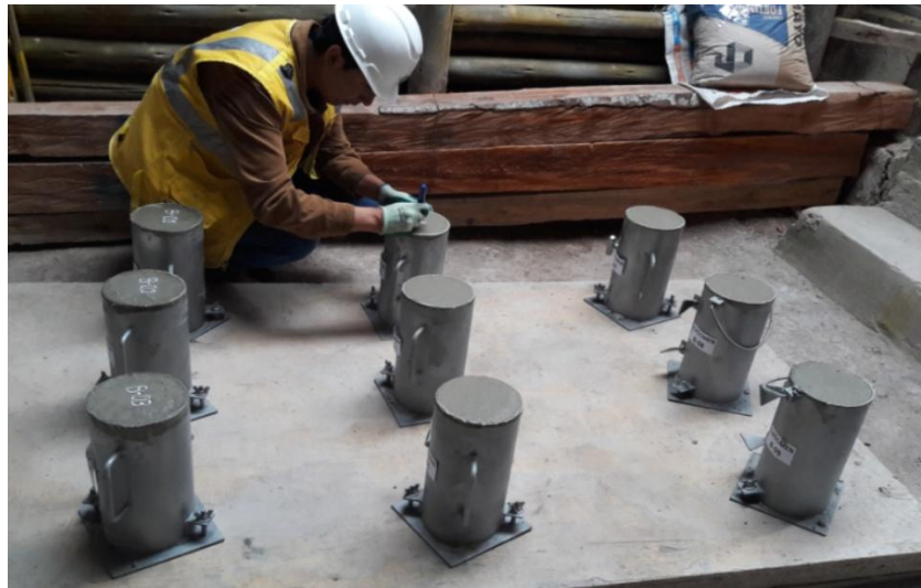
Figura 83 Etiquetado de Especímenes
