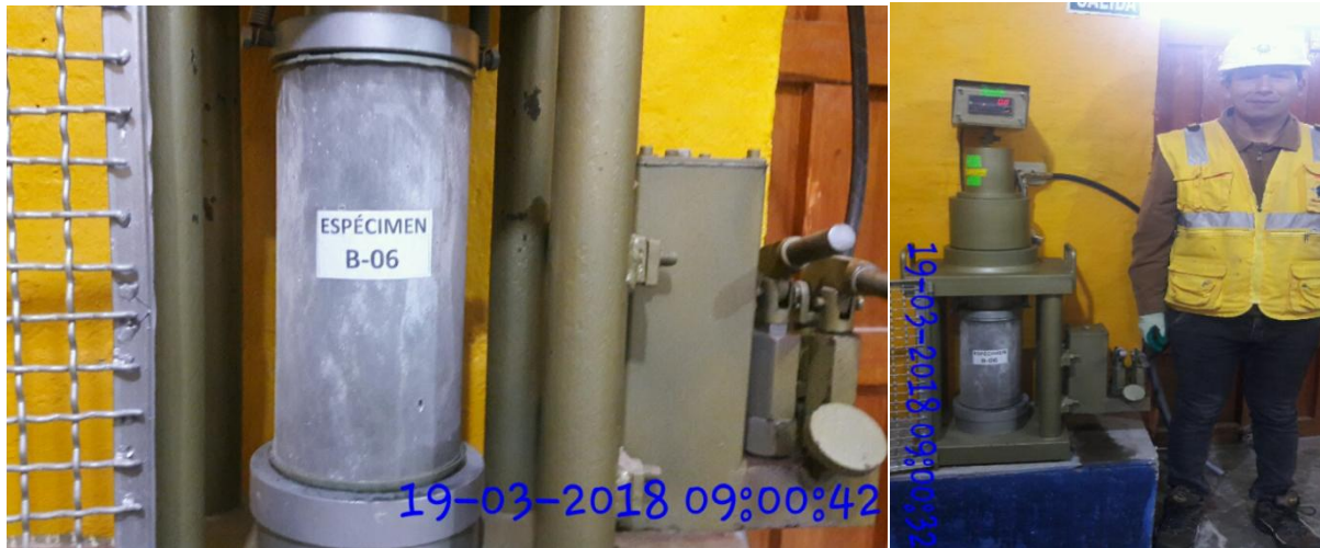
Figura 100 Preparando para rotura de espécimen B-6
