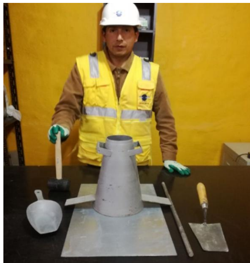
Figura 50 Materiales para el Ensayo en Laboratorio.
