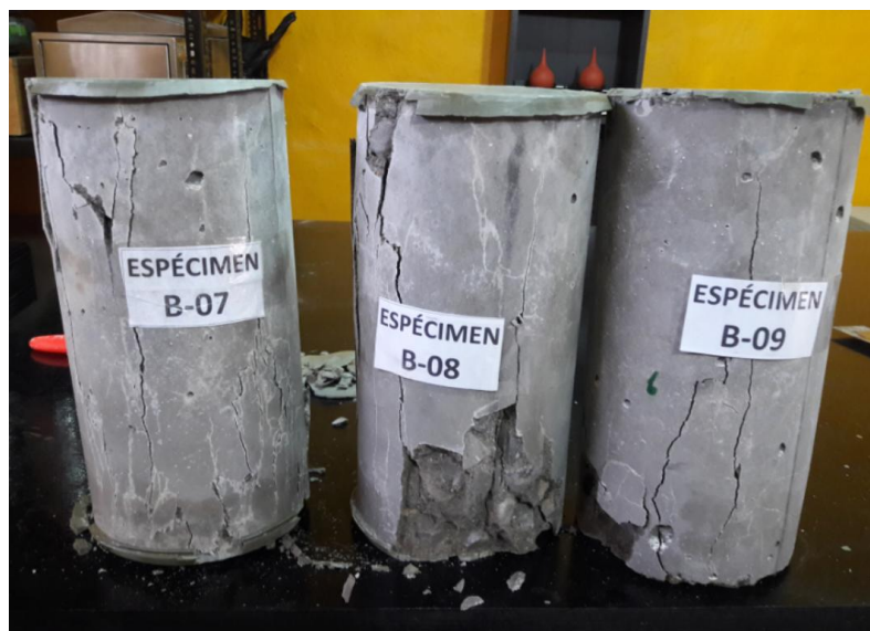
Figura 110 Vista de rotura de espécimen B-7, B-8, B-9. 5 Rotura Columnar y Cónica.
