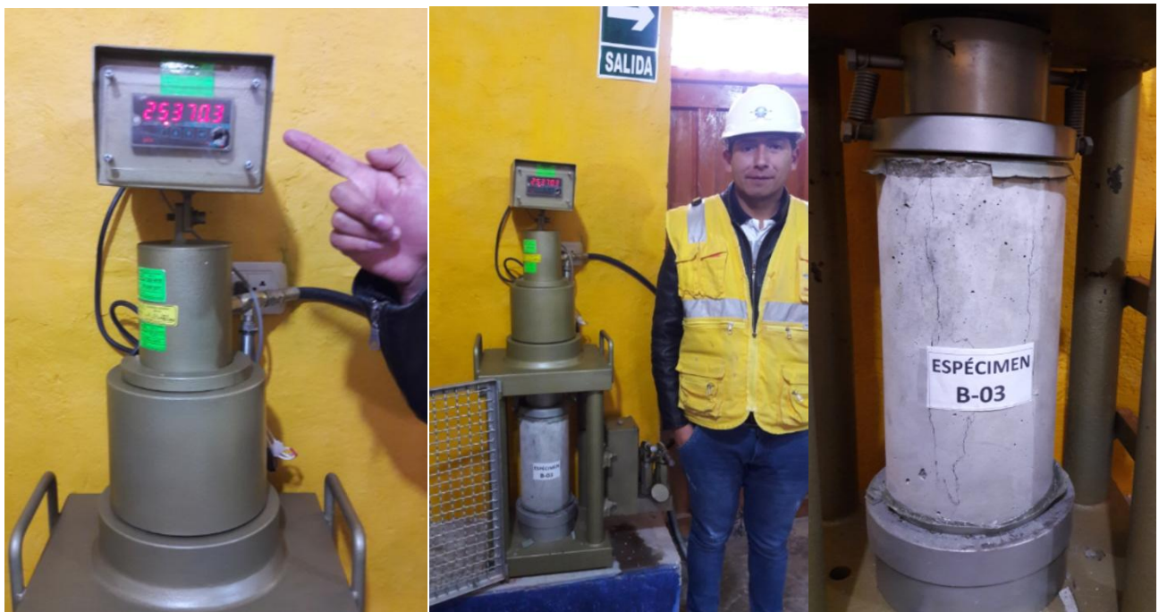
Figura 93 Dato de rotura de espécimen B-3
