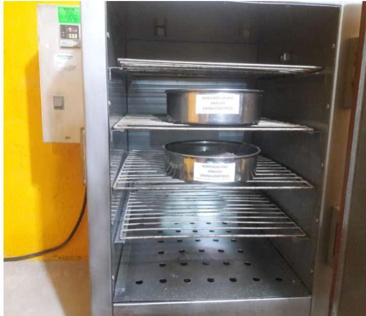
Figura 33 Secado en Horno de agregado Grueso y Fino para análisis granulométrico
