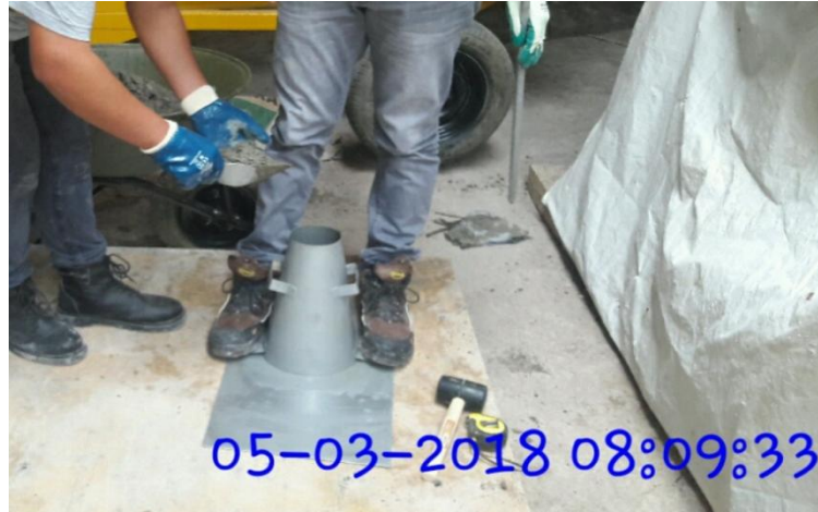
Figura 53 Empezando el ensayo SLUMP
