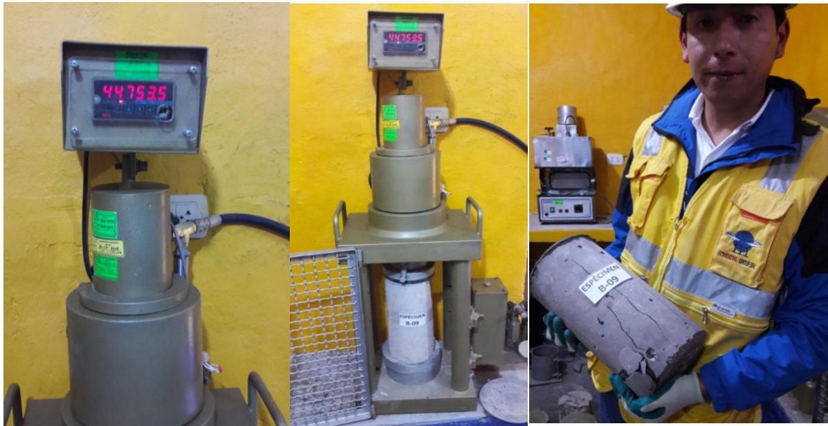
Figura 109 Dato de rotura de espécimen B-9
