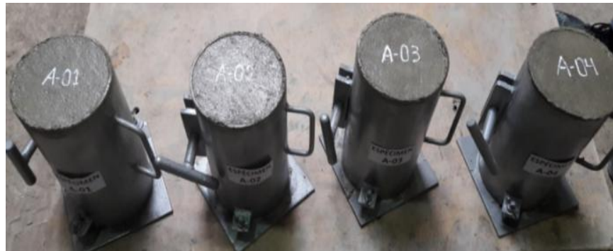
Figura 63 Moldes esperando su desmolde
