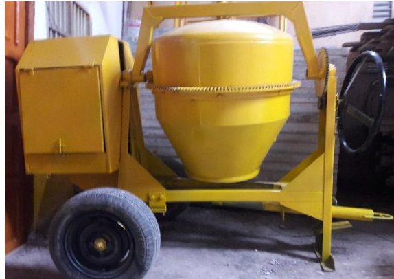
Figura 21 Mezcladora de concreto de 11 hp motor Honda
