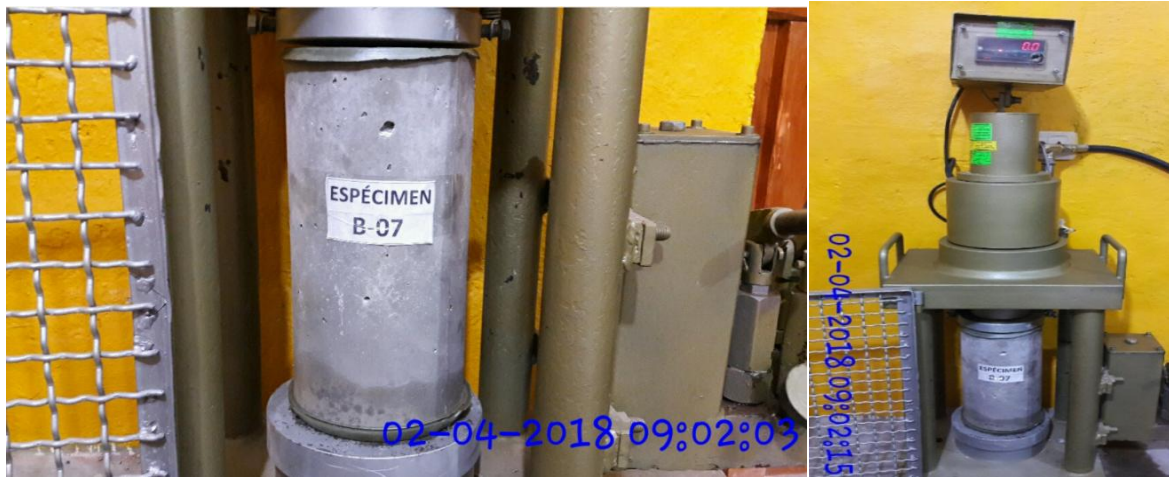
Figura 104 Preparando para rotura de espécimen B-7.
