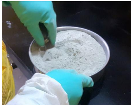
Figura 73 Verter y mezclar el azufre con el cemento en un recipiente.
