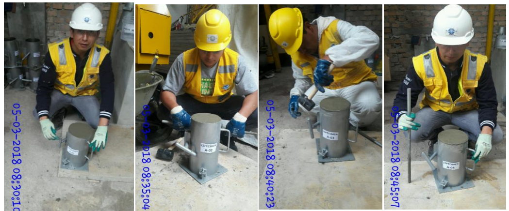
Figura 64 Moldeo de Especímenes
