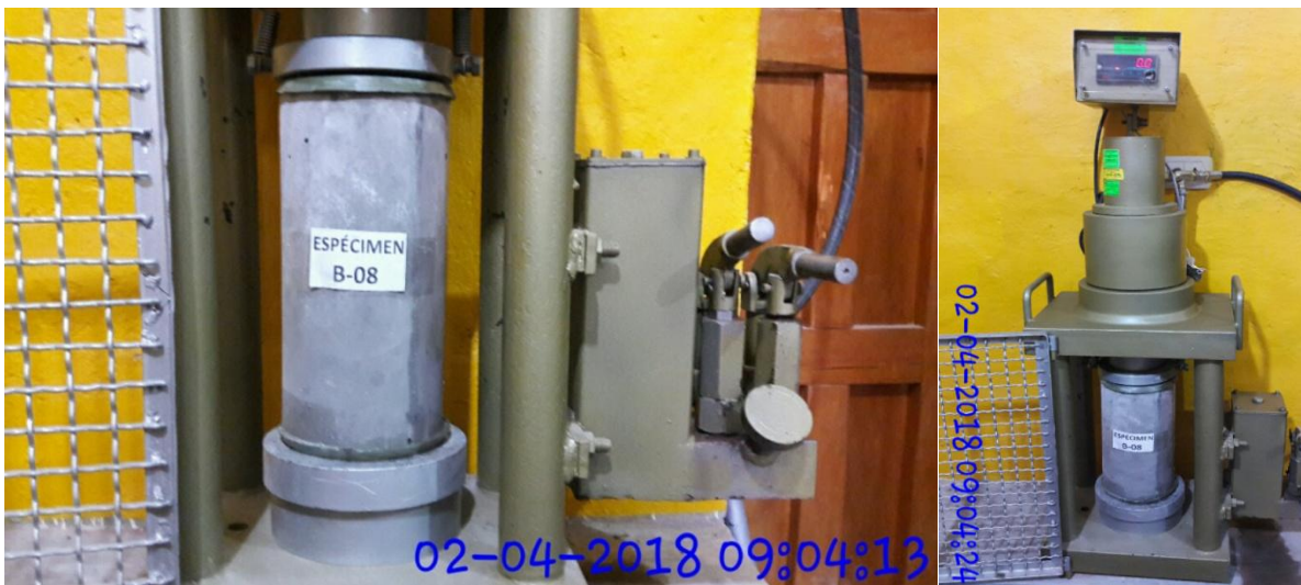
Figura 106 Preparando para rotura de espécimen B-8
