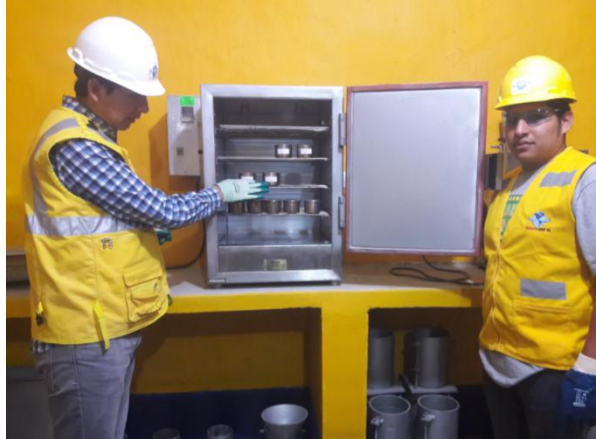
Figura 41 Ingreso de taras al Horno para secado.
