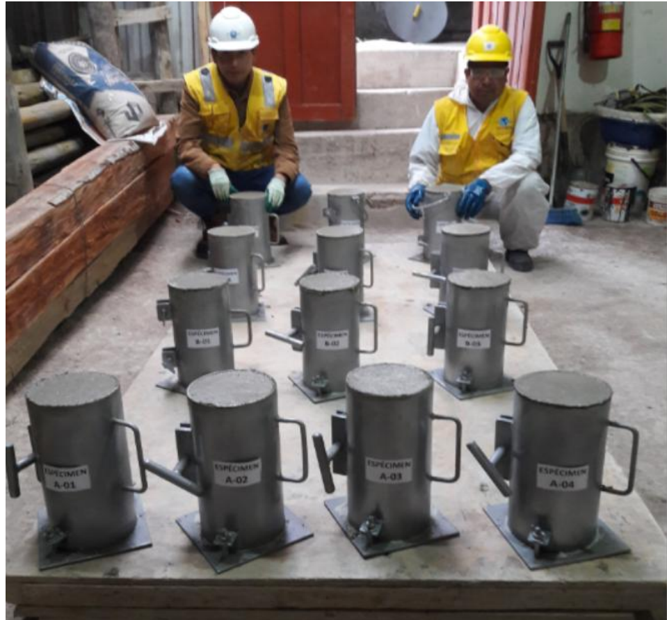
Figura 49 Especímenes de concreto destinados para Curado Acelerado y Estándar.
