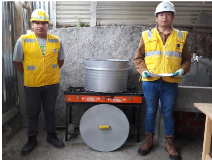
Figura 68 Vista del lugar del Curado Acelerado, y la instalación de la Grifería y el drenaje
