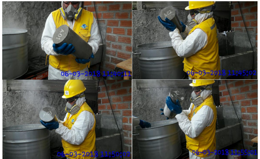
Figura 69 Sacamos los especímenes del agua Hirviendo después de 3.5h
