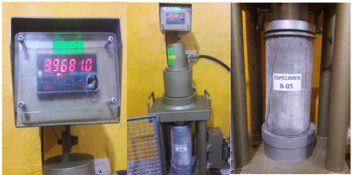
Figura 99 Dato de rotura de espécimen B-5
