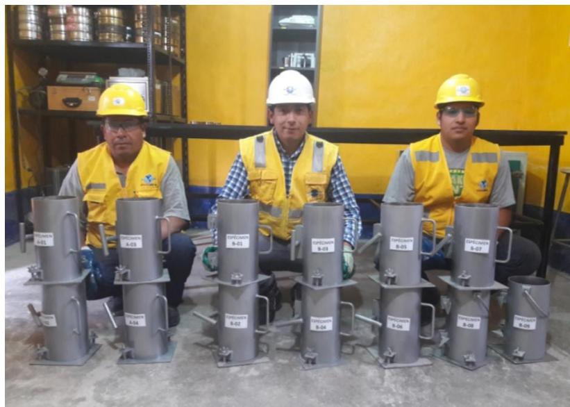
Figura 22 Molde de probeta para concreto
