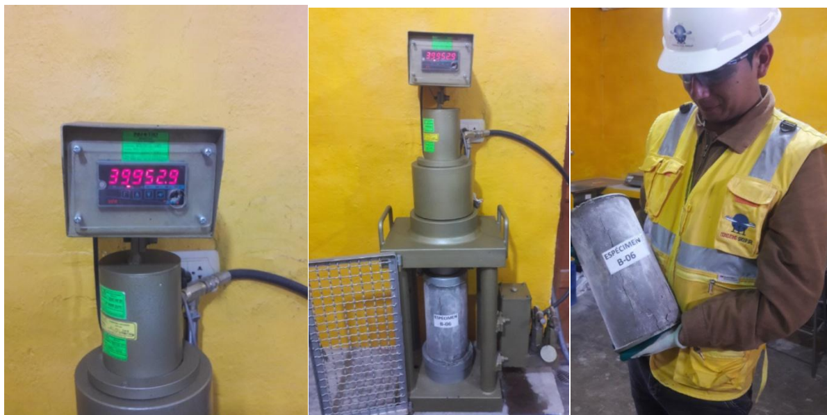
Figura 101 Dato de rotura de espécimen B-6
