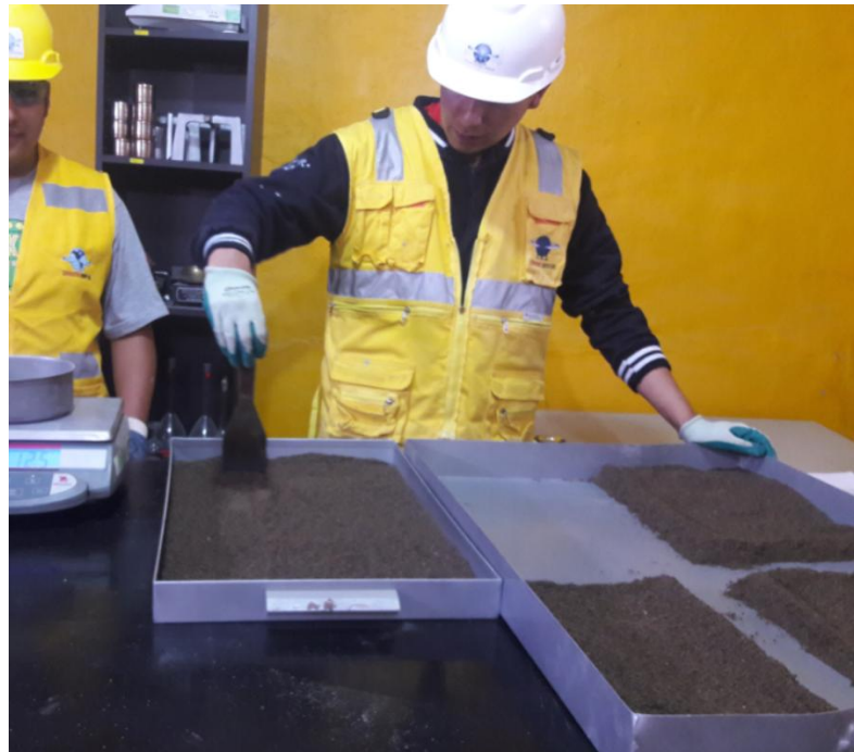
Figura 32 Cuarta parte agregado Fino para análisis granulométrico
