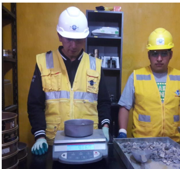
Figura 34 Pesar el agregado Grueso para análisis granulométrico
