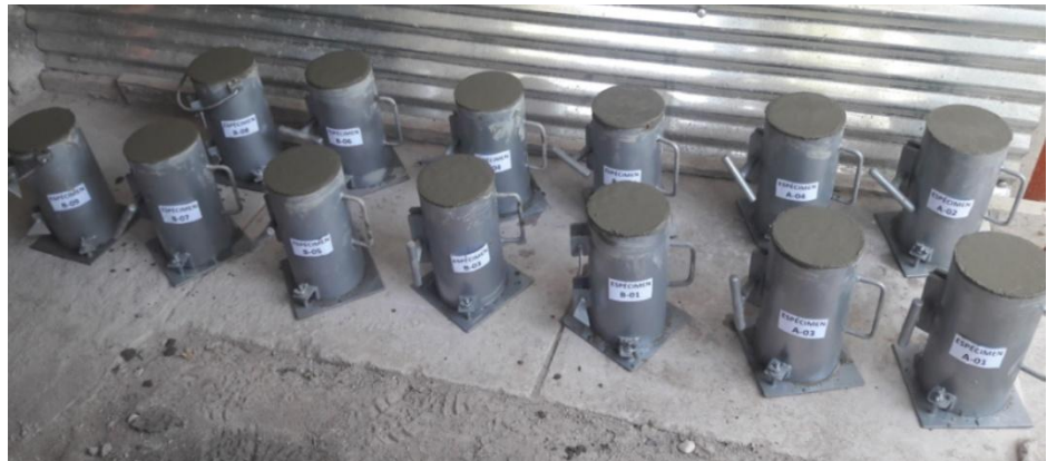
Figura 60 Nueve (09) Especímenes para curado estándar de una misma relación agua-cemento Y cuatro (04) Especímenes para curado Acelerado, todos realizadas de la misma tanda
