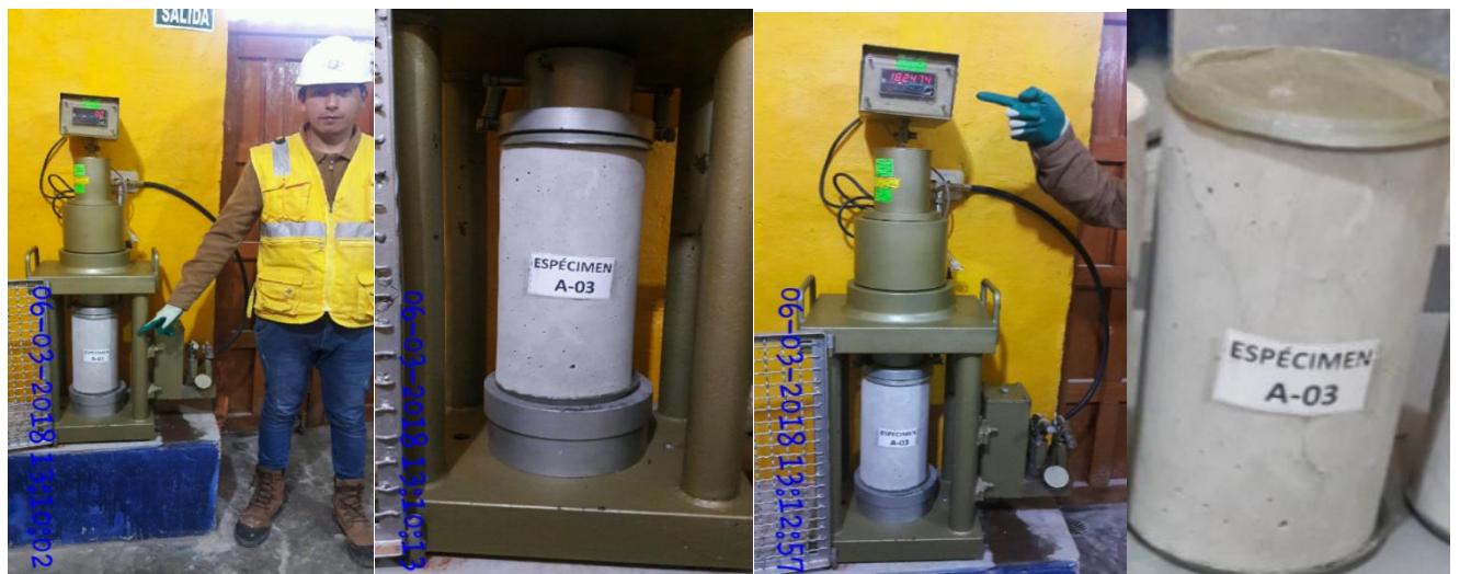
Figura 80 Resistencia espécimen A-3.
