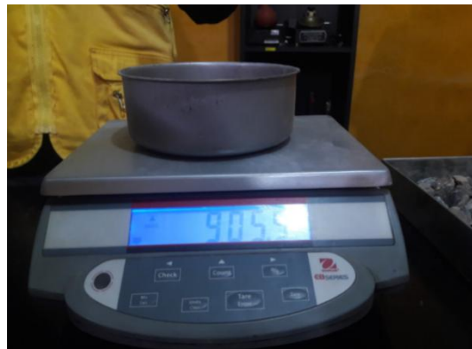
Figura 27 Peso agregado Grueso de la muestra +Tara (g) = 9055g.
