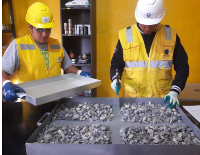
Figura 29 Cuarteo del agregado Grueso para análisis granulométrico.
