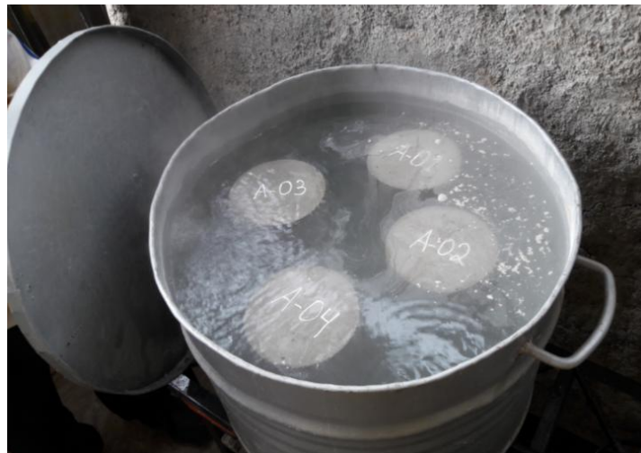
Figura 67 Evaporización durante el ensayo de agua Hirviendo de especímenes
