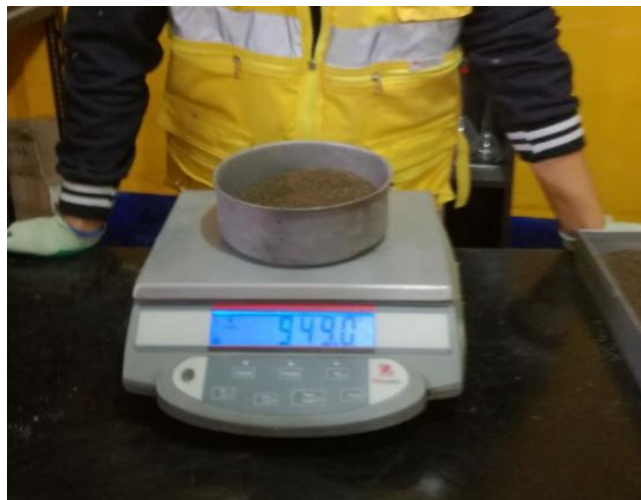
Figura 28 Peso agregado Grueso de la muestra +Tara (g) = 949 g
