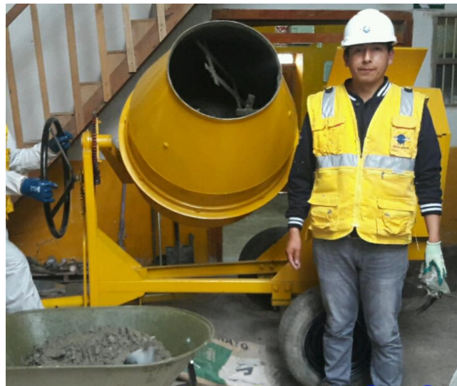
Figura 114 Mezcladora de 11hp en el laboratorio previo a realizar una determinada relación agua-cemento
