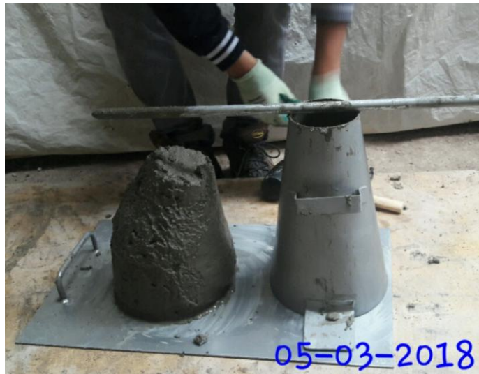
Figura 112 Medición de SLUMP.
