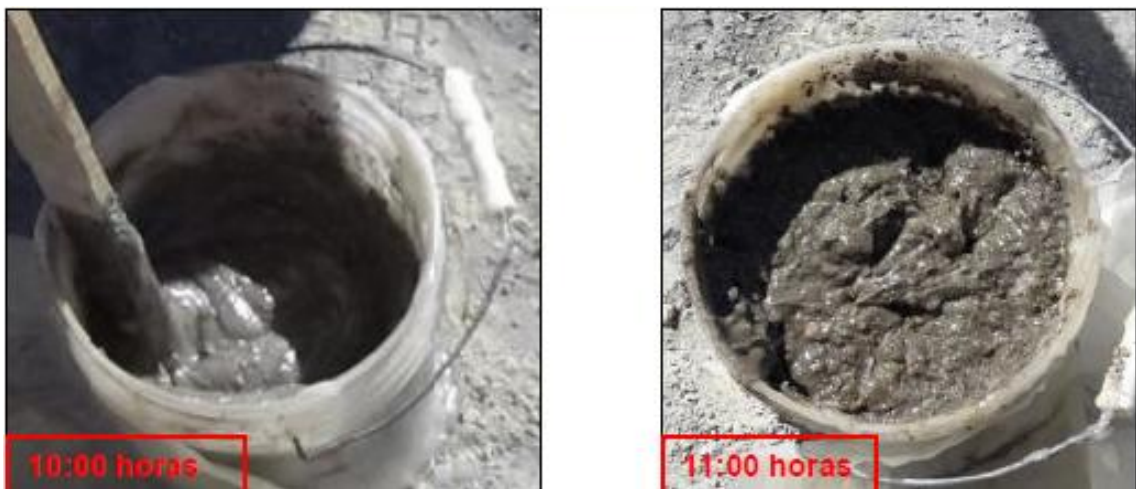
Figura 9. Monitoreo de reacción (color y gases) temperatura.
