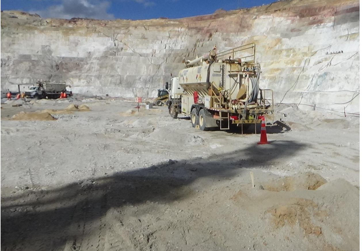
Figura 45. Iniciación de carguío de malla
