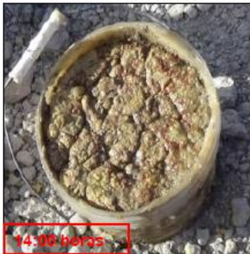
Figura 11. Monitoreo de reacción (color y gases) temperatura al día siguiente (9.a.m.). La apariencia se mantuvo y la T° fue la del ambiente.
