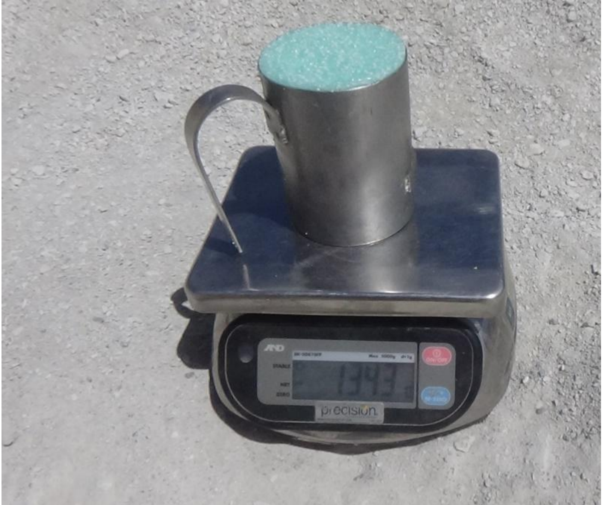
Figura 30. Toma de densidades explosivo 80/20. Densidad 1.10
