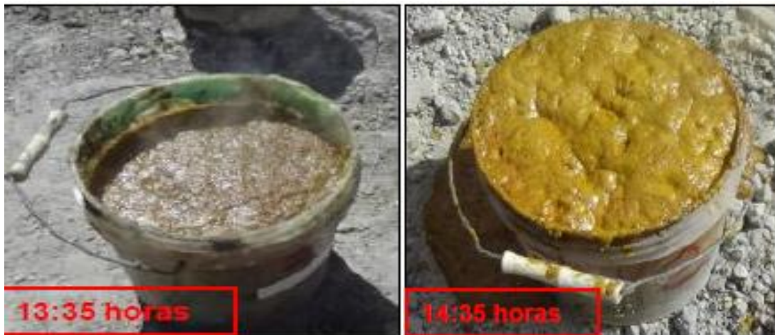
Figura 14. Mezcla cutting con emulsión y observación cada hora
