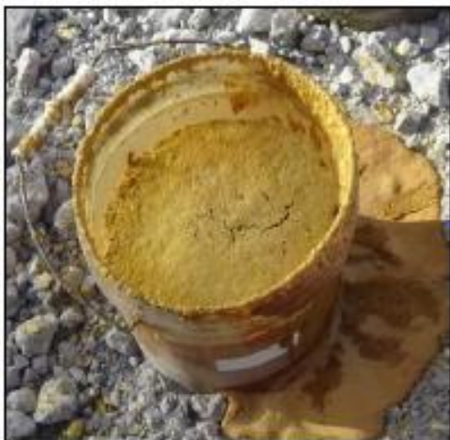
Figura 14. Mezcla cutting con emulsión y observación cada hora
