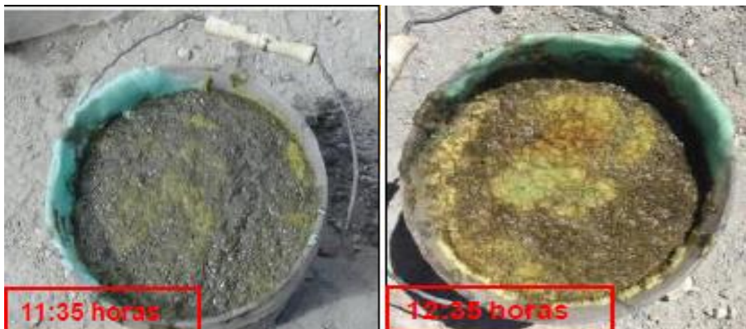
Figura 12. Mezcla cutting con emulsión y observación cada hora
