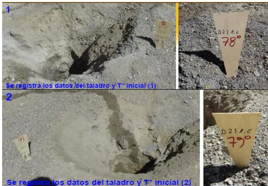
Figura 5. Imagen de temperatura de taladros
