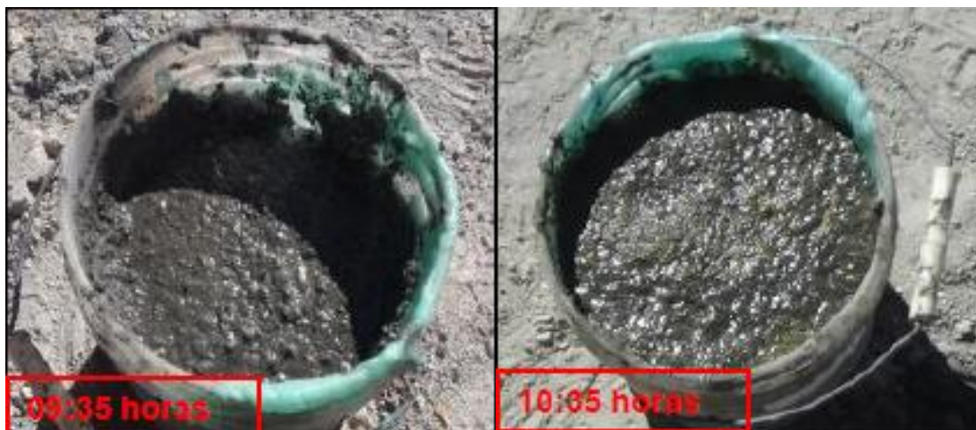
Figura 12. Mezcla cutting con emulsión y observación cada hora
