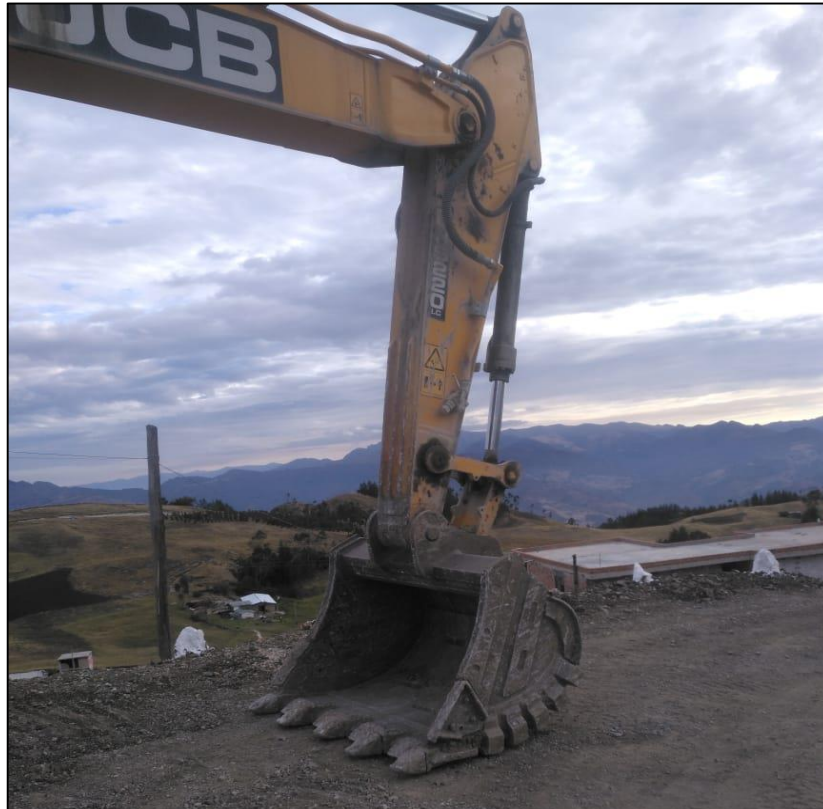
Figura 9. Cucharón de la excavadora. Fuente: Elaboración propia, (2018).
