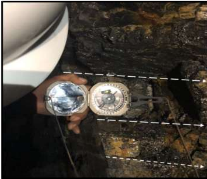
Figura 6. Toma de datos de la inclinación del manto.
