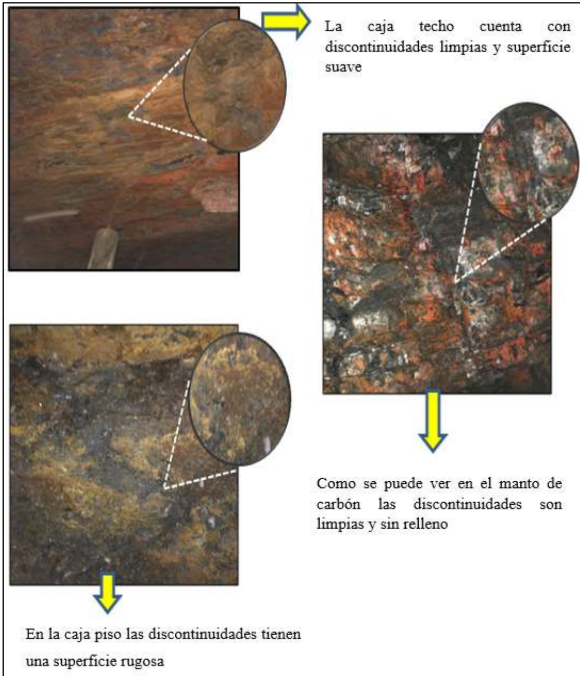
Figura 8. Evaluación de la resistencia de las discontinuidades en las estructuras rocosas.
