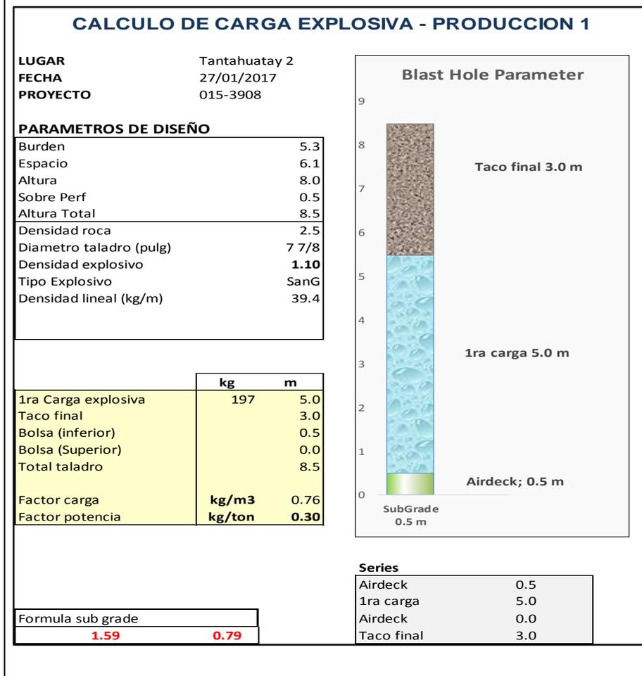
Figura 30. Hoja de Diseño de Carga sin Airdeck- Py. 015-3908.
