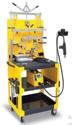
Figura n°28: Gysliner – Carrito de reparación de carrocería de acero
