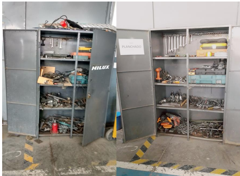
Figura n°49: Antes y después luego de aplicar Seiton – Planchado.
