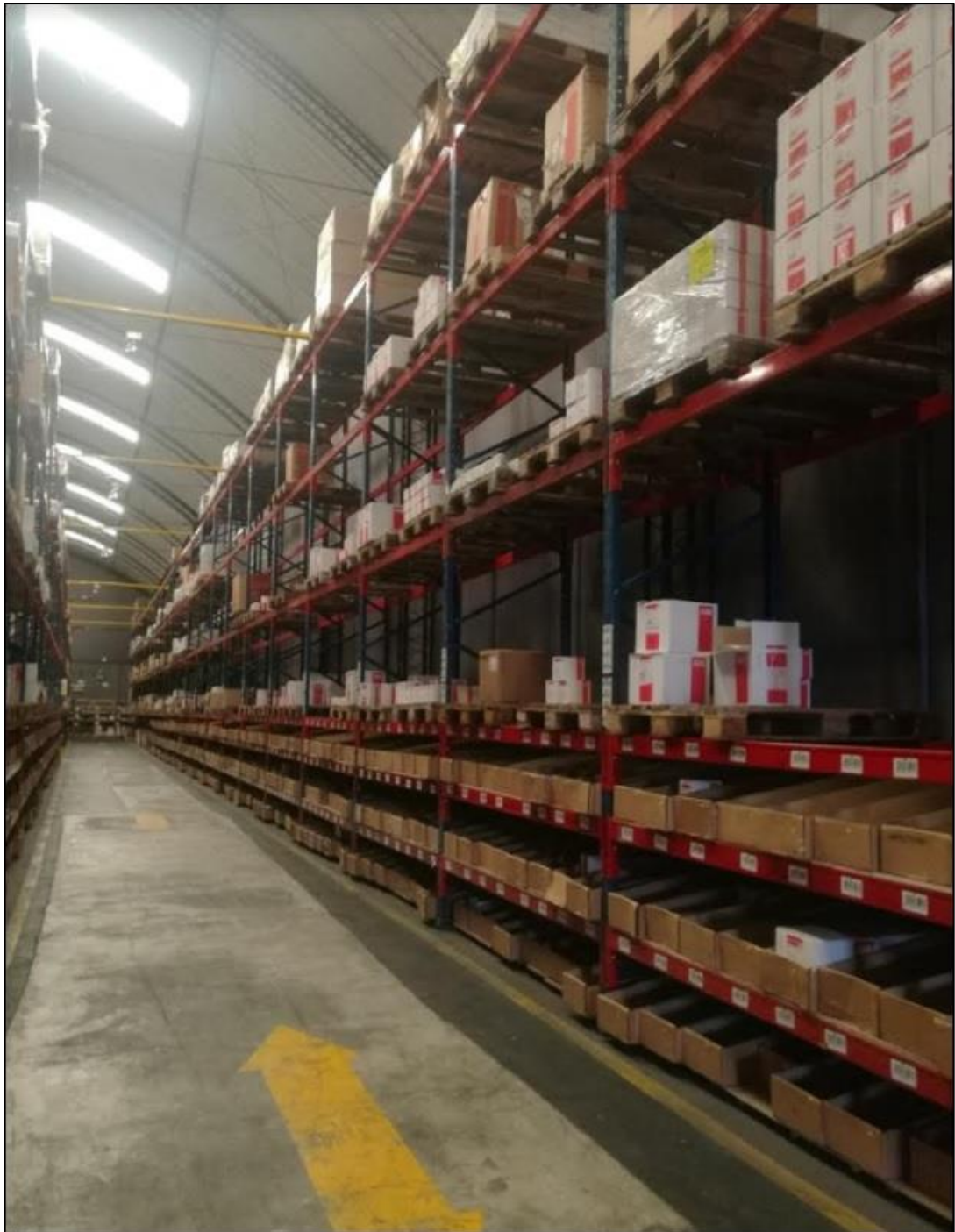
Figura 52 Rack estructural Fuente: Almacén modelo
