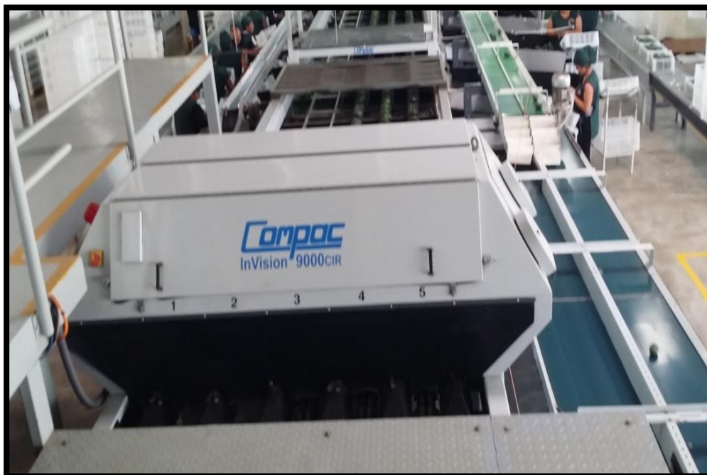
Imagen 21. El escáner calibrador, contiene cámaras por dentro que clasifican a las paltas por tamaño, color y peso.
