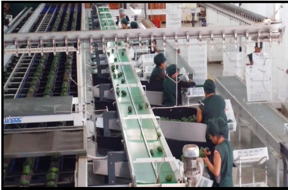
Imagen 22. Las paltas son enviadas a través de la máquina (programada por tamaño, color y peso) hacia el lado derecho. Cada trabajador coloca las paltas, en su mayoría cajas de plástico, según el país asignado.
