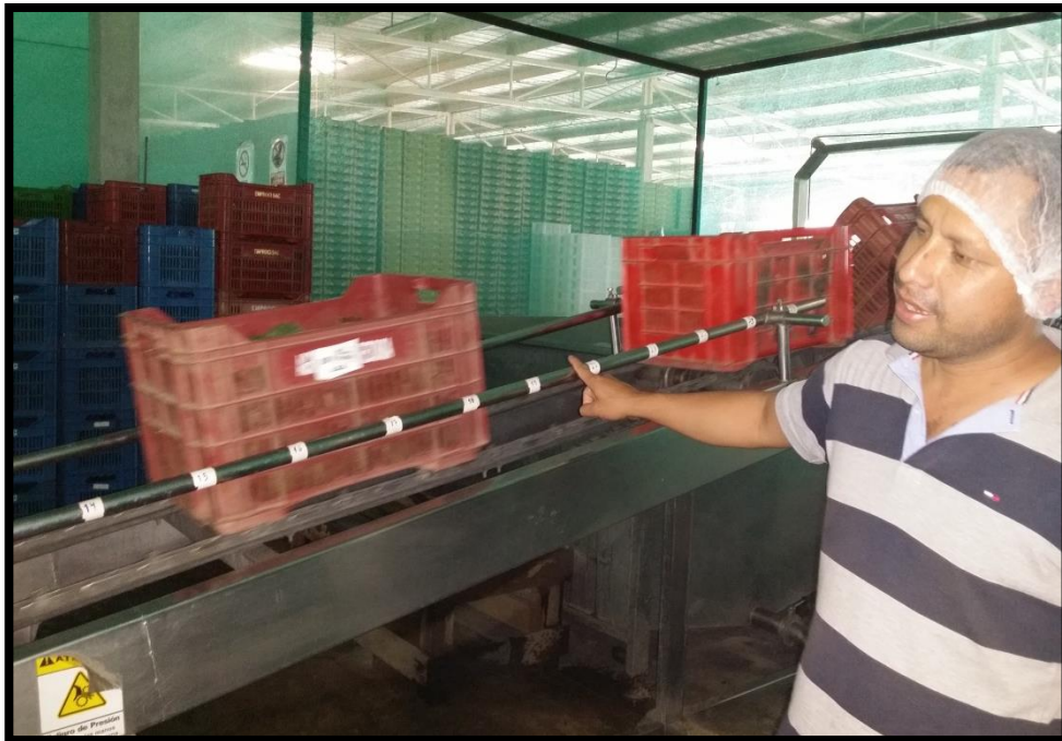
Imagen 11. Colocación de jvas con paltas en la máquina de lavado.
