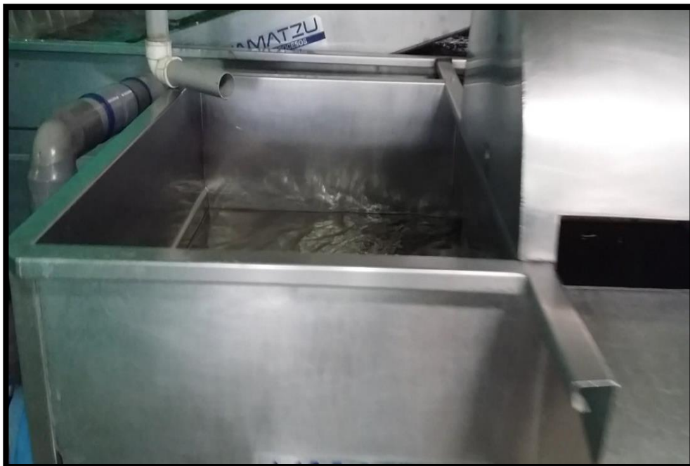
Imagen 13. Proceso de lavado y desinfección con cloro.
