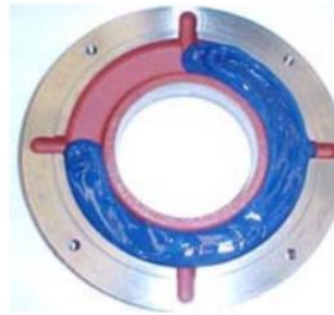
Figura n° 5 Anillo de fijación externo del cojinete
