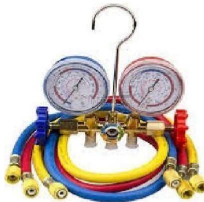
Figura n.º 23. Manómetro de refrigeración
