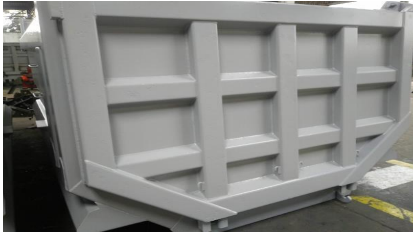
Figura n.º 3.9. Compuerta pintada en base
