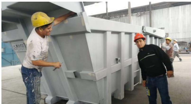
Figura n.º 3.10. Preparación para pintura de acabado
