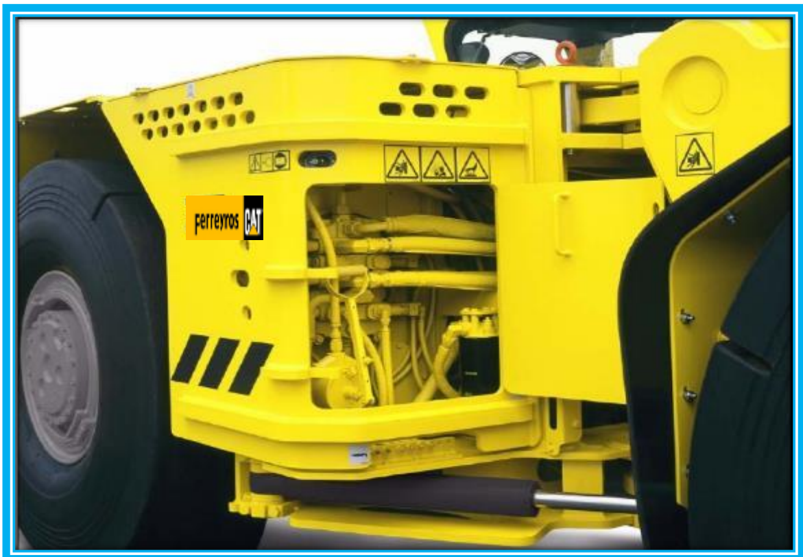
Figura 14: Esquema de una válvula principal del sistema hidráulico del cargador frontal
