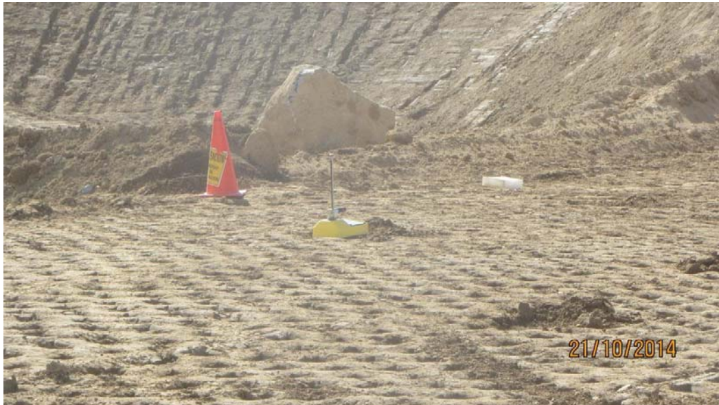
Foto 9: Densidad de Campo, método nuclear, área 8 ciclos de rodillo pata de cabra Panel Test N° 2 – Fecha 21-10-14.
