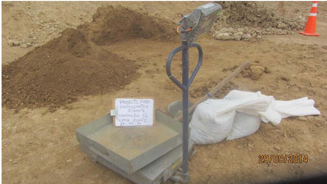
Foto 7: Macro granulometrías de materiales antes de preparar y en compuesto Panel Test N° 1 – Fecha 02-04-14.
