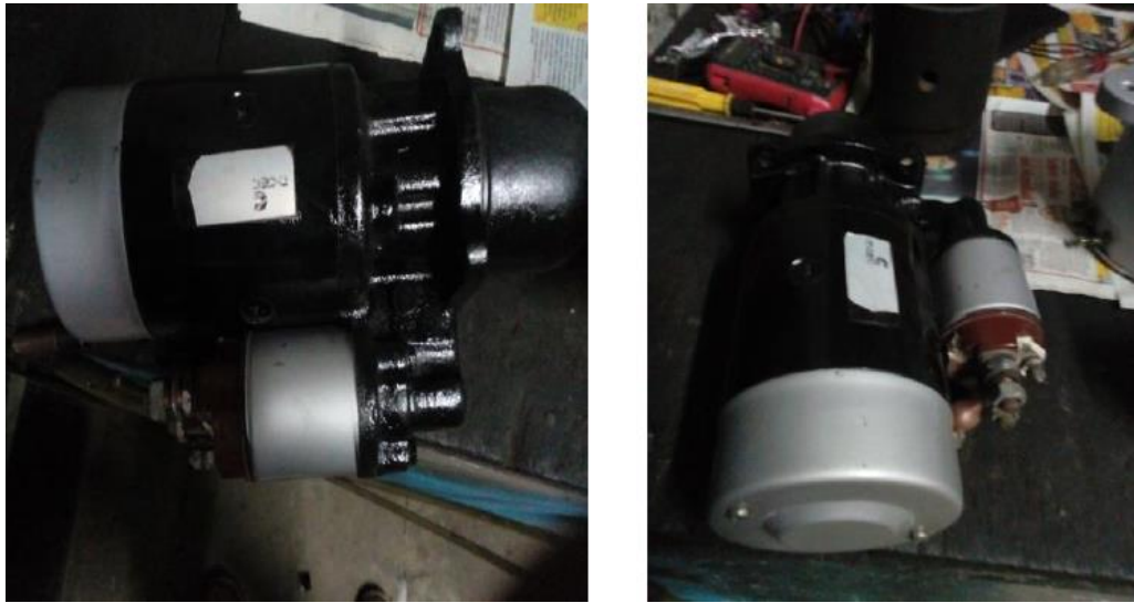
Figura n.º III-13 Arrancador después de su mantenimiento y limpieza Fuente: Informes de mantenimiento de DAT Ingeniería SAC
