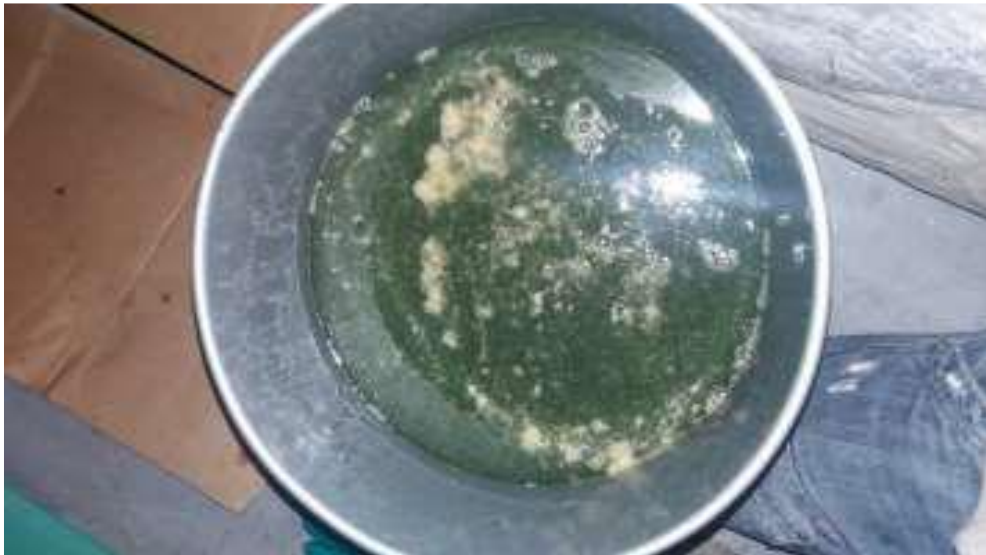
Figura n.º III-22 Refrigerante contaminado Fuente: Informes de mantenimiento de DAT Ingeniería SAC
