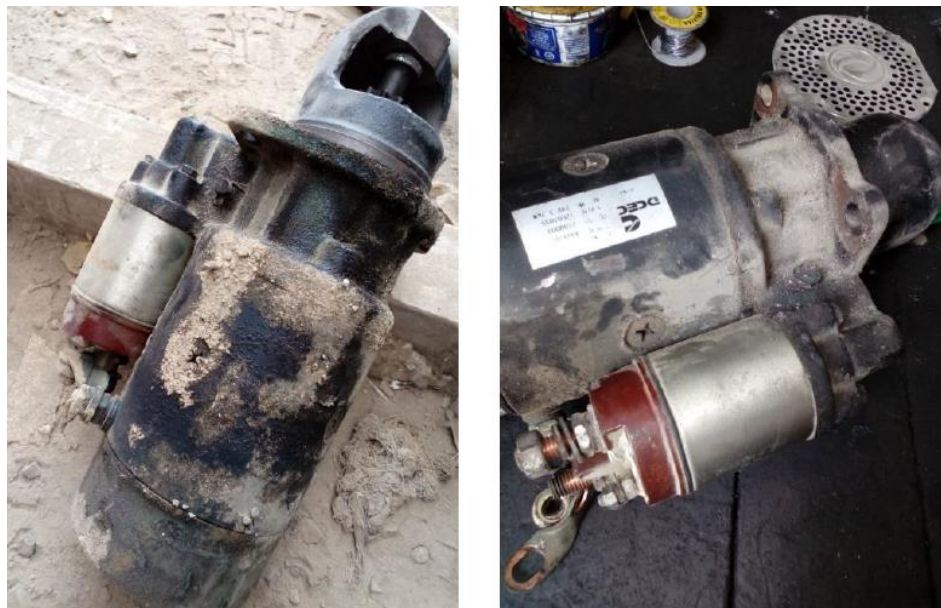
Figura n.º III-12 Arrancador en condiciones severas de trabajo, antes de su mantenimiento Fuente: Informes de mantenimiento de DAT Ingeniería SAC
