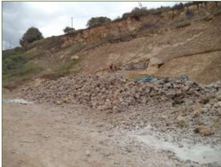
Fotografía Transporte Interno en la cantera roca caliza chancada en cantera. (Chancado primario)
