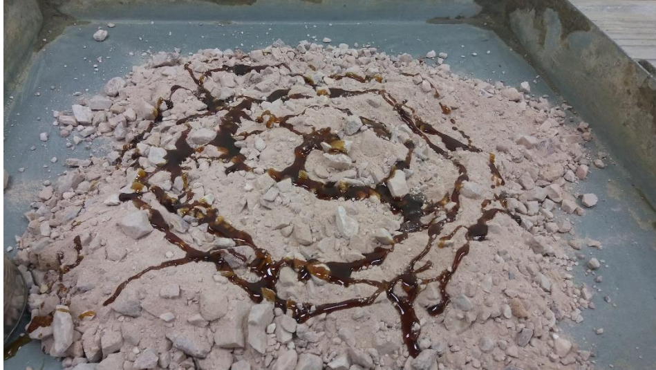
Foto N° 19: Preparación del material para el ensayo de CBR
