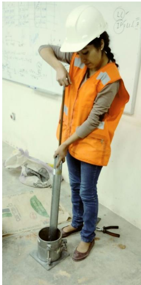
Foto N° 14: Proporcionando golpes con el martillo para compactar la muestra
