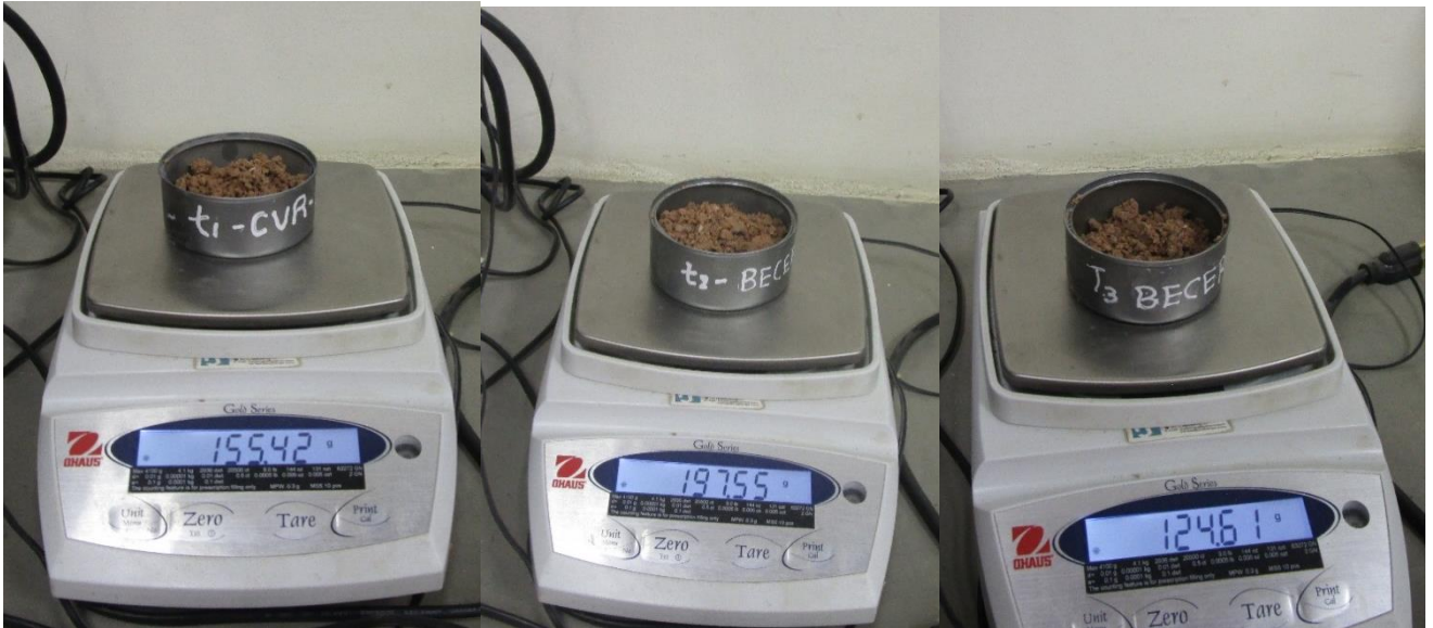
Foto N° 25: Toma de muestra para determinar el contenido de humedad después del ensayo de penetración, CBR.
