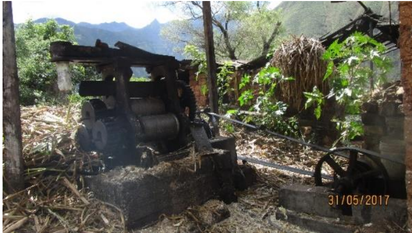
Foto N° 01: Molino donde se muele la caña de azúcar para elaborar la miel.
