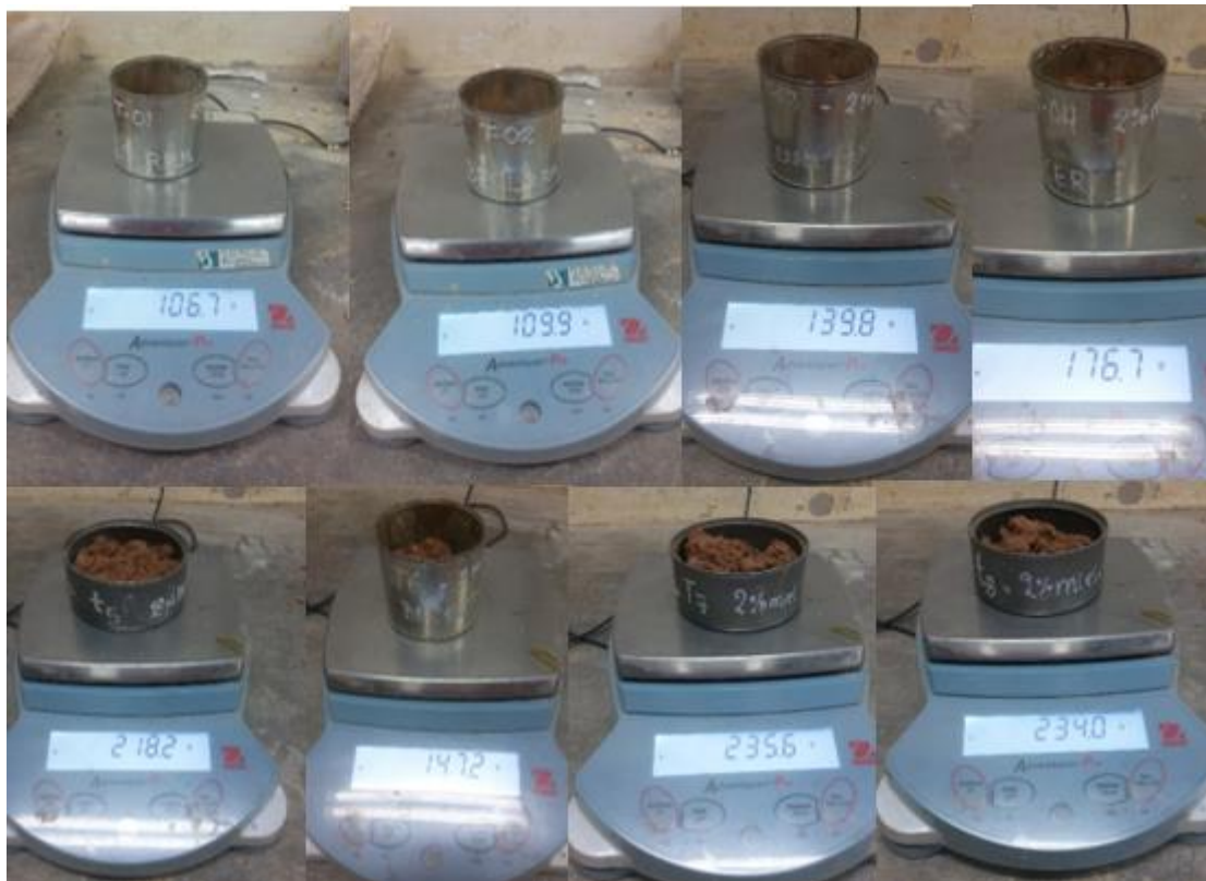
Foto N° 18: Toma de muestra compactada para obtener el contenido de humedad.
