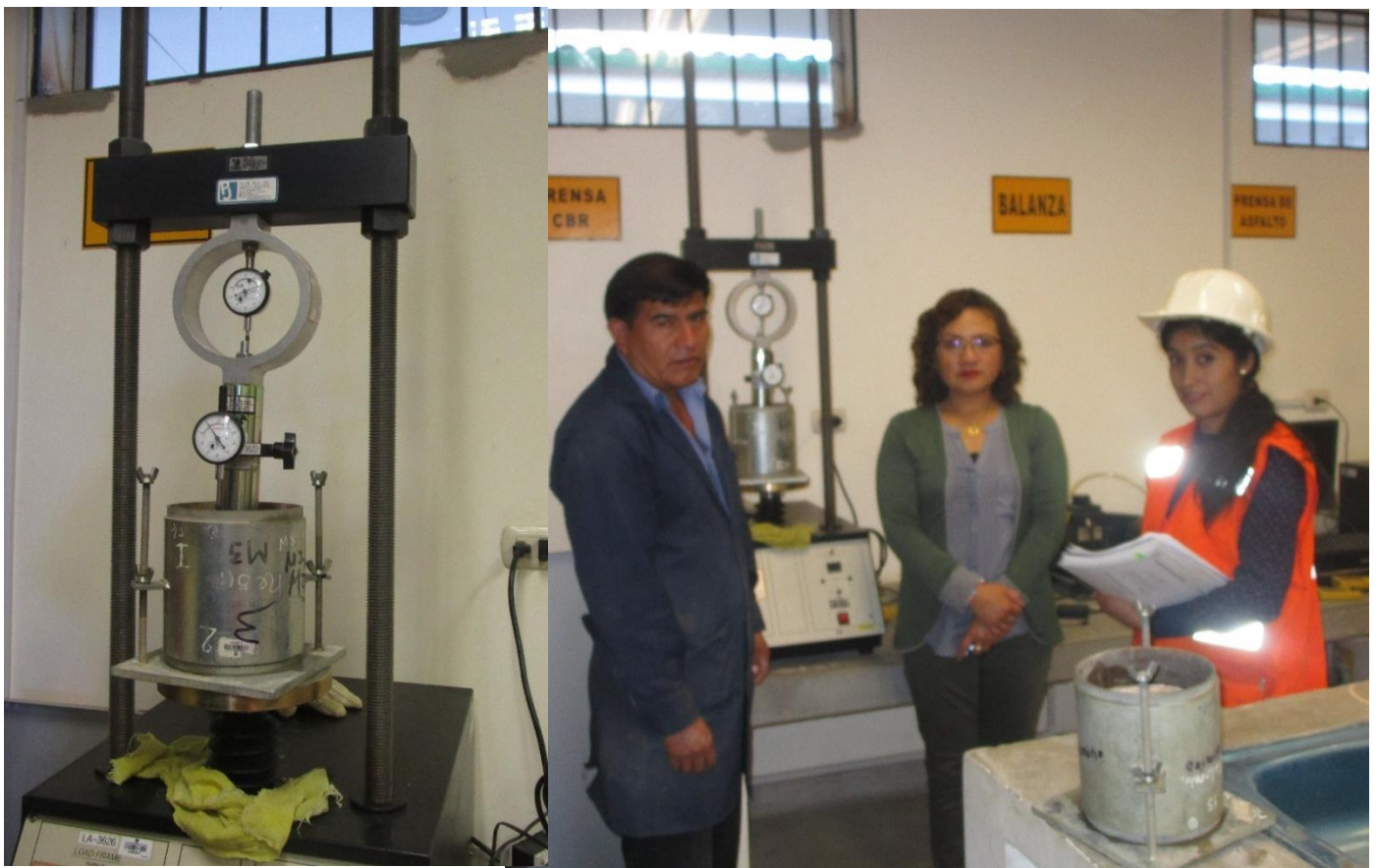
Foto N° 24: Ensayo de penetración para CBR
