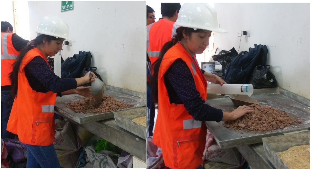
Foto N° 11: Mezclado del material a diferentes contenidos de humedad.
