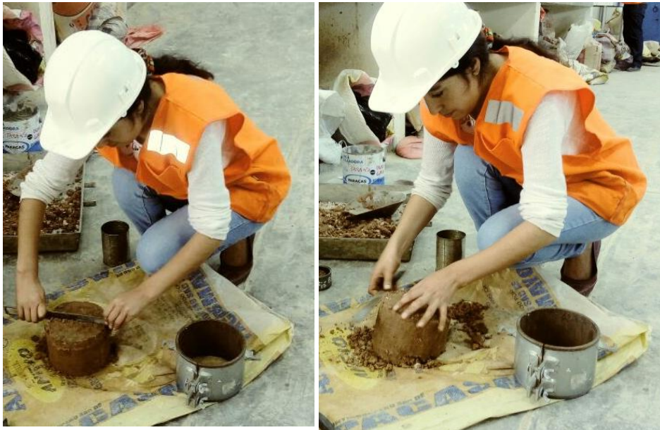
Foto N° 17: Toma de muestra compactada para obtener el contenido de humedad.
