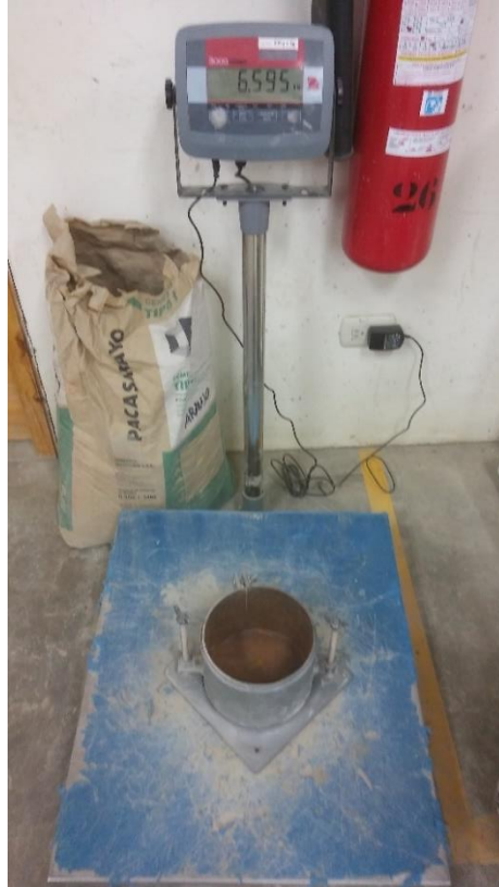
Foto N° 10: Peso del molde para el ensayo Proctor Modificado.
