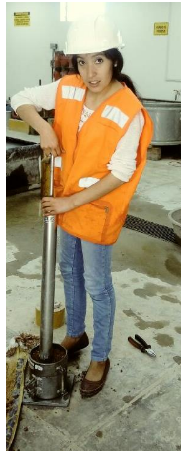
Foto N° 14: Proporcionando golpes con el martillo para compactar la muestra
