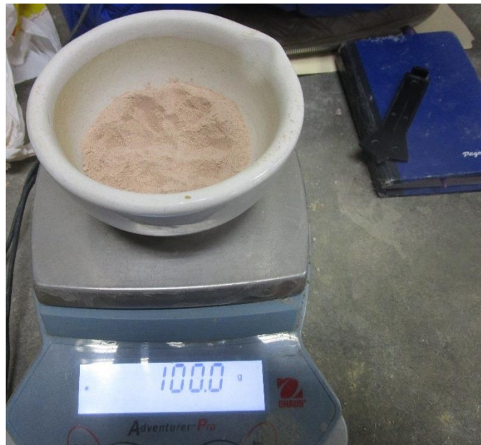
Foto N° 09: Pesando la muestra que pasa la malla N°4 para el ensayo del límite líquido
