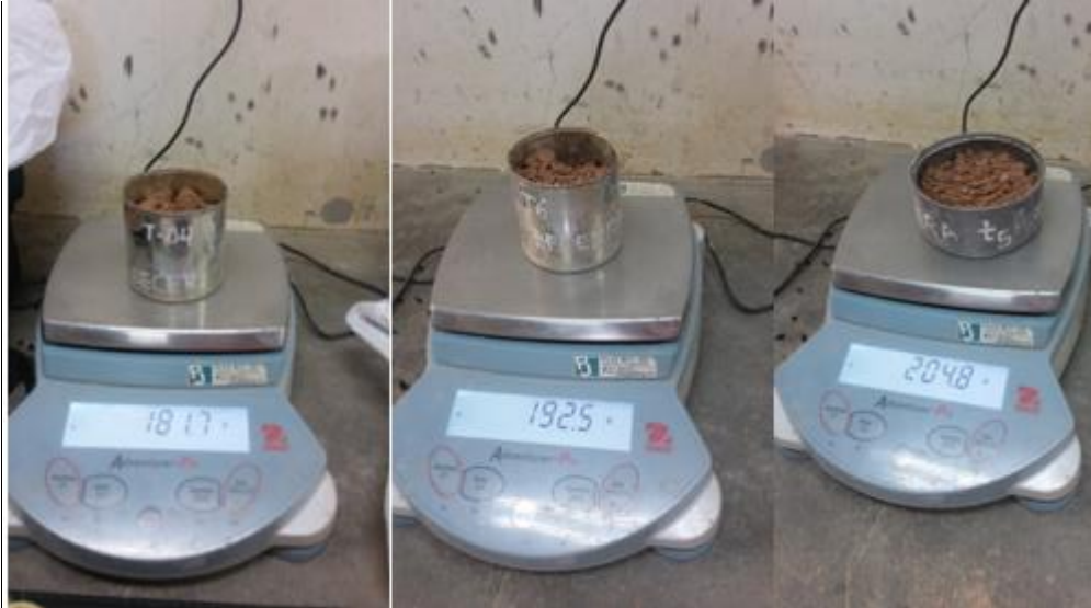
Foto N° 23: Toma de muestra compactada para obtener el contenido de humedad.
