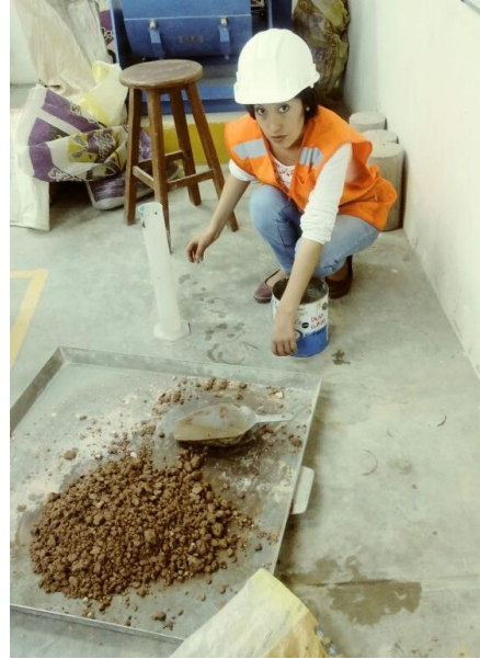
Foto N° 13: Mesclado del material con adición de miel de caña.
