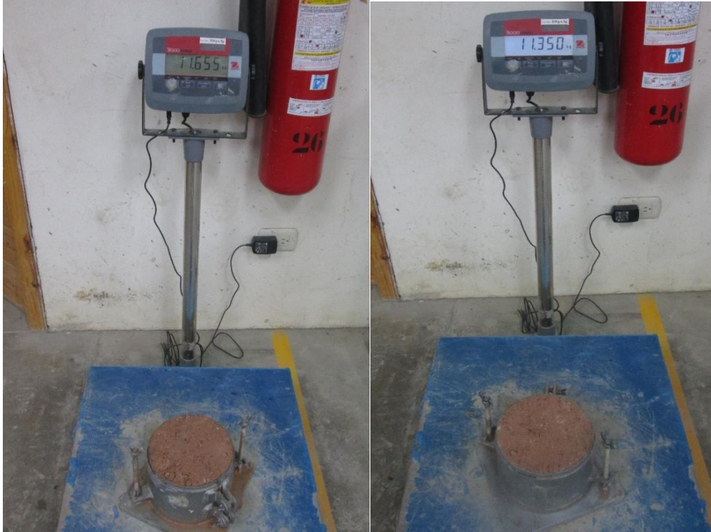
Foto N° 15: Peso de la muestra compactada más molde.
