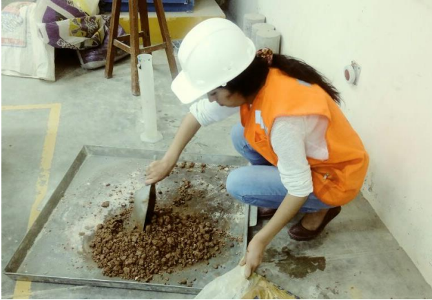
Foto N° 13: Mesclado del material con adición de miel de caña.
