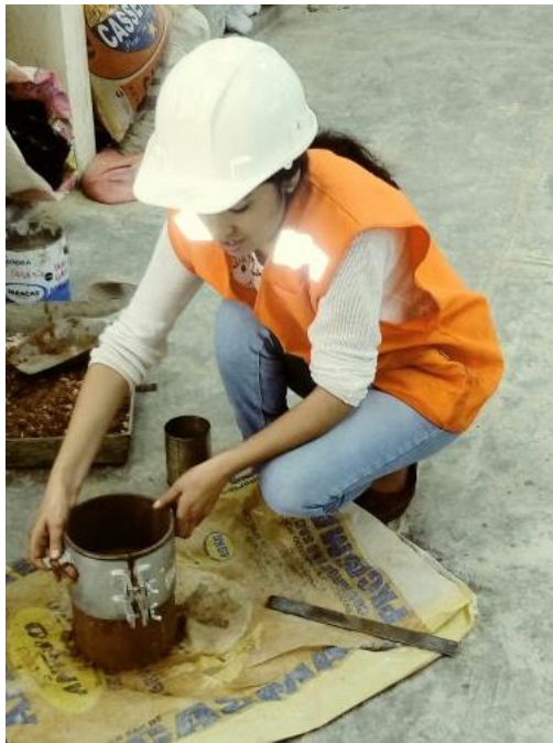
Foto N° 16: Retiro de muestra compactada de molde.
