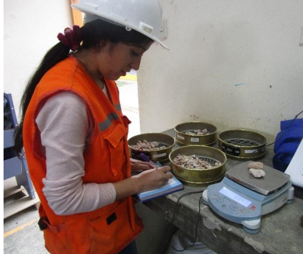
Foto N° 06: Ensayo de granulometría.
