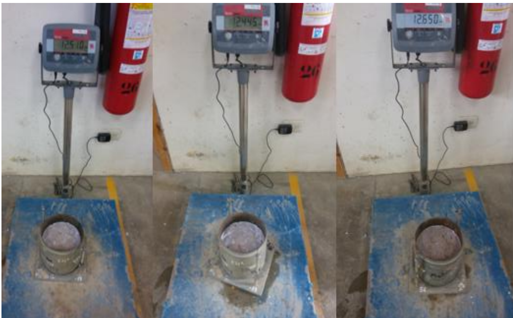
Foto N° 22: Peso de la muestra compactada más molde.
