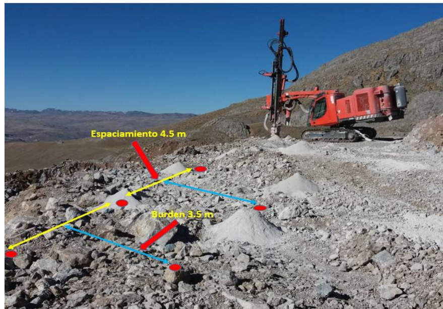
Figura 10 Diseño de espaciamiento y burden según malla
