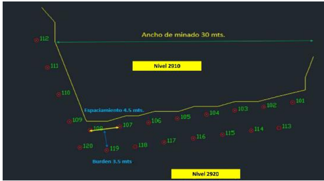
Figura 11 Esquema de la malla de perforación
