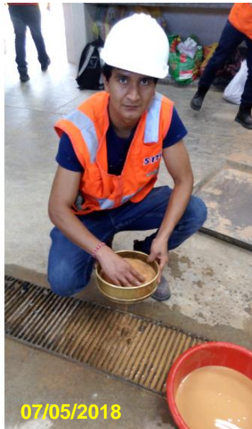
Figura 18 Tamizando la muestra por la malla N° 200 mediante chorro de agua.
