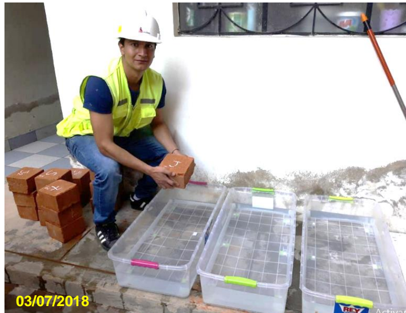
Figura 40 Poner a sumergir el adobe en agua
