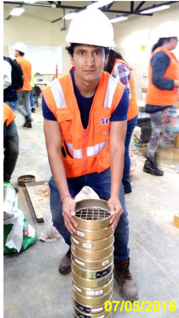
Figura 20 Realizando la granulometría del material lavado después de secarse en el horno.
