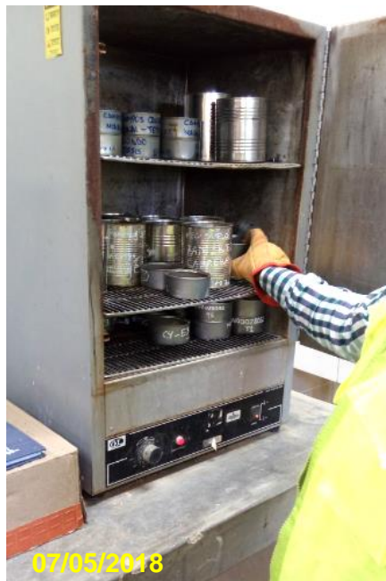
Figura 19 Colocando la muestra que queda en la malla N°200 al horno.
