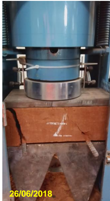
Figura 36 Realizando ensayo de Flexión de diferentes porcentajes
