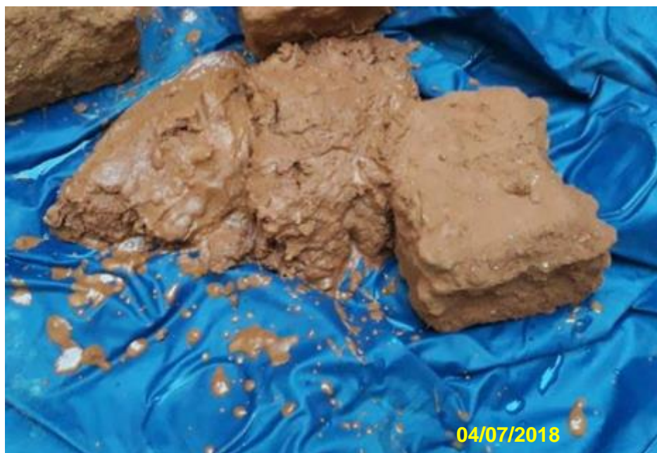
Figura 46 Resto de Adobes sumergido en agua
