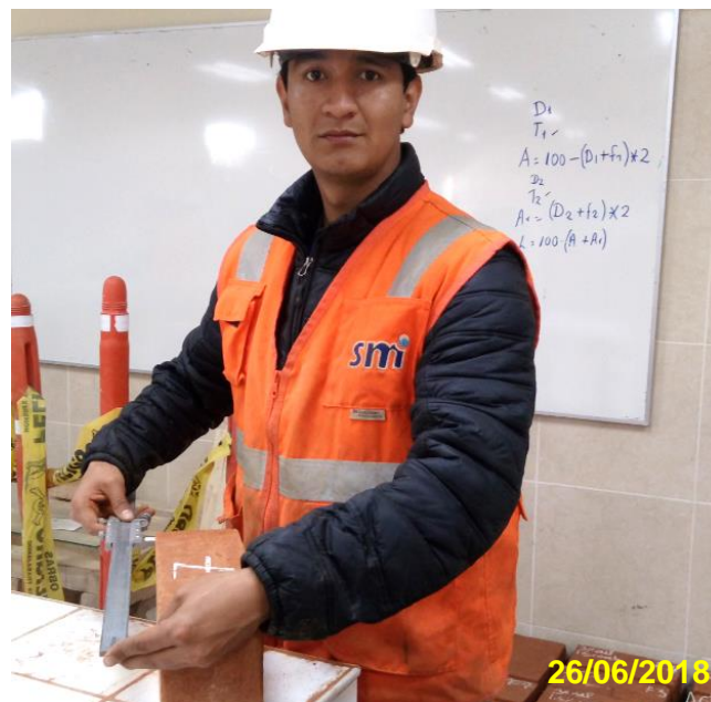
Figura 29 Medición de los Adobes
