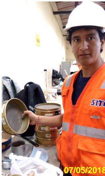
Figura 21 Pesando el material tamizado por las mallas correspondientes.
