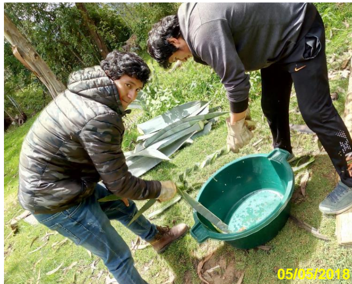
Figura 15 Extracción de Polímero Natural de Penca mediante Torsión
