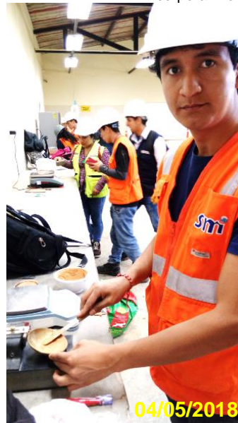
Figura 7 Realizando ensayos de Límites de Consistencia – Límite Líquido.
