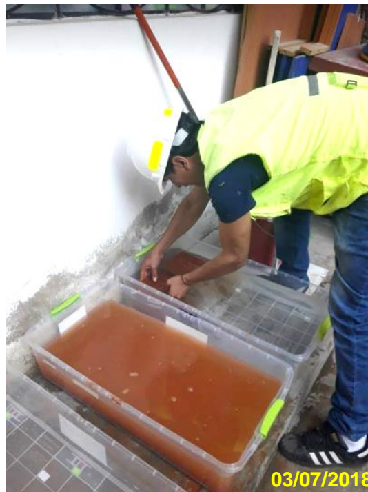
Figura 41 Colocando todos los adobes de diferentes porcentajes en agua
