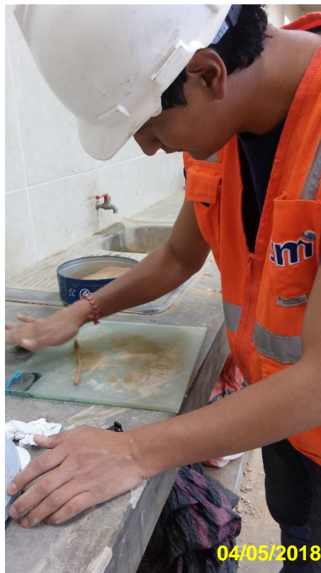
Figura 8 Realizando ensayos de Límites de consistencia – Límite plástico.
