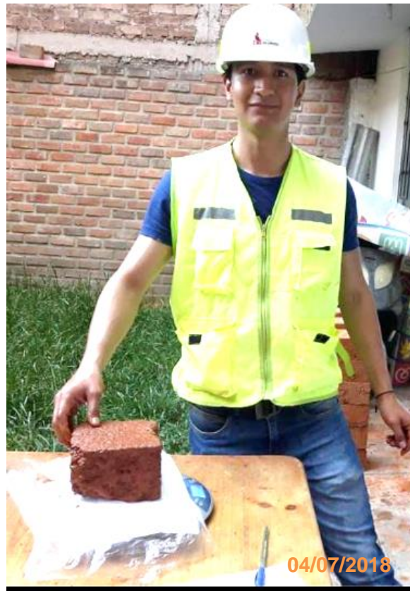
Figura 45 Pesado de Adobes después de haber estado sumergido al agua
