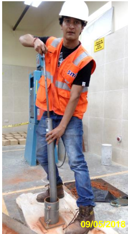
Figura 9 Realizando el ensayo de proctor modificado.
