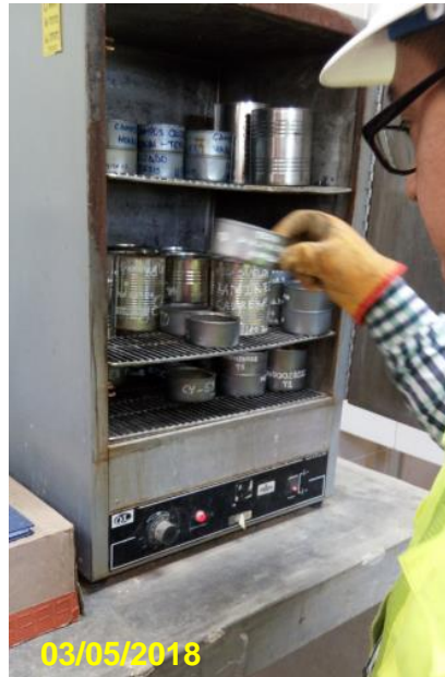
Figura 16 Colocando las taras al horno por el encargo del laboratorio de suelos durante 24 horas a 105°C
