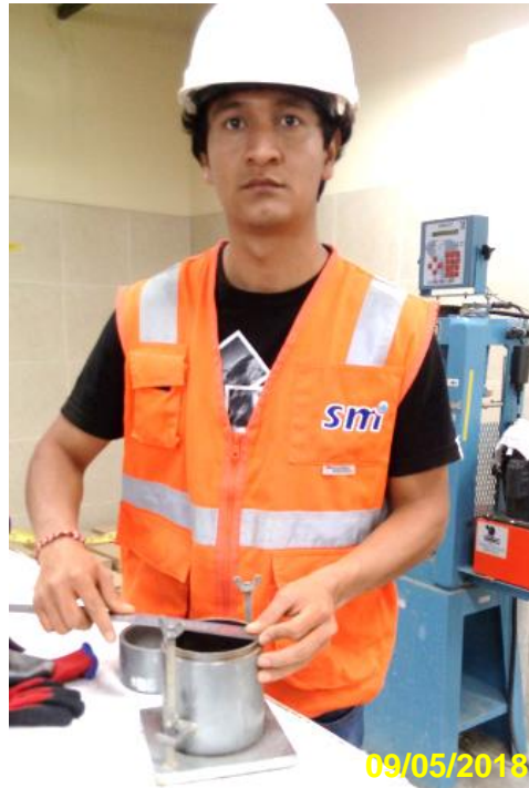
Figura 24 Midiendo el molde para el ensayo de proctor modificado.
