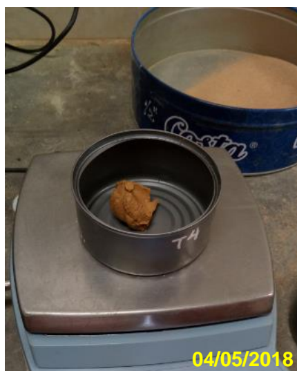
Figura 23 Sacando muestra de la copa de Casagrande en taras.
