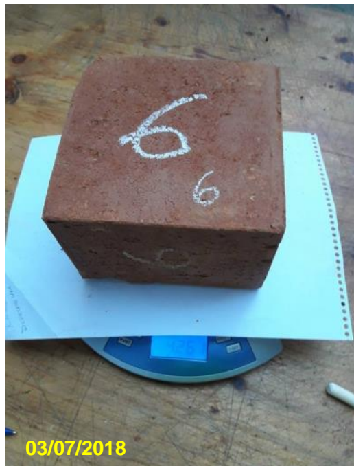
Figura 39 Pesado de los Adobes de Diferentes Porcentajes
