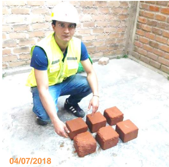
Figura 44 Adobes con incorporación de polímero de Penca
