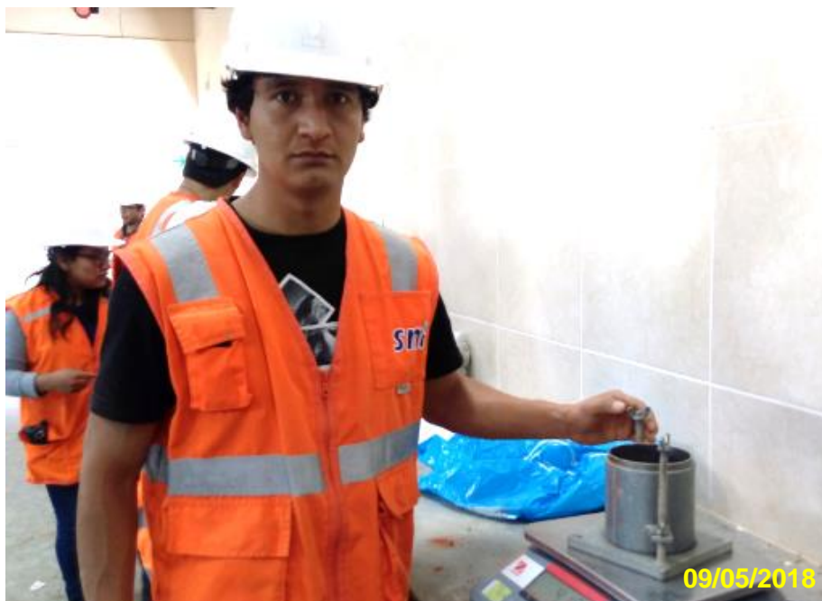
Figura 25 Pesando el molde para el ensayo de proctor modificado.
