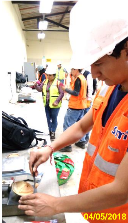
Figura 22 Realizando una ranura con el acanalador de tal manera que la muestra quedo dividida en dos partes.
