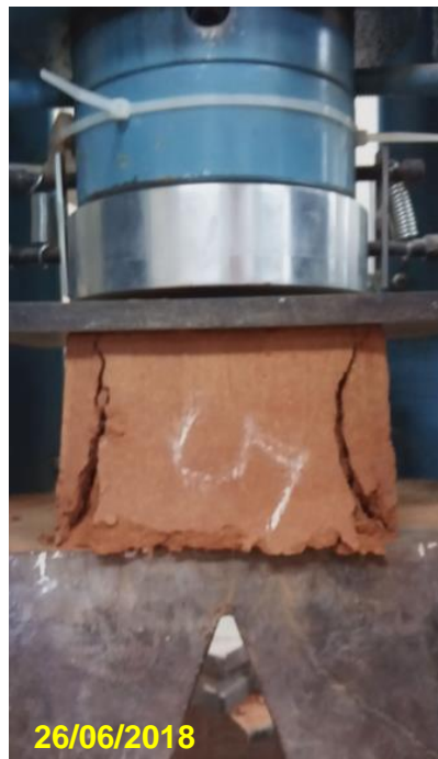
Figura 33 Realizando ensayo de Compresión
