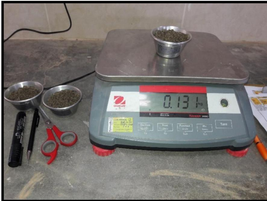
**Figura 3** *Contenido de humedad del agregado*
