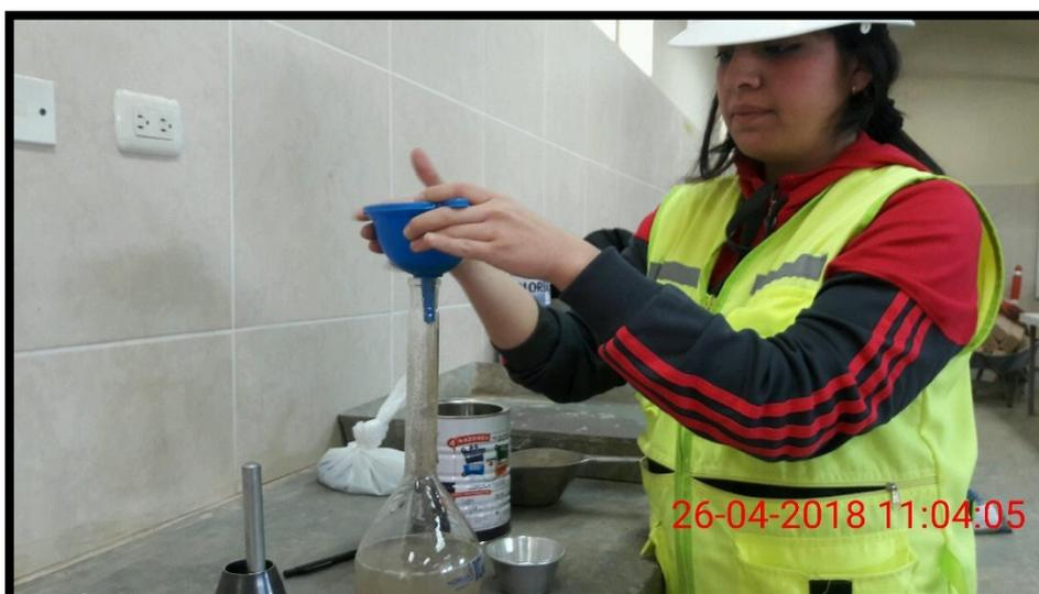
*Fotografía 3* Proceso de estudio de los agregados – peso específico del agregado grueso
