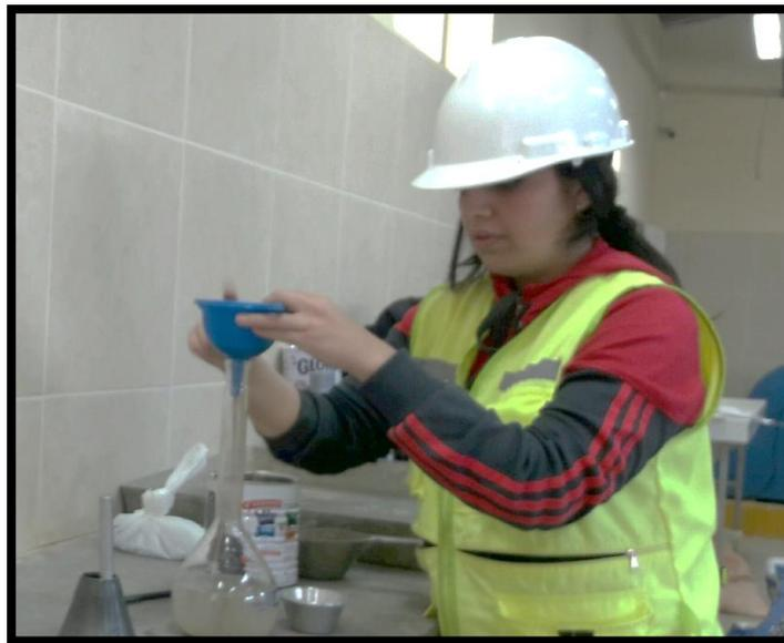
*Figura 6* Peso específico del agregado fino
