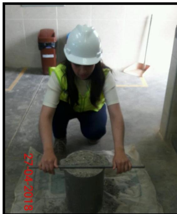
*Fotografía 5* Proceso de estudio de los agregados – peso unitario de agregado grueso
