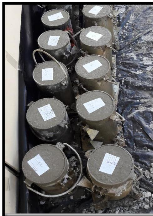
**Figura 11** Probetas de concreto antes de ser desmoldadas
