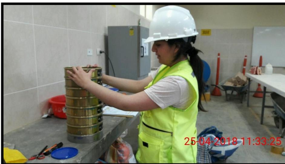
*Fotografía 2* Proceso de estudio de los agregados – peso específico del agregado fino
