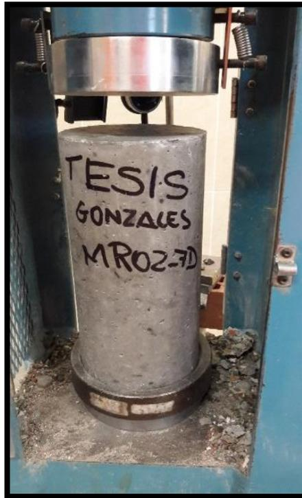
*Figura 12* Ensayo a compresión axial de un espécimen de concreto
