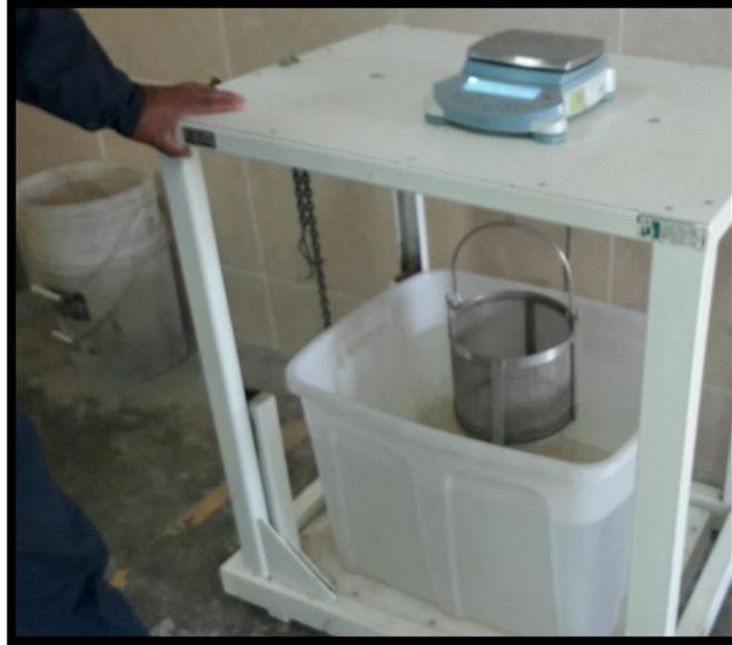
*Figura 5* Peso específico del agregado grueso
