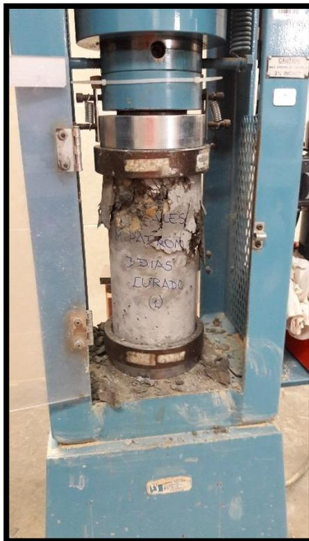
Variación de la resistencia a compresión del concreto  $f'c=210 \text{ kg/cm}^2$  con aditivo acelerante al 2% y retardante al 0.5%, para diferentes edades.
