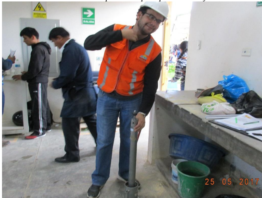
Foto 8: Compactación para proctor modificado
