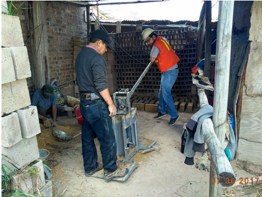
Foto 10: Operación de la máquina CINVA RAM
