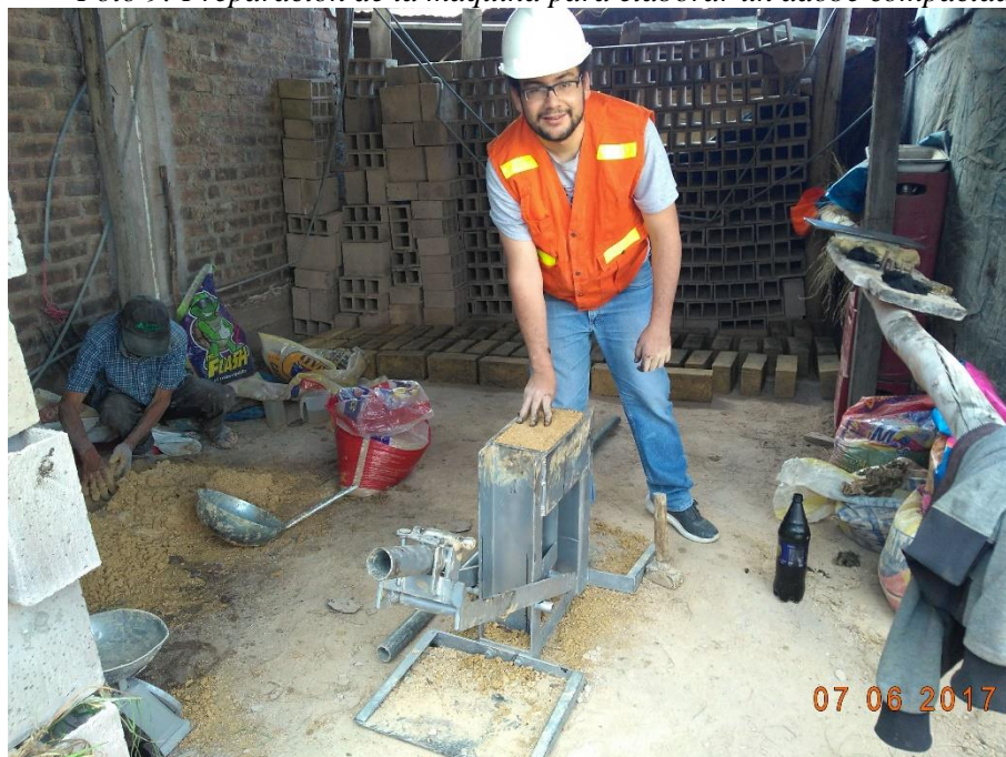
Foto 9: Preparación de la máquina para elaborar un adobe compactado
