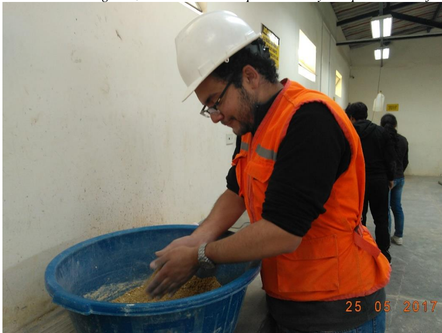
Foto 7: Homogeneización del material para el ensayo de proctor modificado
