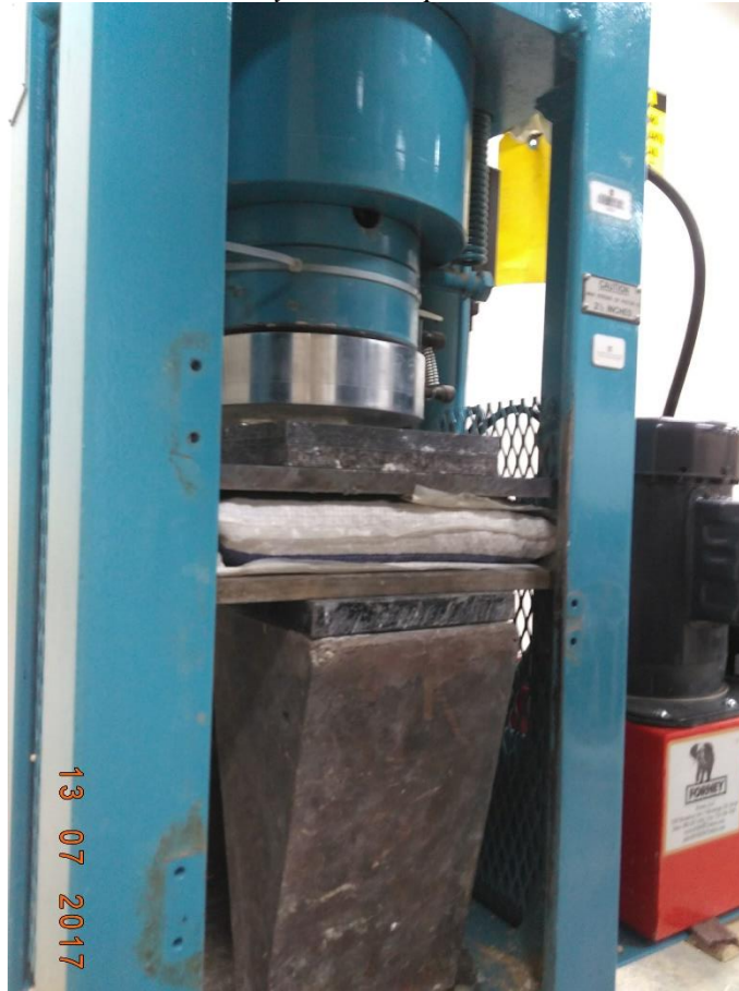
Foto 18: Ensayo de los superadobes
