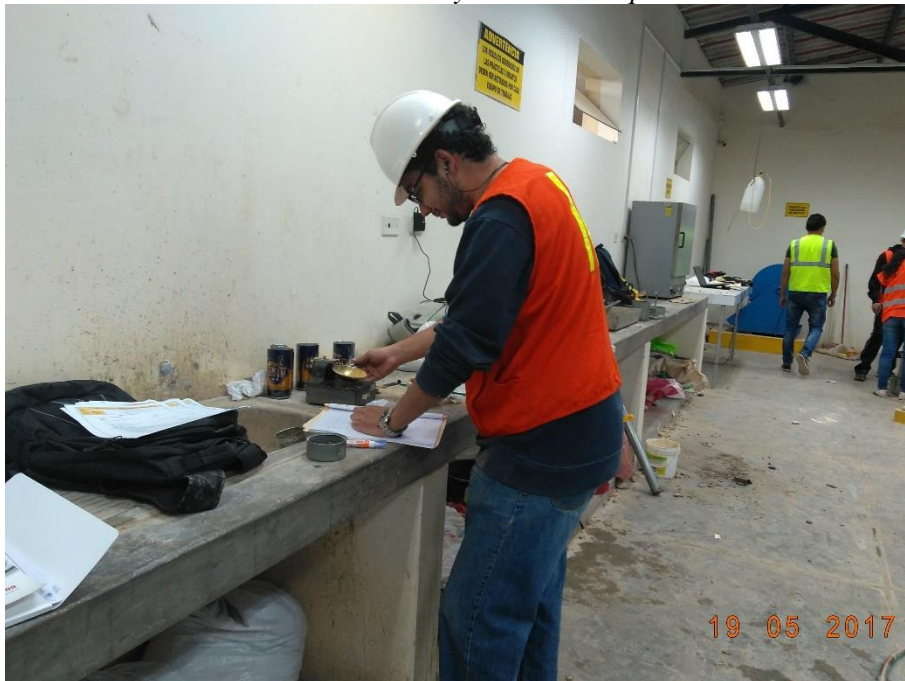
Foto 5: Ensayo del límite líquido
