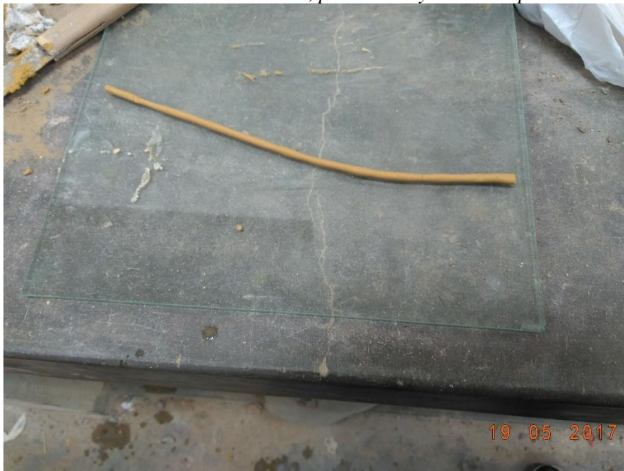
Foto 6: rollo del material, para el ensayo de límite plástico
