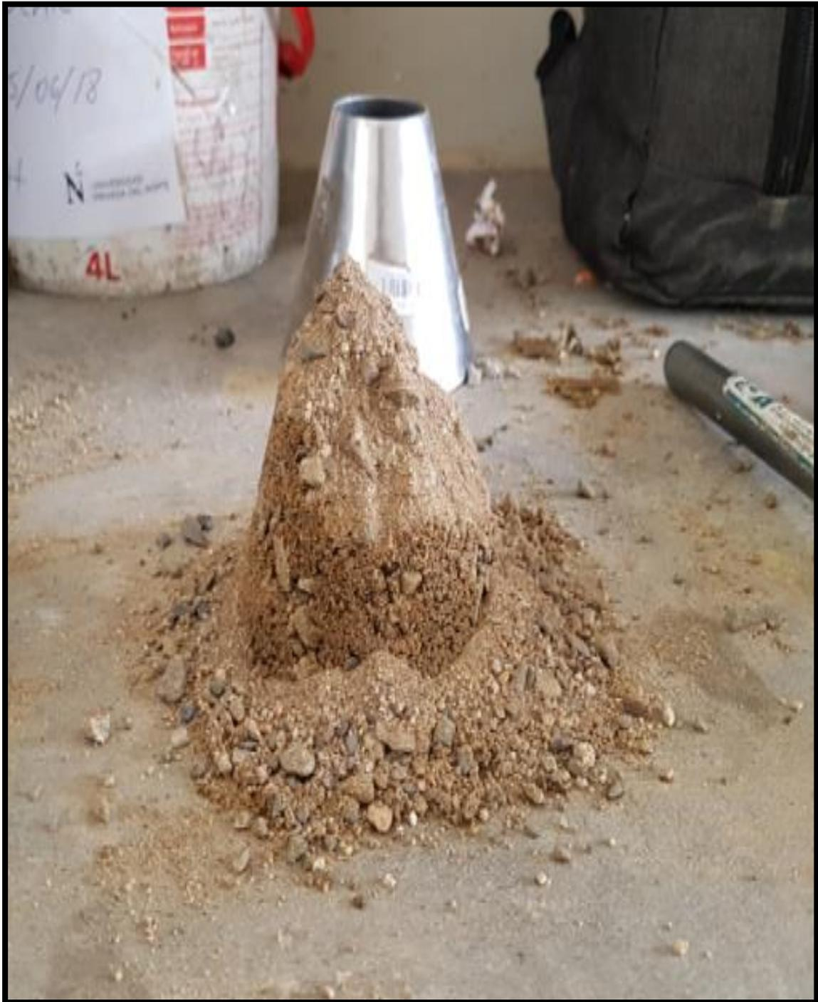
**Figura 15.** *Peso específico del agregado fino - cono.*
