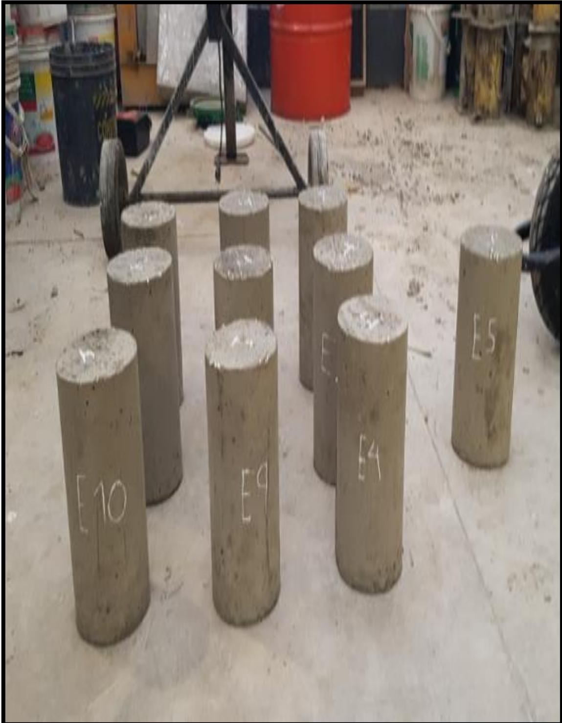
**Figura 22.** *Probetas desencofradas de concreto con perlas de poliestireno.*
