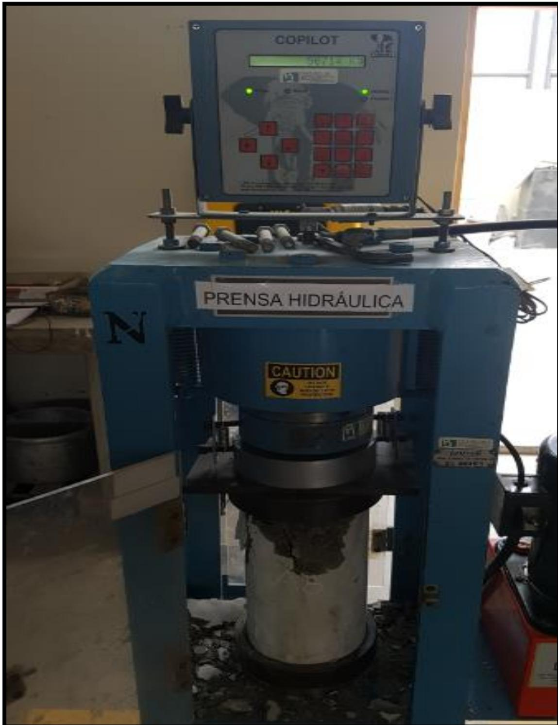
**Figura 23.** Ensayo de resistencia a compresión – concreto convencional.
