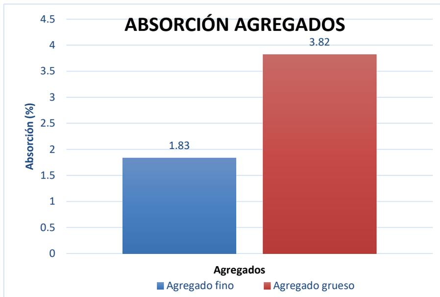
**Figura 10.** Absorción de los agregados (%).
