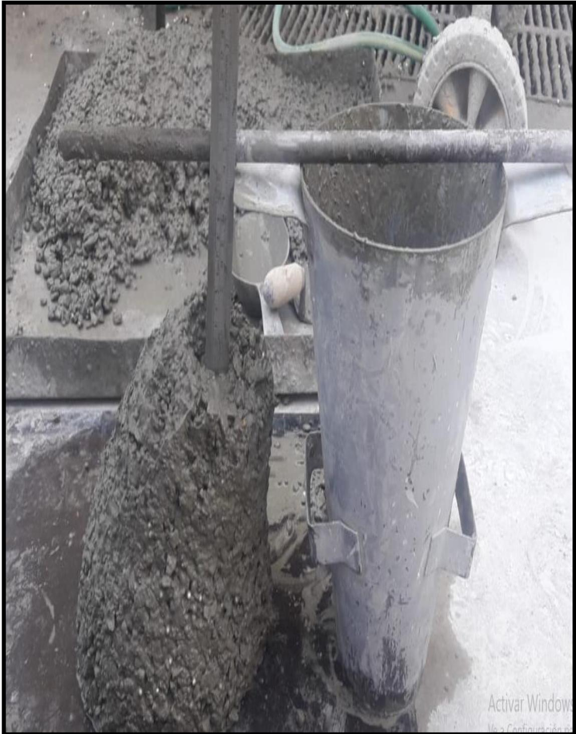
**Figura 20.** Asentamiento del concreto con perlas de poliestireno.
