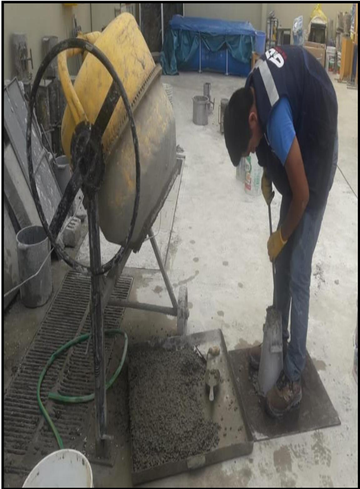
**Figura 18.** Prueba de Cono de Abrams – concreto convencional.
