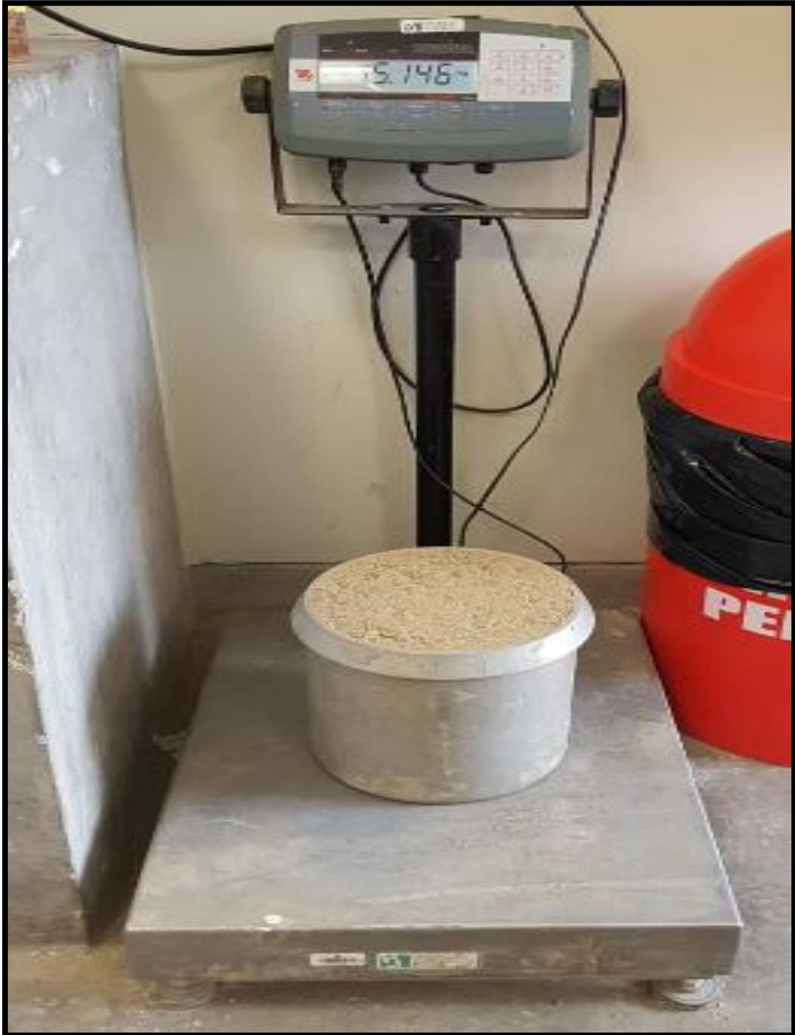
*Figura 13. Peso unitario compactado del agregado fino.*
