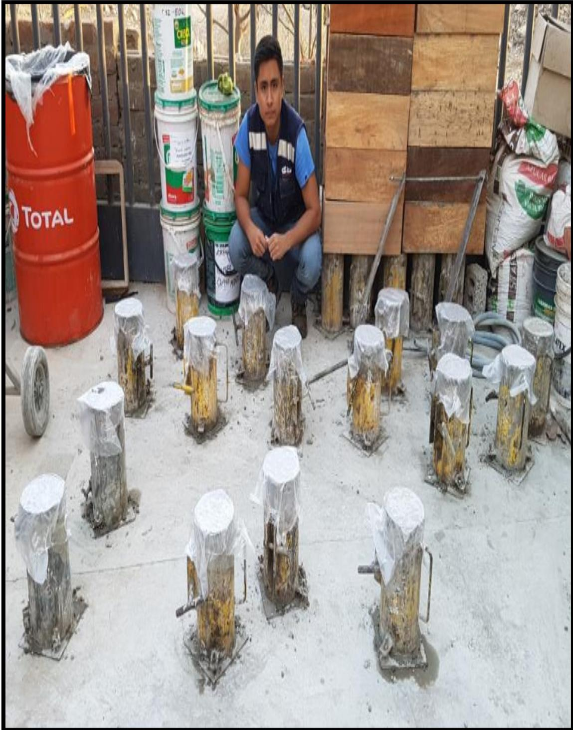
**Figura 26.** *Probetas para desencofrar.*
