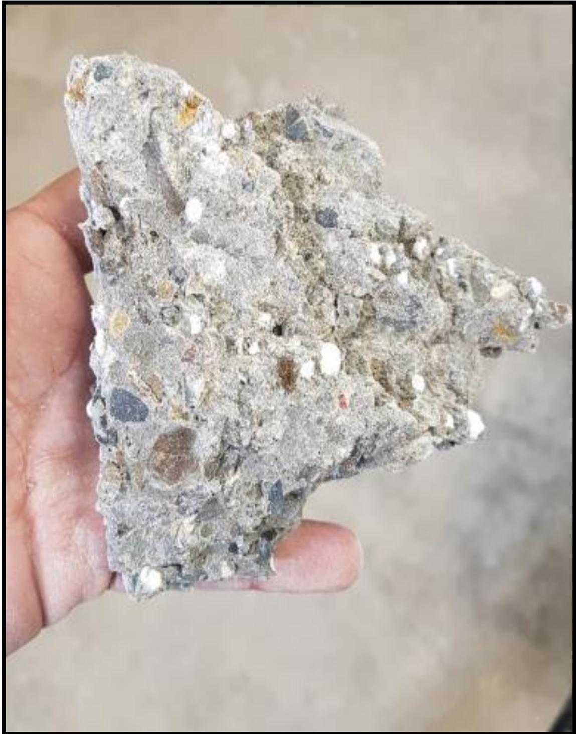
**Figura 21.** Distribución de las perlas de poliestireno en el concreto en estado endurecido.
