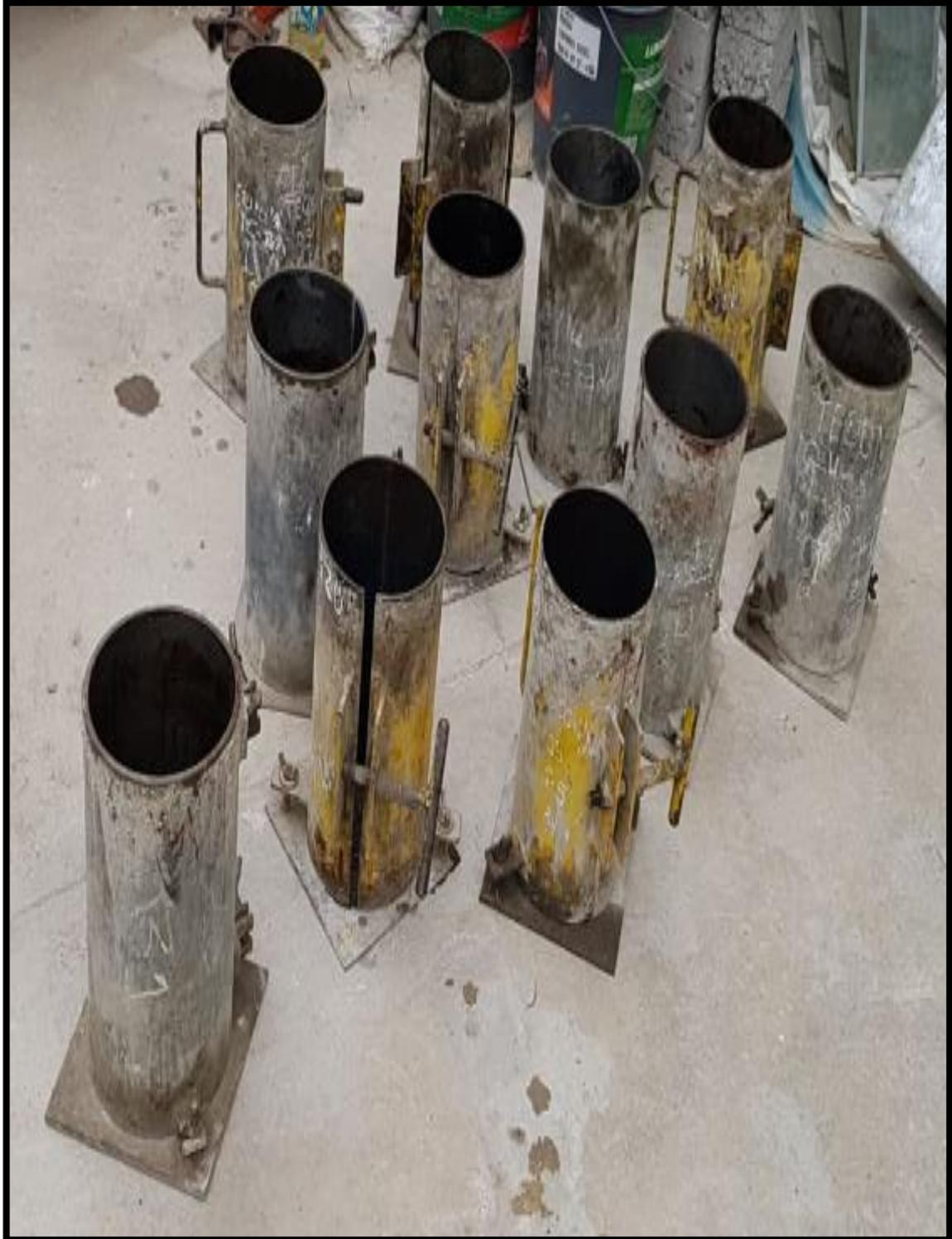
*Figura 24. Moldes para probetas de concreto.*
