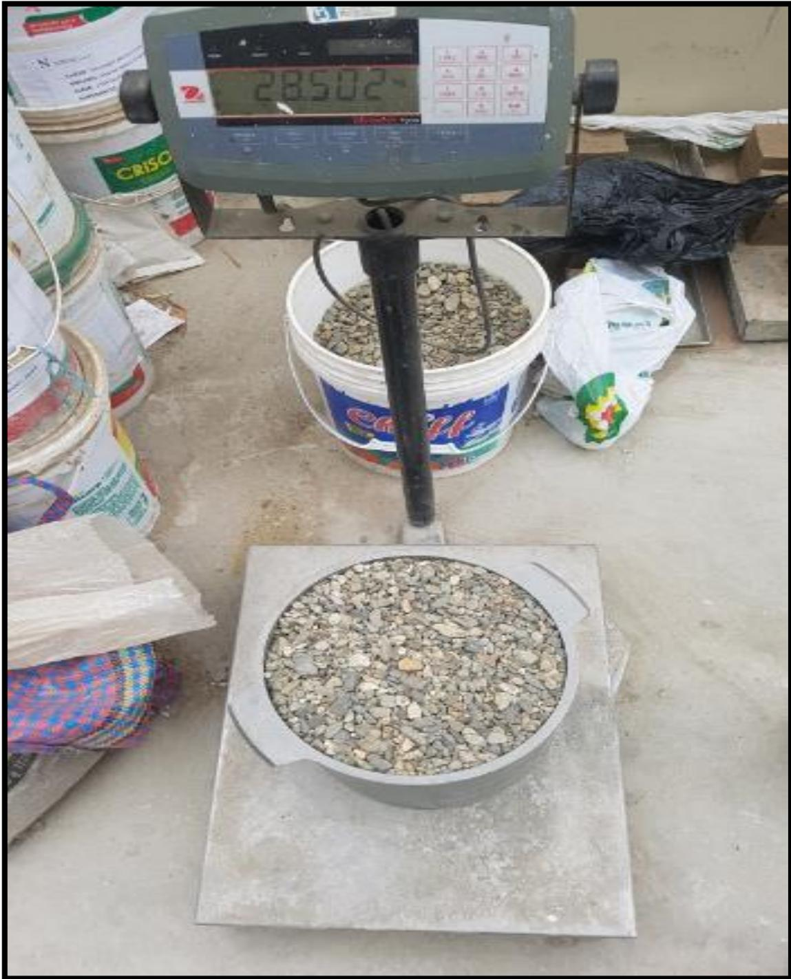
*Figura 14. Peso unitario compactado del agregado grueso.*
