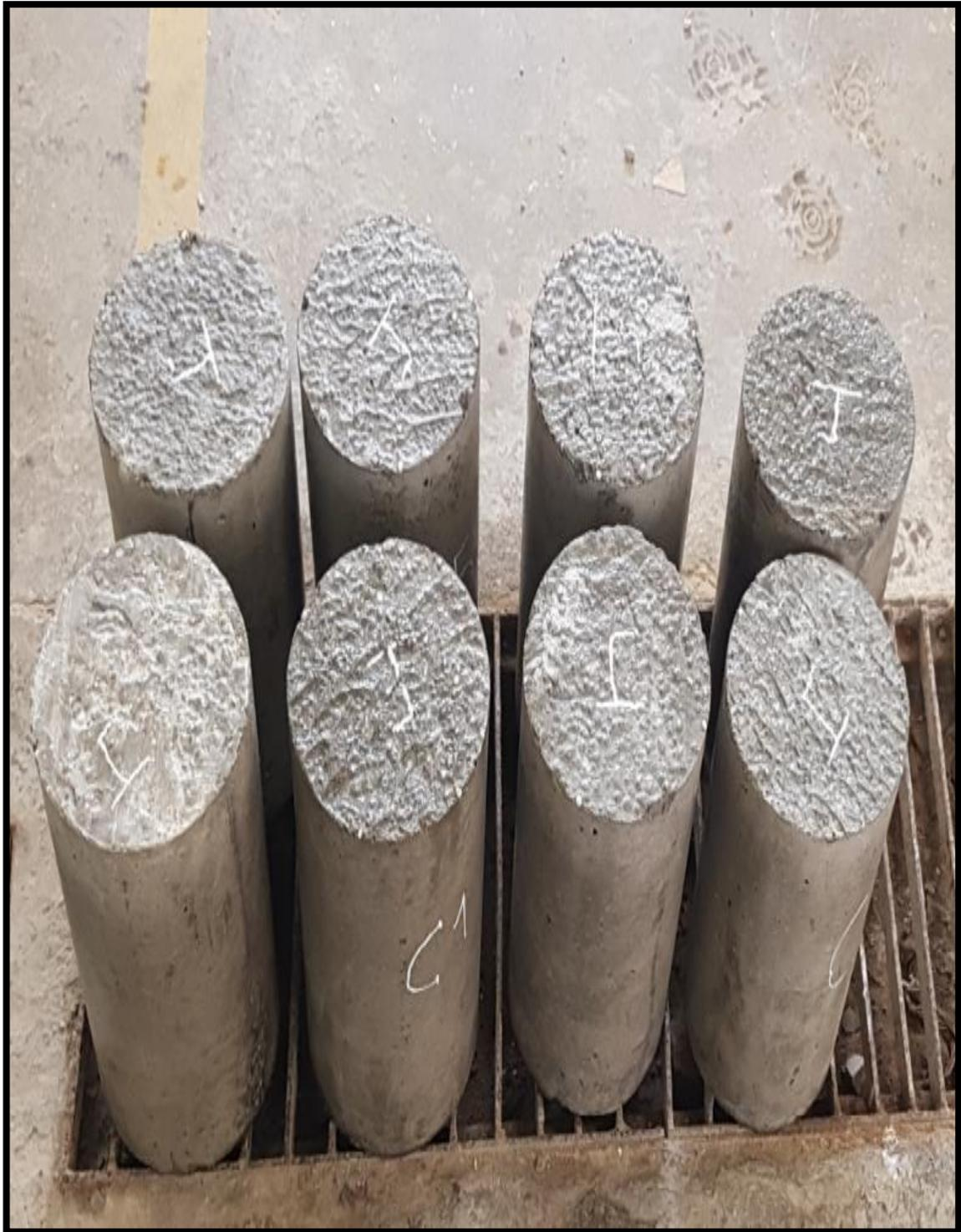
*Figura 19. Secado de probetas de concreto con perlas de poliestireno.*
