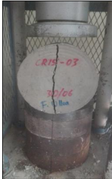
Figura 5.25. Rotura de probeta con 15% de relave
