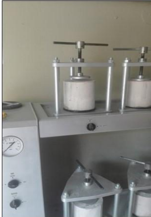
Figura 5.21. Ensayo de penetración de agua bajo presión (Permeabilidad)
