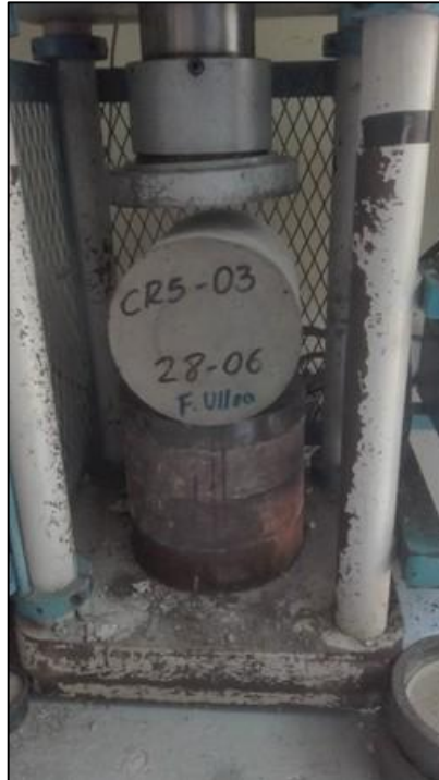
Figura 5.23. Rotura de probeta con 5% de relave
