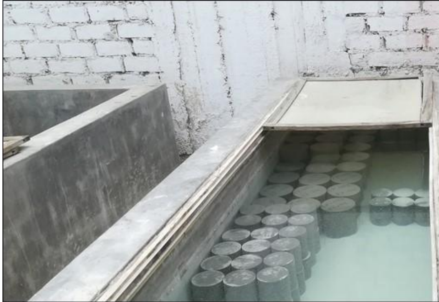
Figura 5.17. Curado de Probetas de Concreto
