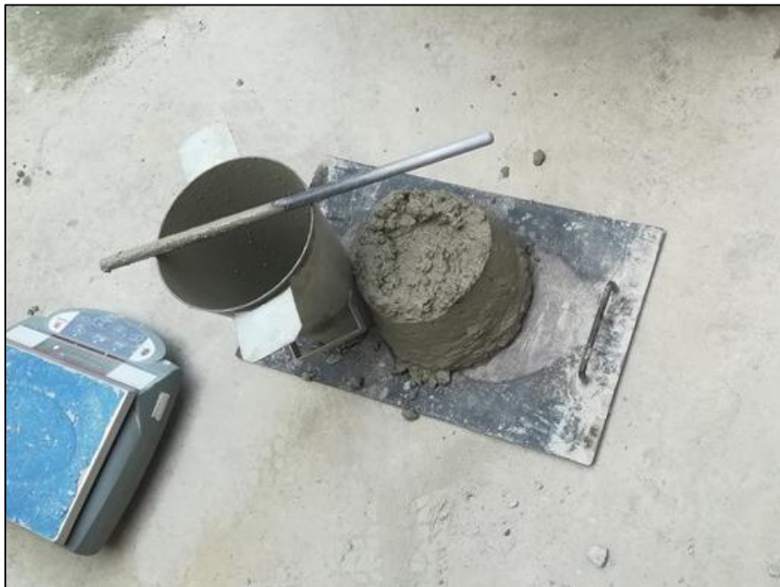
Figura 5.12. Medida del Asentamiento (Slump) del Concreto en Estado Fresco
