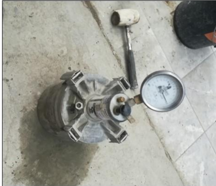
Figura 5.15. Medida del Contenido de Aire del Concreto en Estado Fresco
