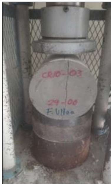
Figura 5.24. Rotura de probeta con 10% de relave
