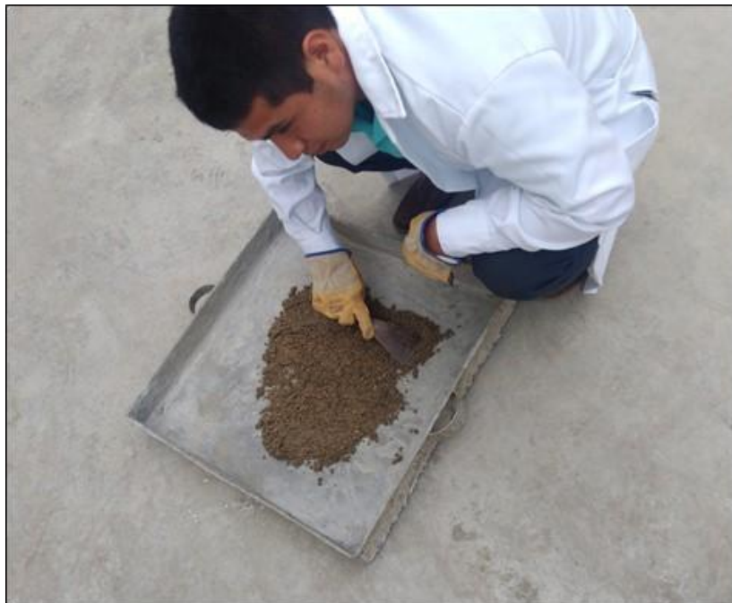
Figura 5.6. Muestra del Agregado Fino para determinar el peso específico
