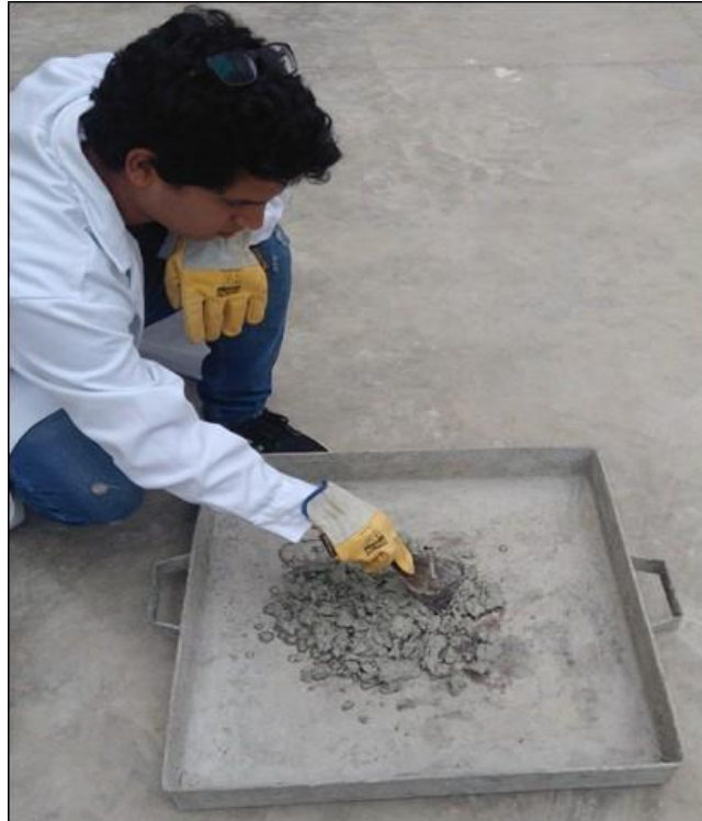
Figura 5.7. Muestra del Relave Minero para determinar el peso específico
