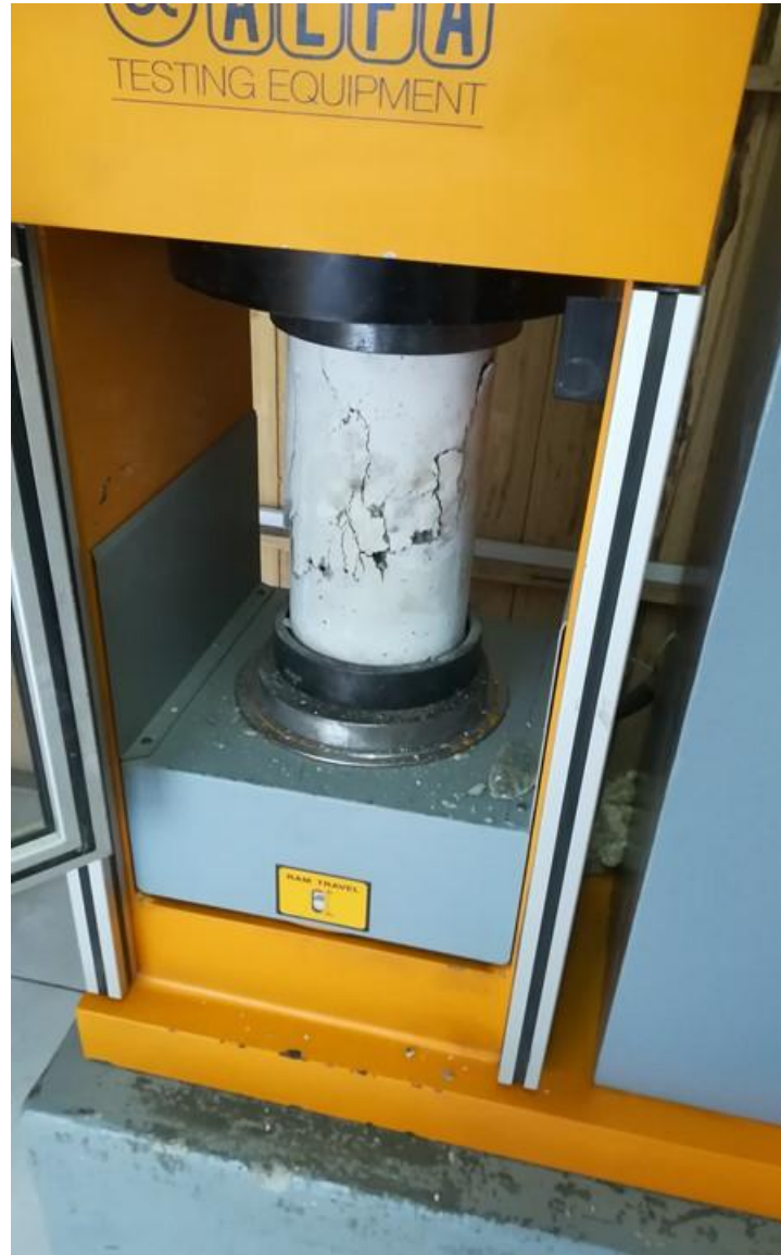
Figura 5.20. Ensayo a la Compresión de Probetas
