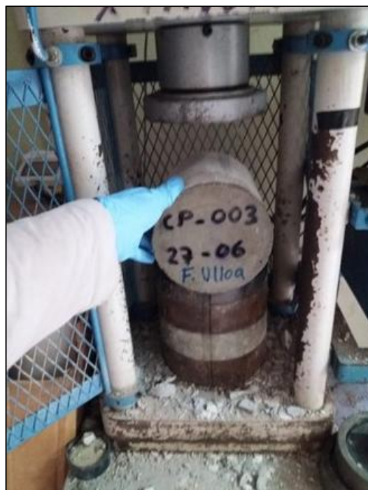
Figura 5.22. Rotura de probeta patrón
