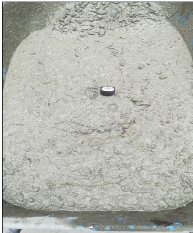
Figura 5.14. Medida de la Temperatura del Concreto en Estado Fresco
