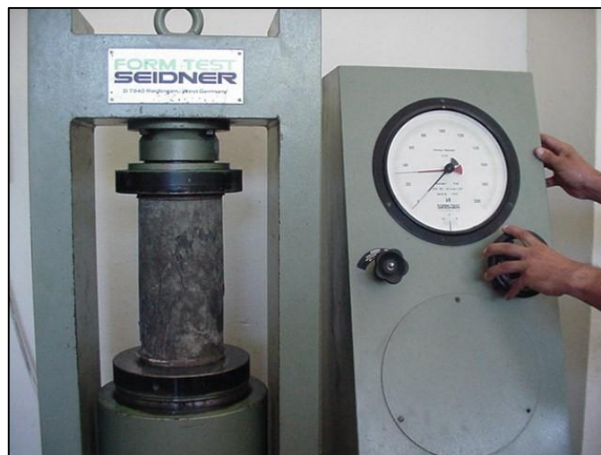
Figura 2.1. Ensayo de Resistencia a Compresión del Concreto.
