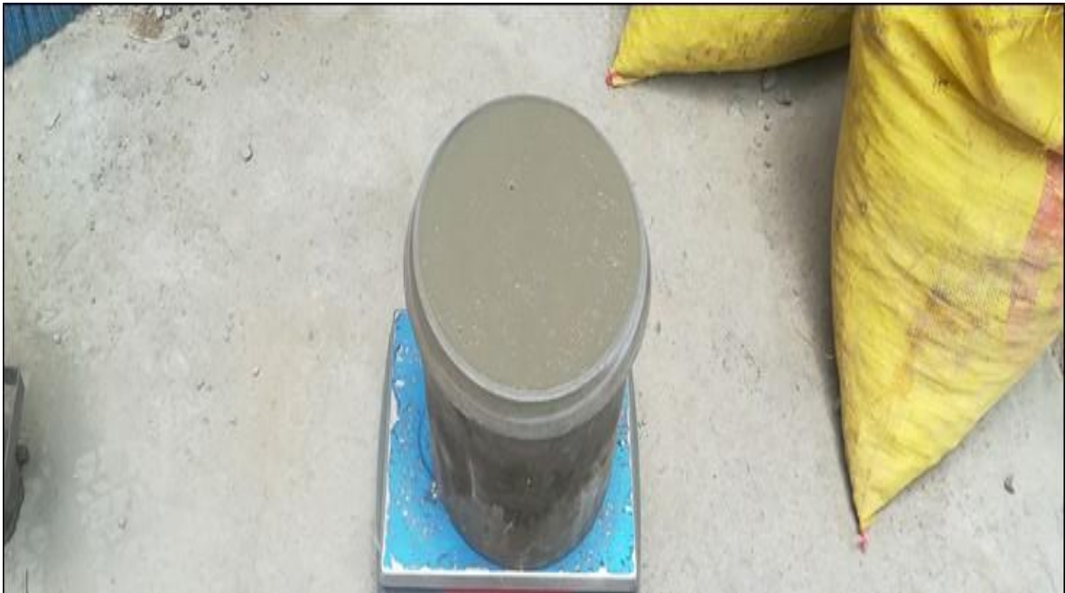
Figura 5.13 Medida del Peso Unitario del Concreto en Estado Fresco
