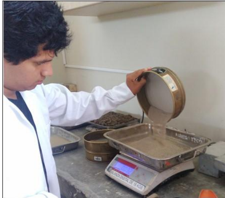
Figura 5.9. Peso del Agregado Fino Tamizado
