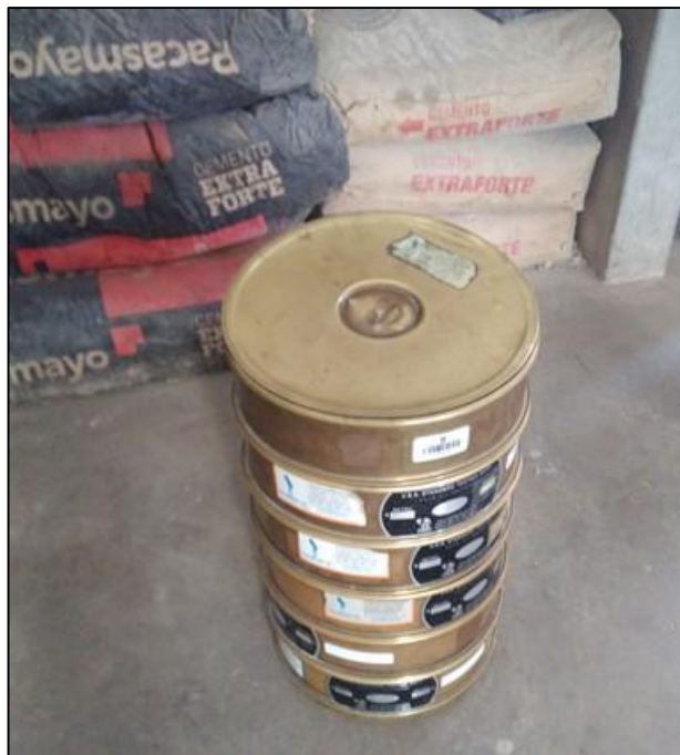
Figura 5.8. Tamizado para estimación de tamaños de los agregados
