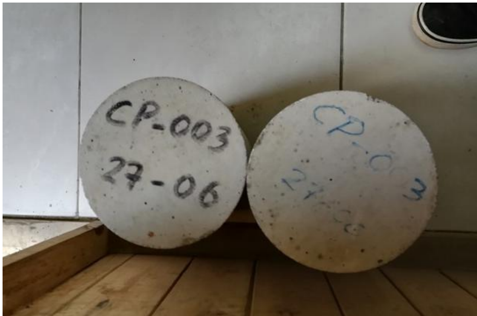
Figura 5.18. Probetas de concreto a ensayar
