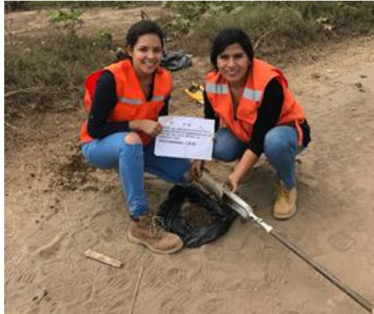
Figura n°. 15: Extracción de muestra de suelo con “Posteadora”
