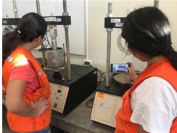
Figura n°. 20: Ensayo de CBR
