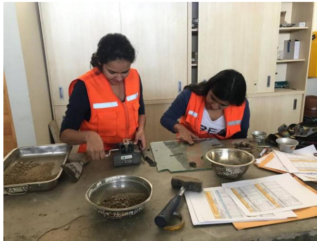
Figura n°. 18: Ensayo de Límite Líquido y Límite Plástico
