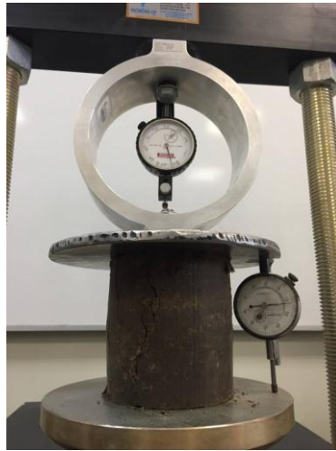
Figura n°. 21: Ensayo de Compresión Simple no confinada.
