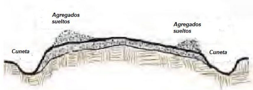
Figura n°. 12: Pérdida de agregados
