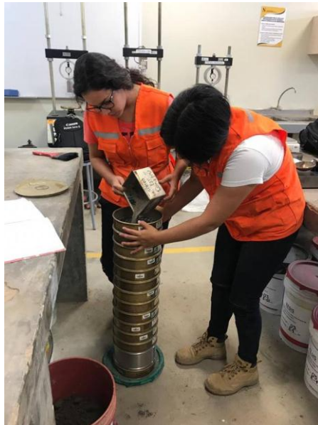
Figura n°. 17: Ensayo de granulometría por tamizado
