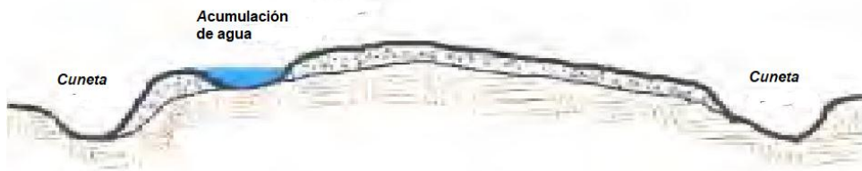
Figura n°. 6: Sección transversal impropia
