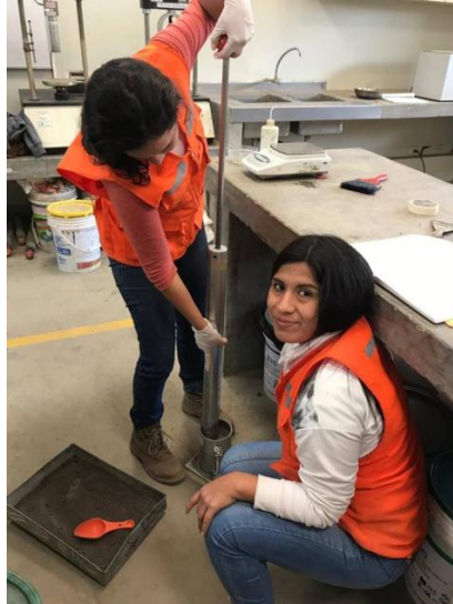
Figura n°. 19: Ensayo de Proctor Modificado
