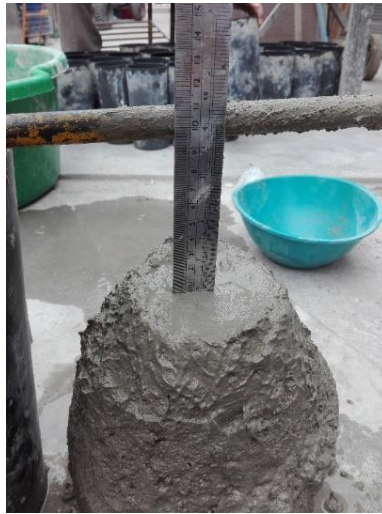
Figura 28: Ensayo de Slump o consistencia.
