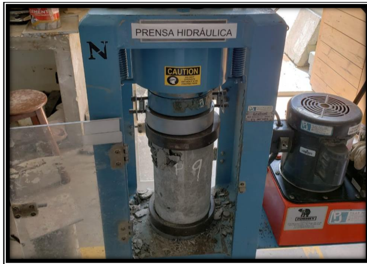
Figura 80. Rotura de especímenes cilíndricas a compresión. Fuente propia
