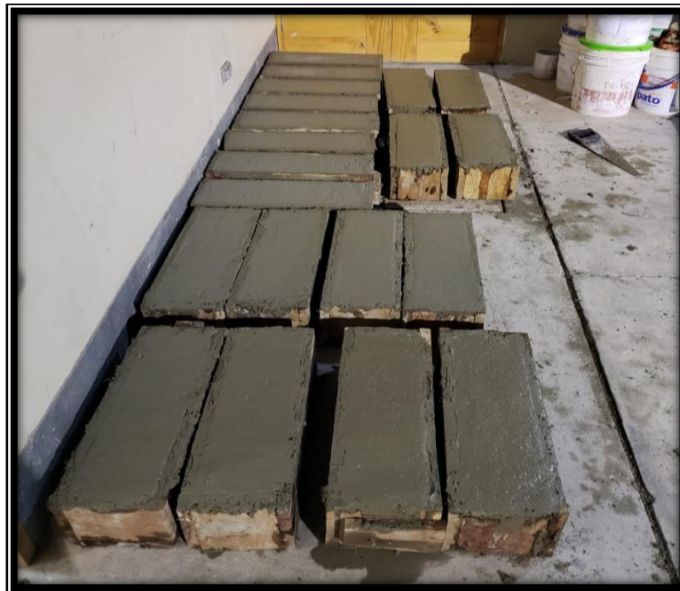
Figura 83. Conformación de las vigas. Fuent: propia
