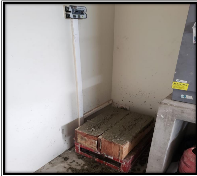
Figura 82. Llenado y vibrado de la mezcla en los moldes de vigas. Fuente propia
