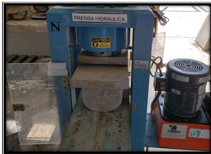
Figura 81. Ensayo a la compresión diametral - Tracción. Fuente propia
