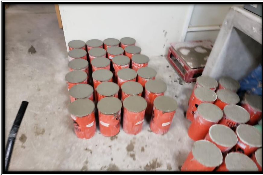
Figura 76. Llenado y vibrado de probetas cilíndricas. Fuente Propia
