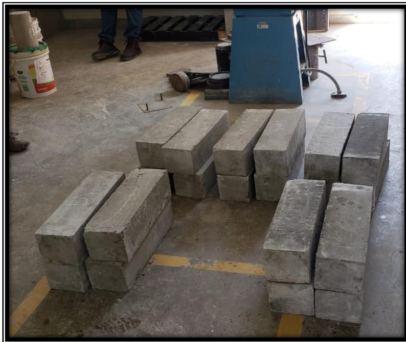
Figura 85. Secado de vigas para posterior rotura. Fuente propia
