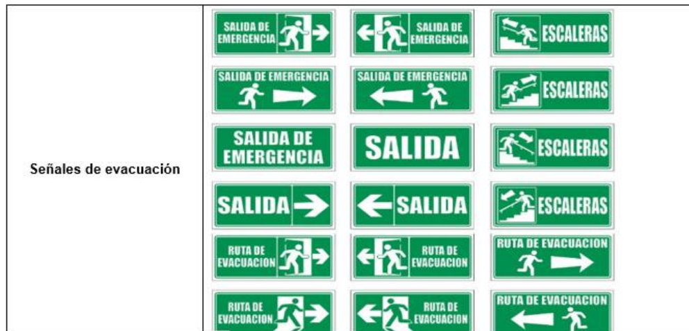
Figura 13: Señales de evacuación
