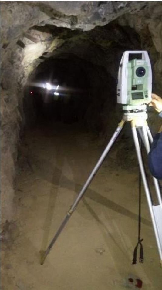
Foto 5. Cartografiado en interior del nivel 4, Mina Paredones.
