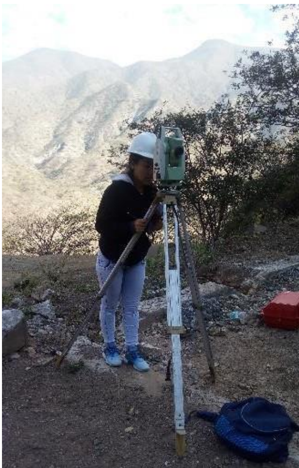
Foto 2. Medición cartográfica con estación total.
