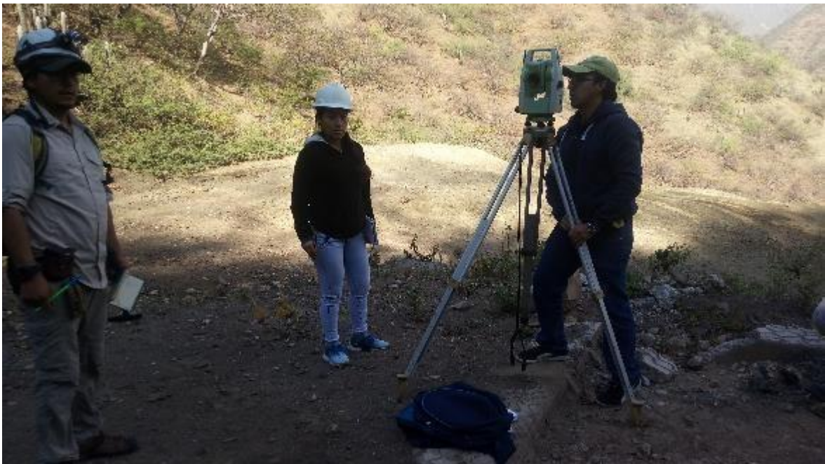
Foto 1. Ubicación y Montaje de la Estación total a la entrada del nivel 2. Mina Paredones.
