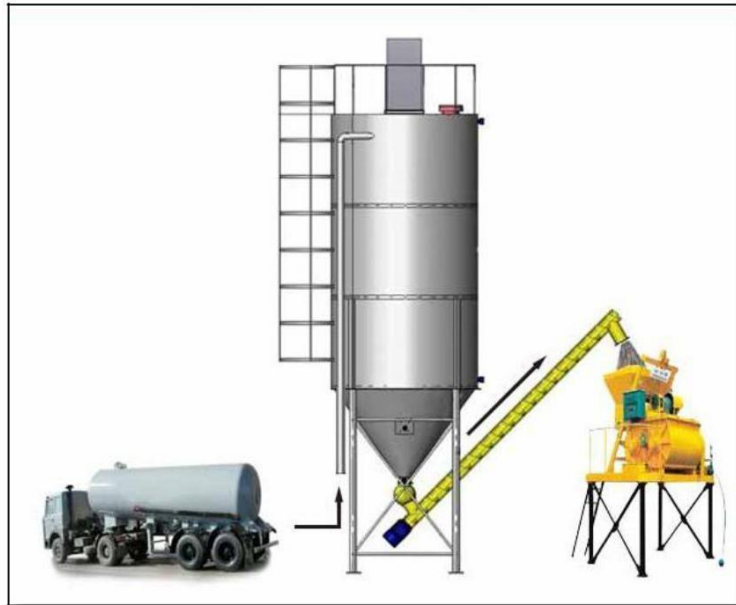
Figura N° 27 Implementación del Silo
