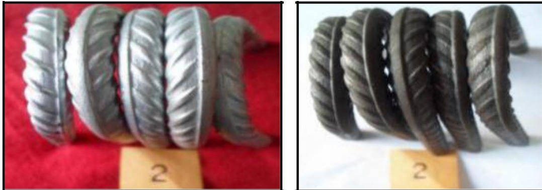
Figura n.º 48. Muestras barras corrugas Ø 3/8" galvanizada y en calidad comercial negra dobladas, ambas dobladas 180°, series 2G y 2N (Siderperú).
