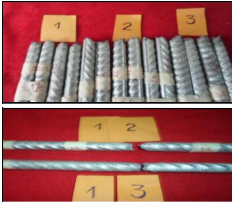
Figura n.º 55. Muestras galvanizadas con fractura dúctil.
