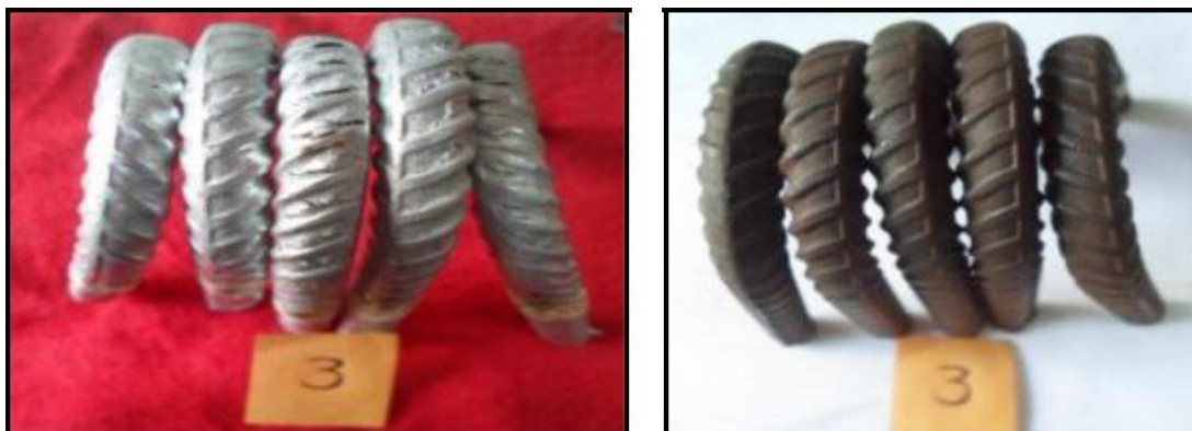
Figura n.º 49. Muestras barras corrugas Ø 3/8" galvanizada y en calidad comercial negra dobladas, ambas dobladas 180°, serie 3G y 3N (Belgo 60).
