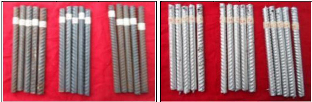
Figura n.º 46. 15 barras corrugada \varnothing 3/8" x 170 mm en calidad comercial negro y 15 barras corrugada \varnothing 3/8" x 170 mm galvanizados.
