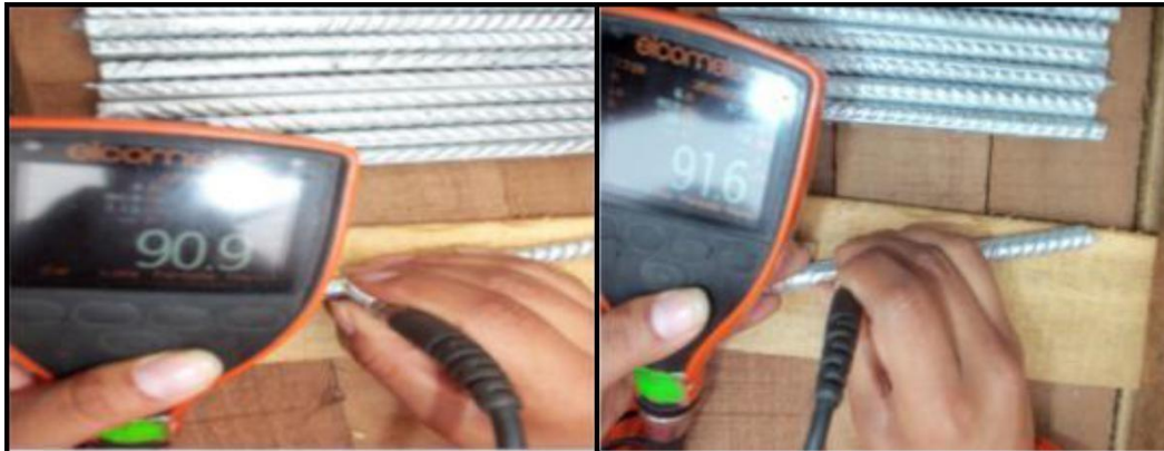
Figura n.º 37. Medición de espesores de zinc en Barra corrugada galvanizada Ø 3/8” x 170 mm.
