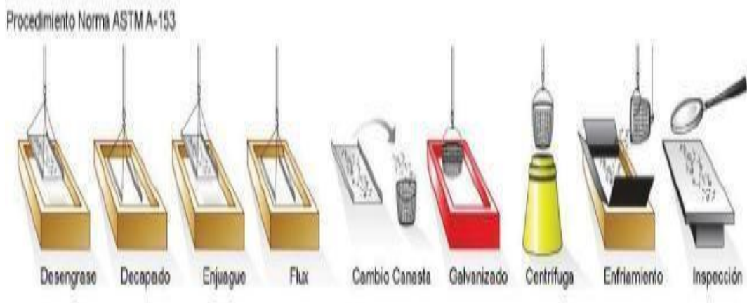
Figura n.º 15. Proceso de Galvanizado por inmersión en caliente (norma ASTM A-153).
