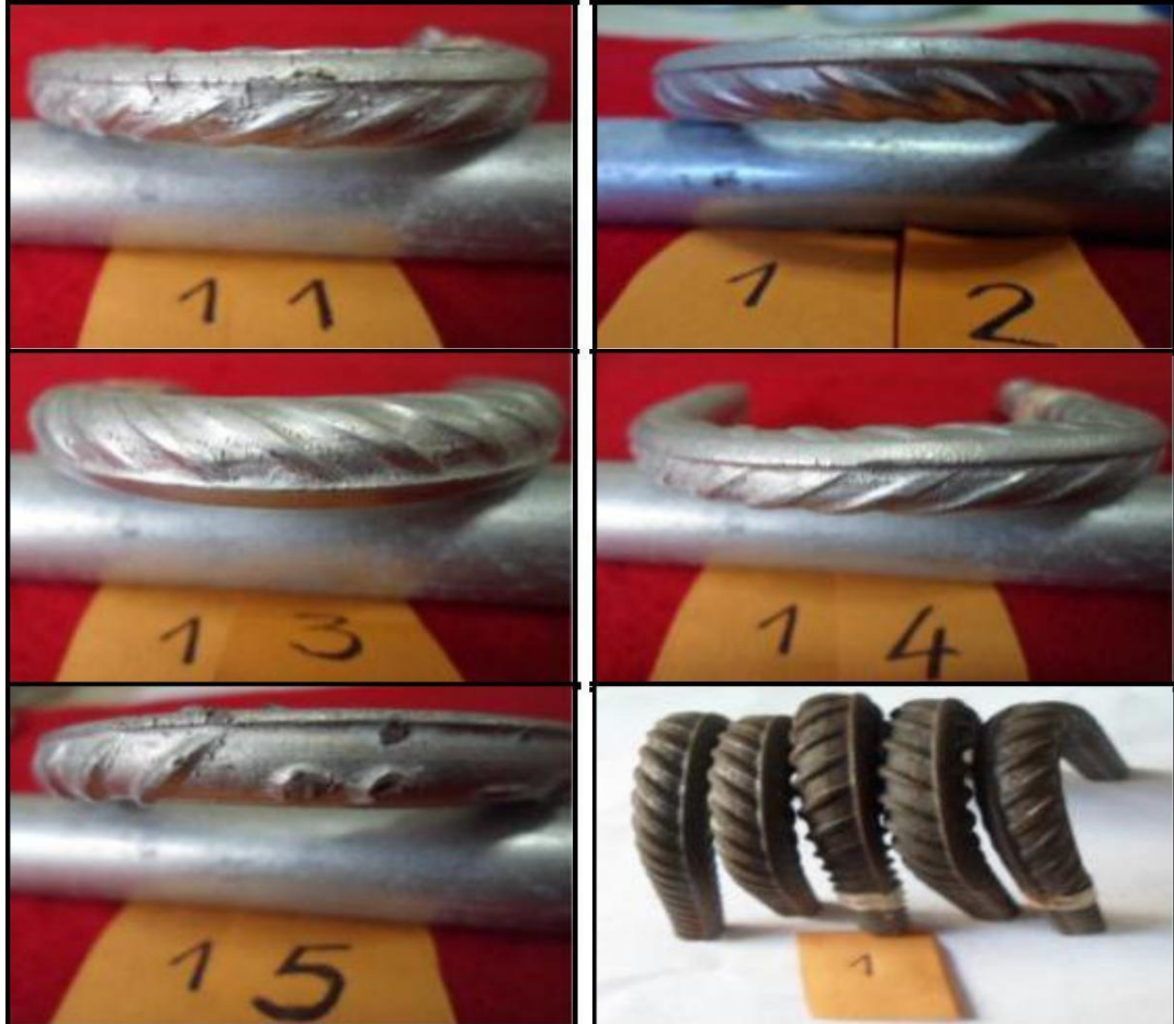
Figura n.º 47. Muestras barras corrugas \varnothing 3/8 " galvanizada y en calidad comercial negra, ambas dobladas 180^\circ , serie 1G y 1N (Acero Arequipa).
