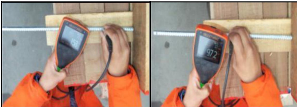
Figura n.º 36. Medición de espesores de zinc en barra corrugada galvanizada \varnothing 3/8" x 390 mm.
