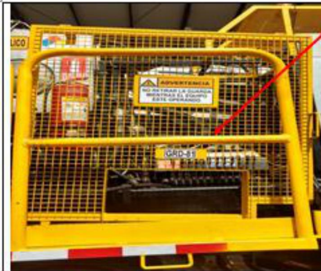
GRD 81 Guarda de acceso a bombas hidráulicas y lateral del panel control
