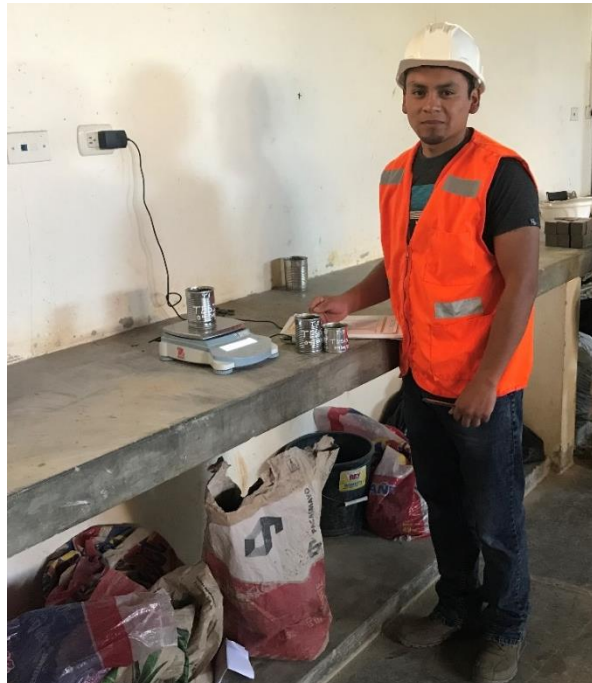
Fotografía N° 4. Pesado de muestras – contenido de humedad.
