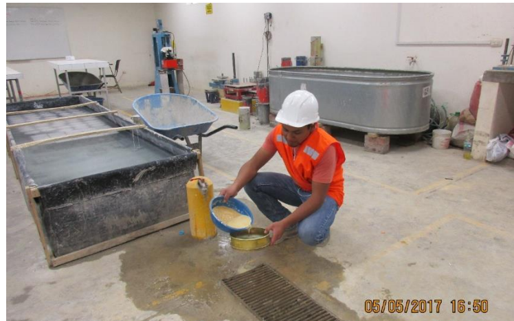
Figura 7. Análisis granulométrico (tamizado por lavado).
