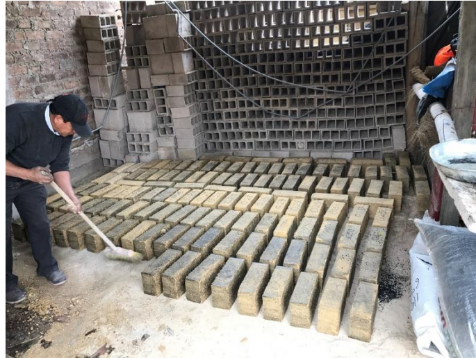
Figura 14. Secado de adobes compactados.
