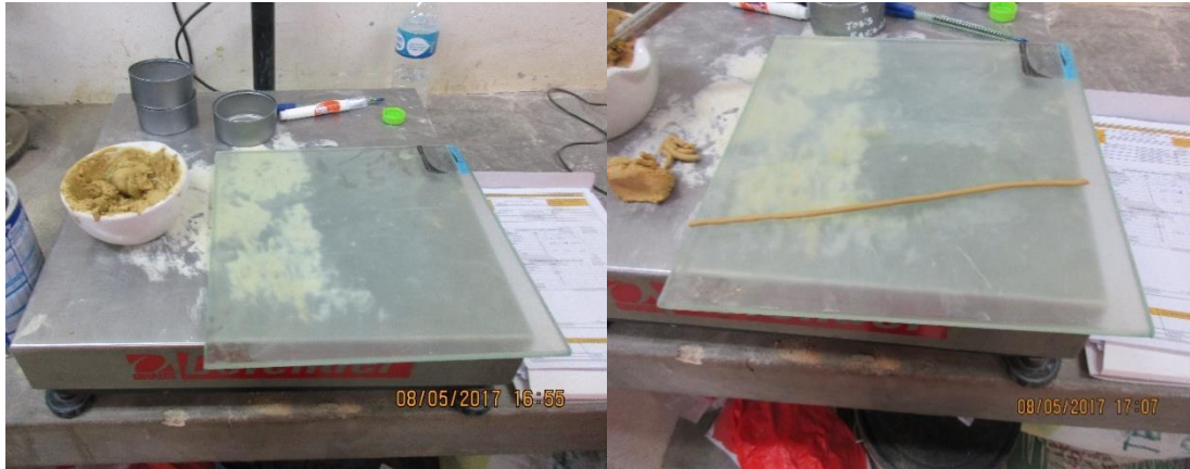
Figura 9. Limite plástico (materiales y equipos).
