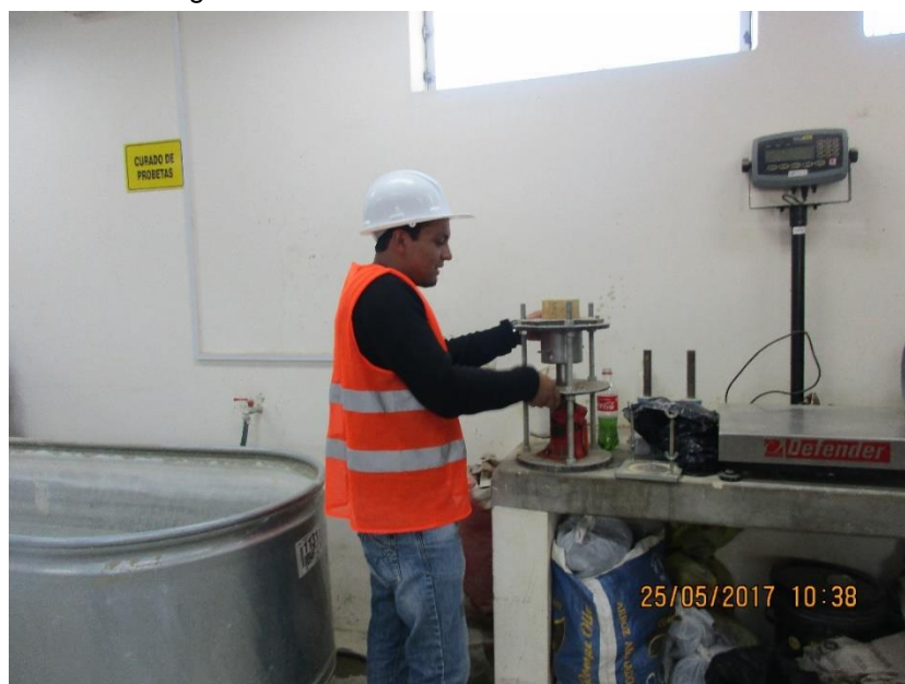
Fotografía N° 10. Desmote de Próctor modificado.
