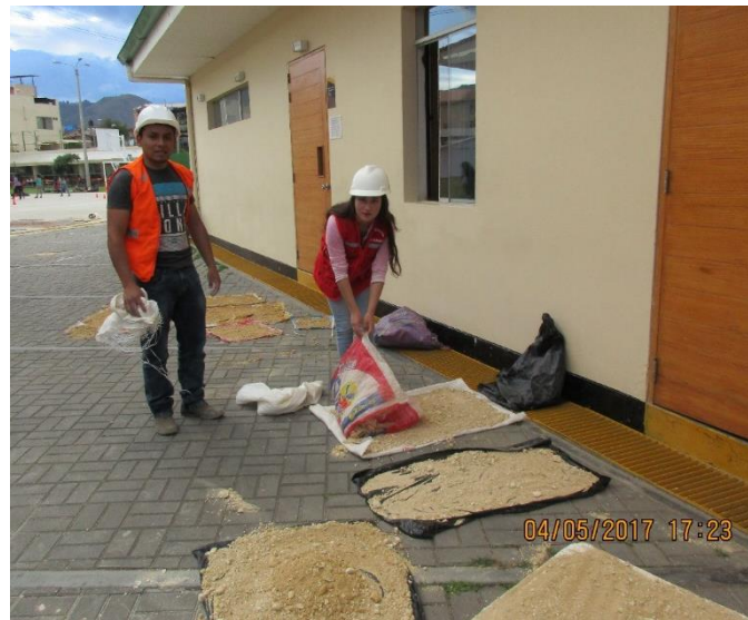
Figura 5. Análisis granulométrico (secado de material).
