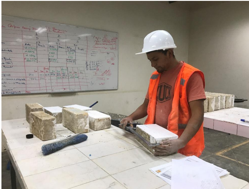
Fotografía N° 17. Medición de los especímenes.
