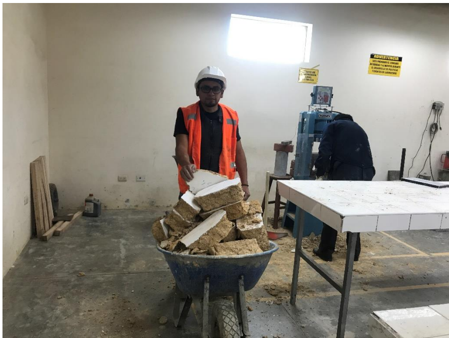
Fotografía N° 20. Especímenes después de ensayo a compresión
