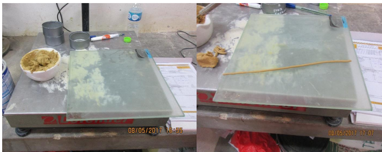
Fotografía N° 12. Materiales y equipo – límite plástico.
