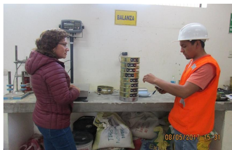
Figura 6. Análisis granulométrico (tamizado en seco - visita de asesor
