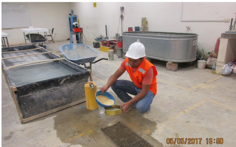
Fotografía N° 8. Tamizado por lavado – análisis granulométrico.
