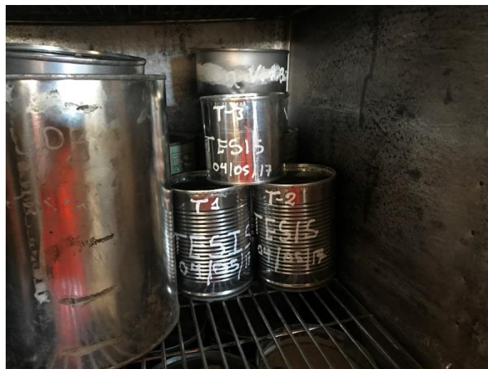
Figura 4. Contenido de humedad (muestra en el horno durante 24 horas)
