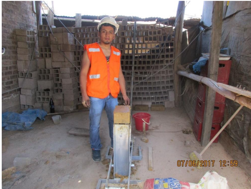
Fotografía N° 15. Elaboración de adobes con la maquina CINVA RAM.
