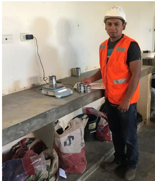
Figura 3. Contenido de humedad (pesado de muestra)
