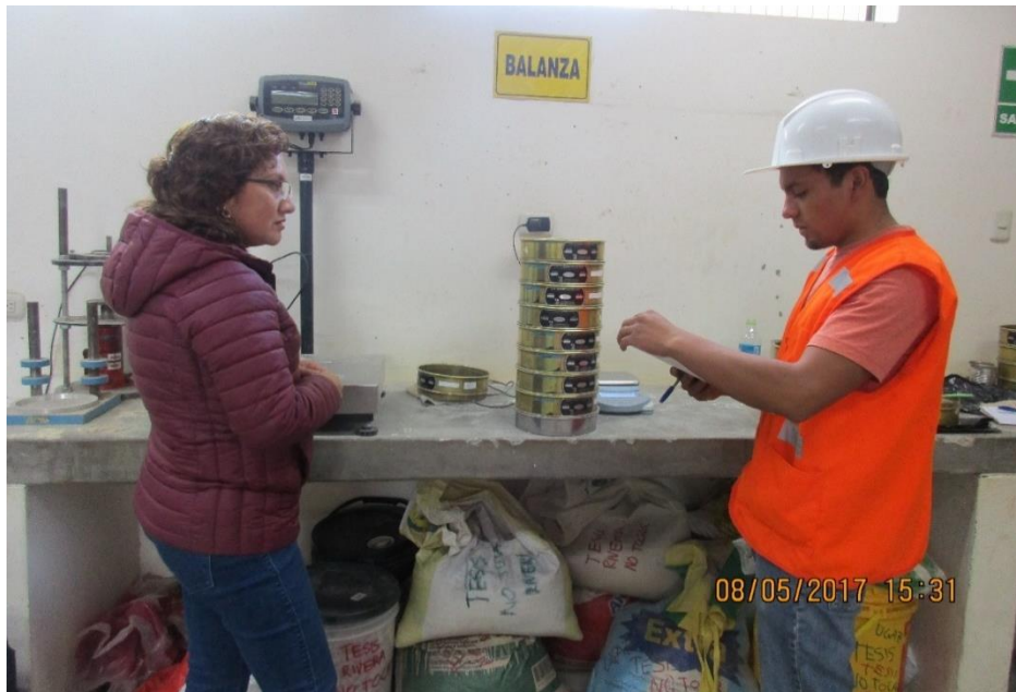
Fotografía N° 7. Tamizado en seco con la supervisión del asesor – análisis granulométrico.
