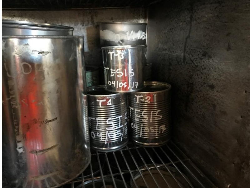
Fotografía N° 5. Puesta de muestras en horno durante 24 horas – contenido de humedad.
