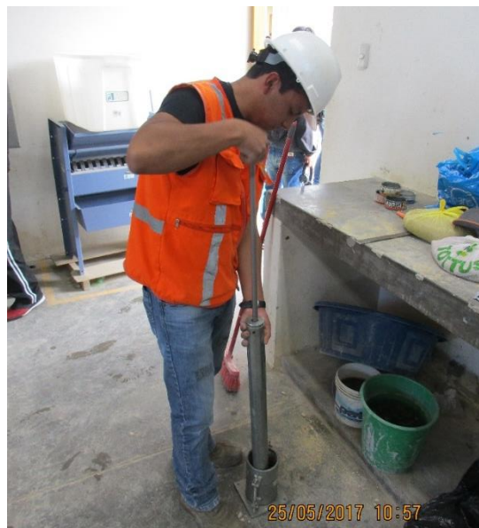
Figura 11. Ensayo de Próctor modificado.
