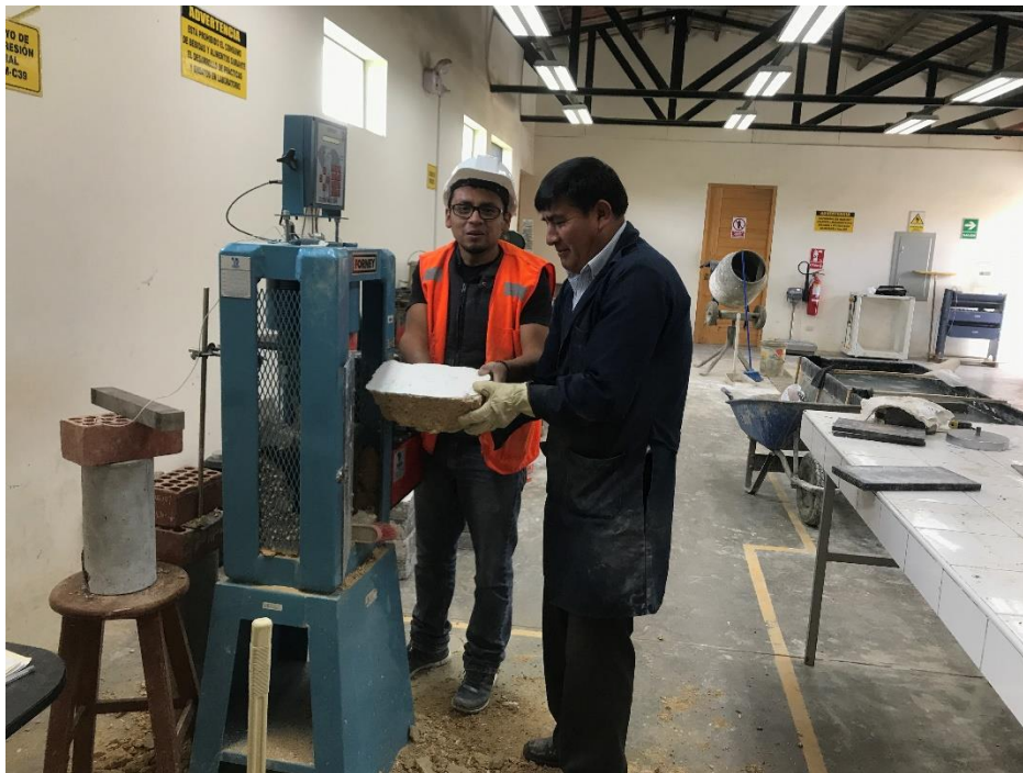
Fotografía N° 18. Ensayo a compresión de los especímenes.
