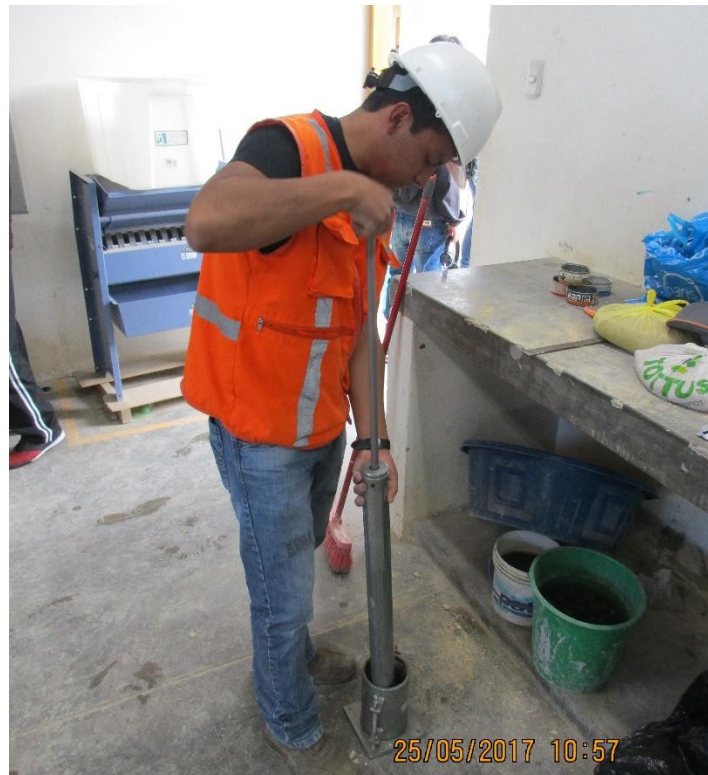
Fotografía N° 9. Ensayo de Próctor modificado.
