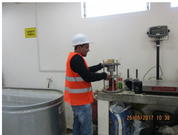
Figura 12. Desmontaje de Próctor modificado.
