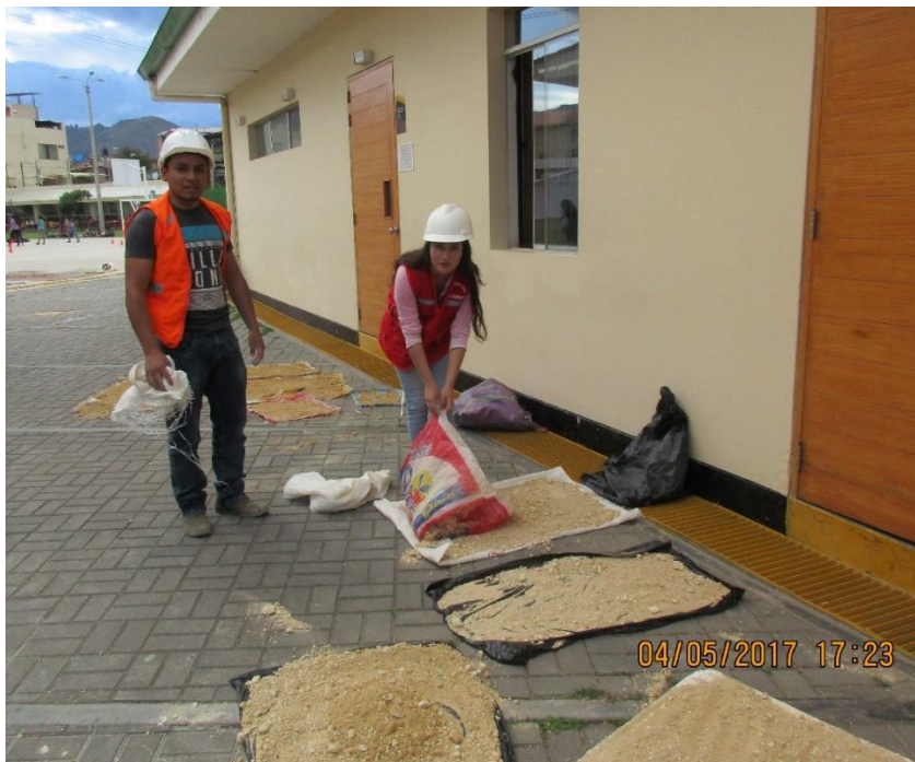
Fotografía N° 6. Secado de material – Análisis granulométrico.
