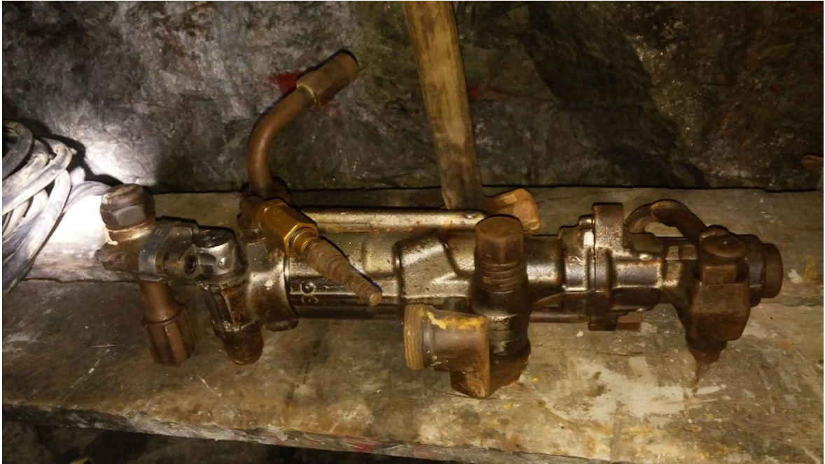
Fotografía 3. Perforación del frente con la máquina Jackleg
