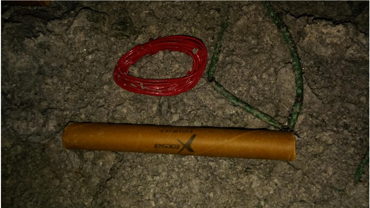
Fotografía 5. Ensamblaje de Carmex con explosivo Emulnor 5000
