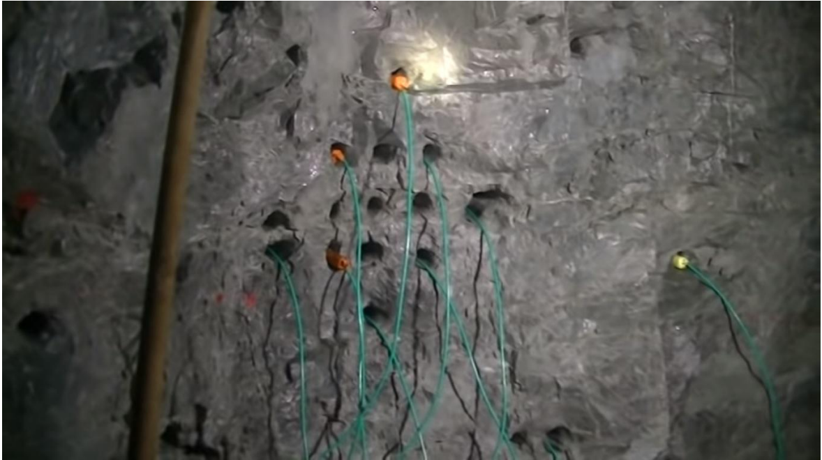
Fotografía 9. Enganche de Carmex a la mecha rápida de acuerdo a la secuencia de detonación
