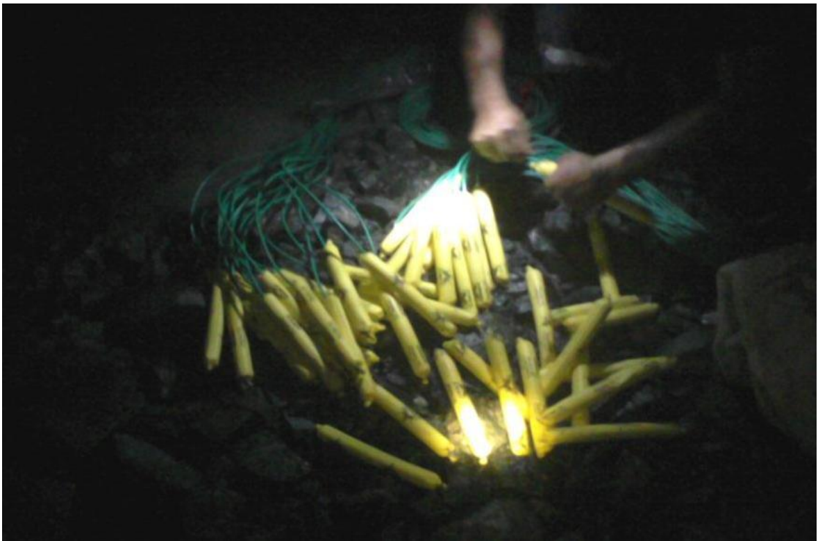
Fotografía 5. Ensamblaje de Carmex con explosivo Emulnor 5000
