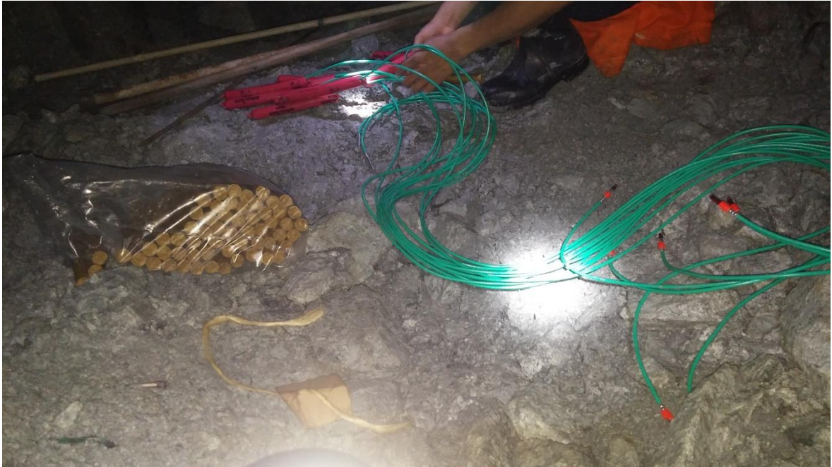
Fotografía 7. Introducción de los explosivos al taladro con atacador
