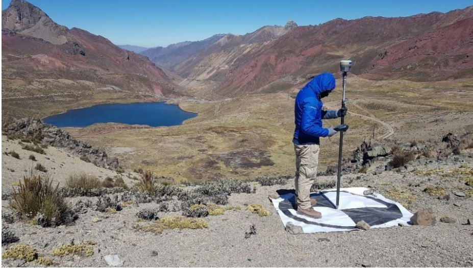
Figura 12. Punto de apoyo fotogramétrico GCP. Fuente: Propia
