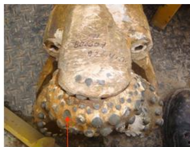
Figura 12: Desgaste de la Broca E 71 806607 – 926.4m, utilizada en la Investigación.
