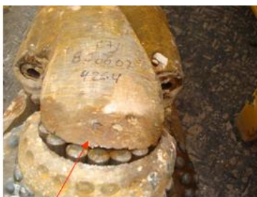
Figura 12: Desgaste de la Broca E 71 806607 – 926.4m, utilizada en la Investigación.
