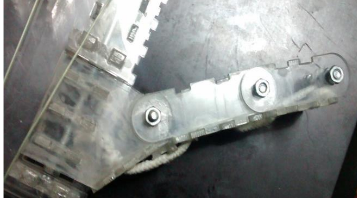
Figura 32. Ensamble del dedo pulgar de la prótesis biomédica.
