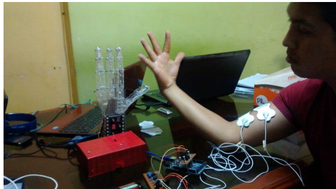
Figura 58. Pruebas de la tarjeta mioeléctrica.
