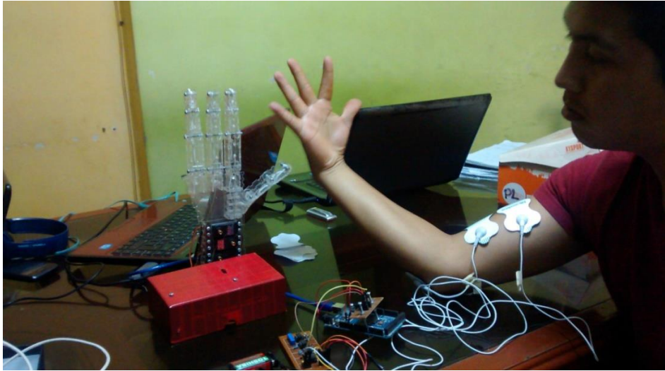
Figura 62. Implementación y pruebas de la prótesis biomédica con el usuario.
