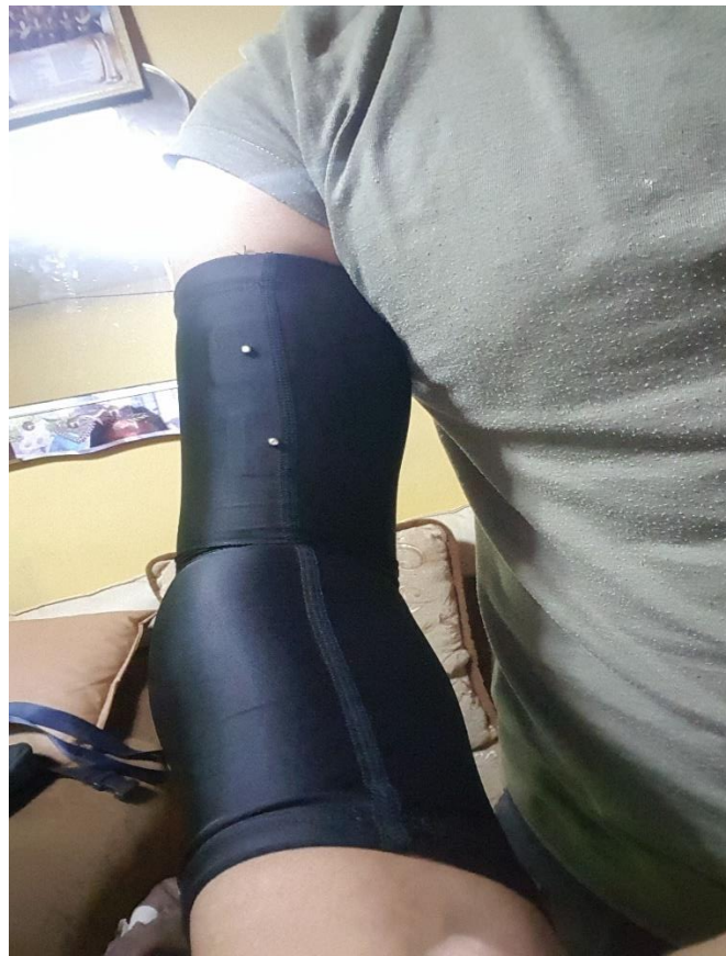
Figura 57. Manga de compresión adaptada para la sujeción de electrodos.
