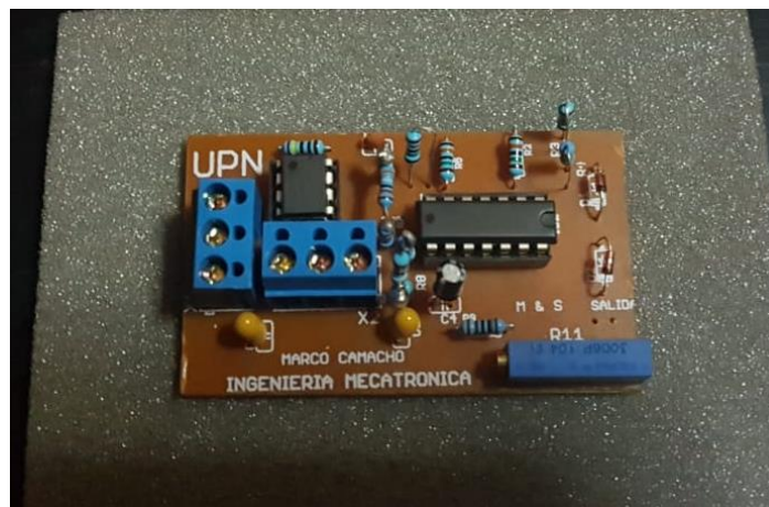
Figura 55. Tarjeta electrónica de señales mioeléctricas.
