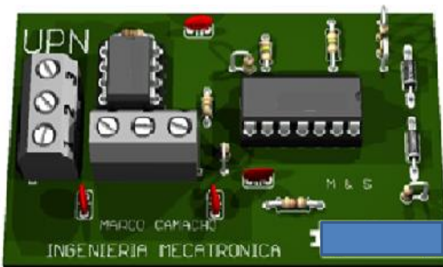
Figura 54. Tarjeta electrónica mioeléctrica en software 3D.
