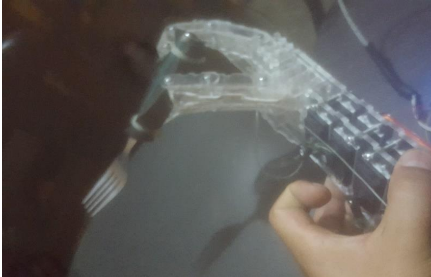
Figura 65. Prótesis biomédica realizando función agarre cubiertos.
