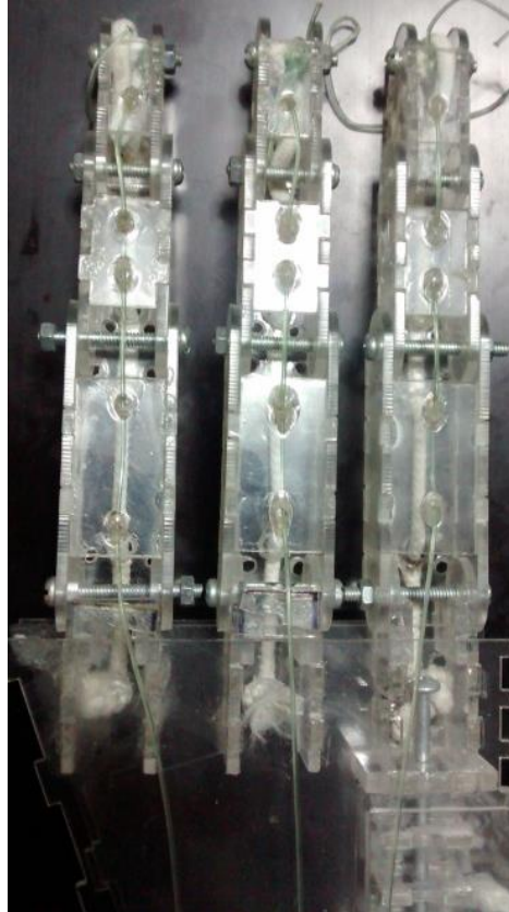
Figura 31. Dedos anular, medio e índice junto con la palma - prótesis biomédica.
