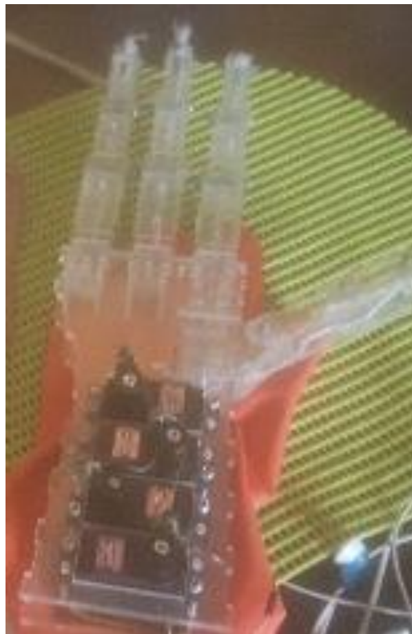
Figura 35. Instalación de actuadores a la prótesis biomédica.
