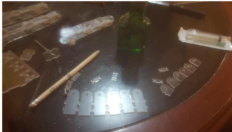
Figura 29. Soldando las piezas de la prótesis biomédica.
