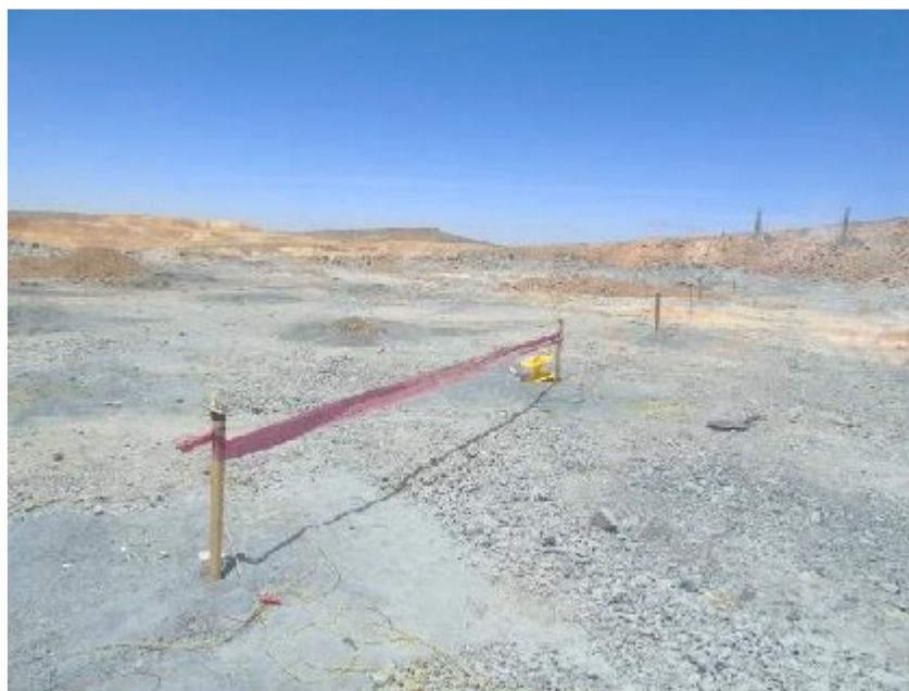
Foto4 Identificación del punto de inicio y taladros tapados con stemming y detritos
